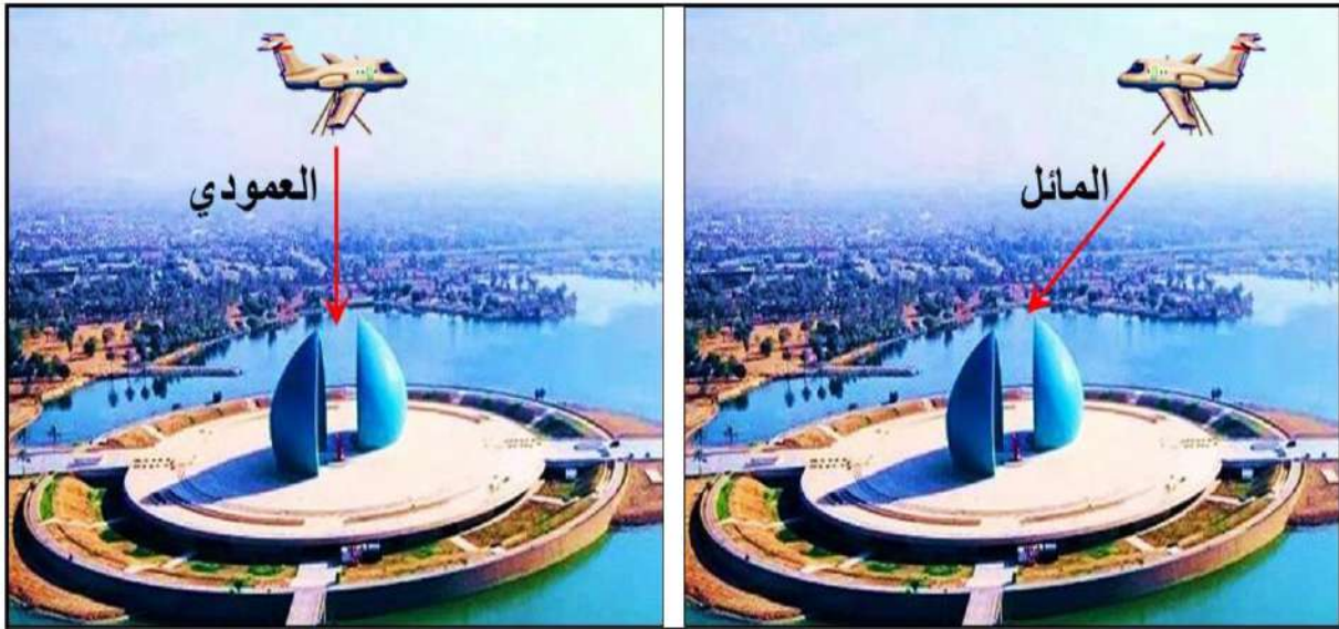
الشكل (4-5) انواع التصوير الجوي العمودي والمائل.
