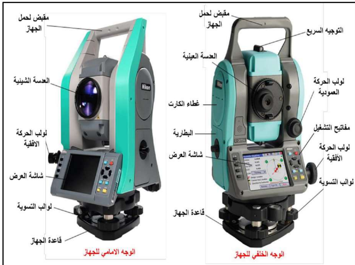
الشكل (1 - 28) اجزاء جهاز المحطة المتكاملة
