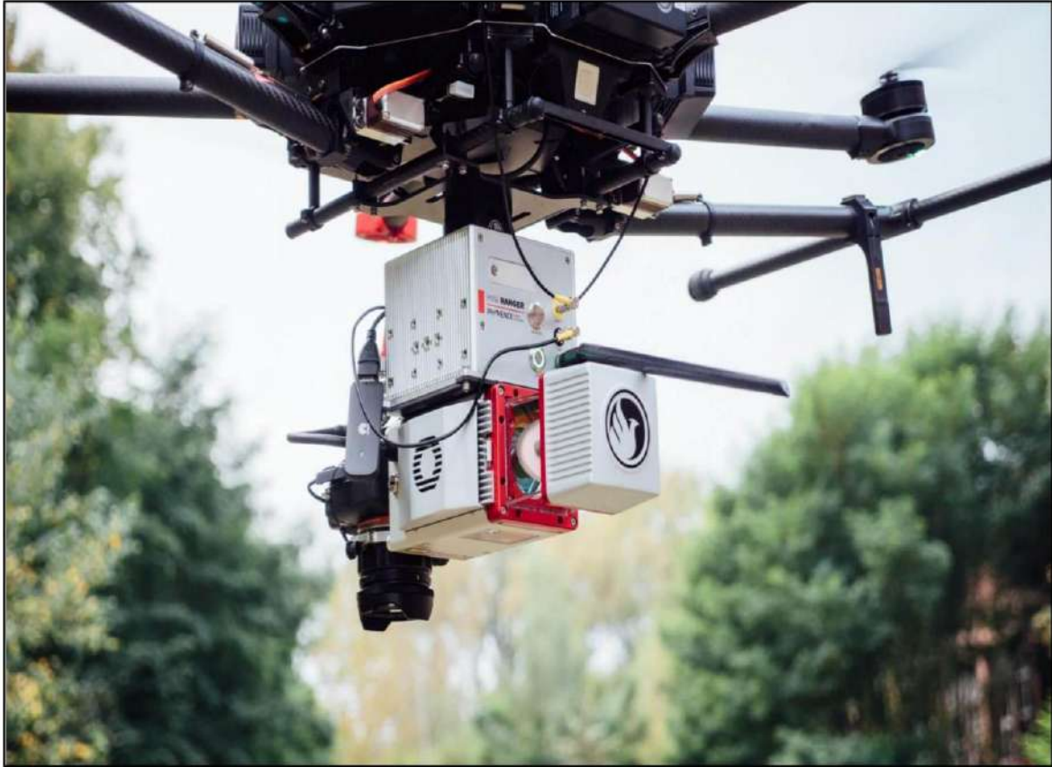
الشكل (4-27) نظام المسح الليزري الجوي او ما يعرف باللايدار Lidar.
