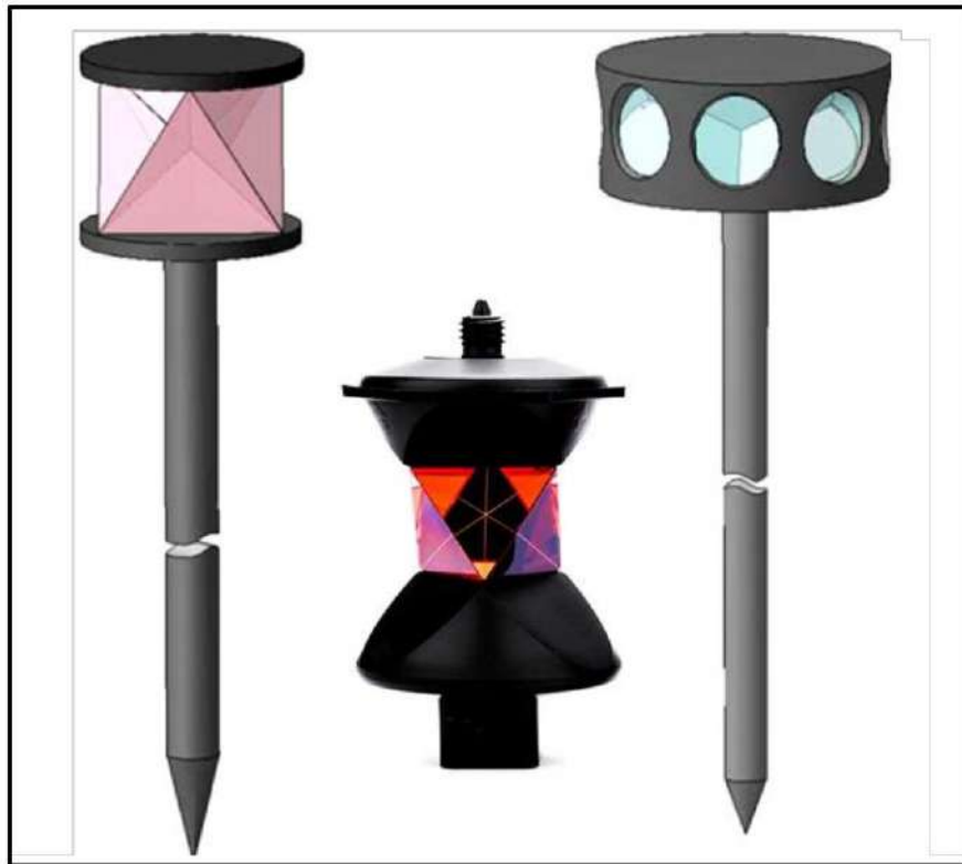
الشكل (1 - 21) انواع من العواكس الدائرية الشكل
