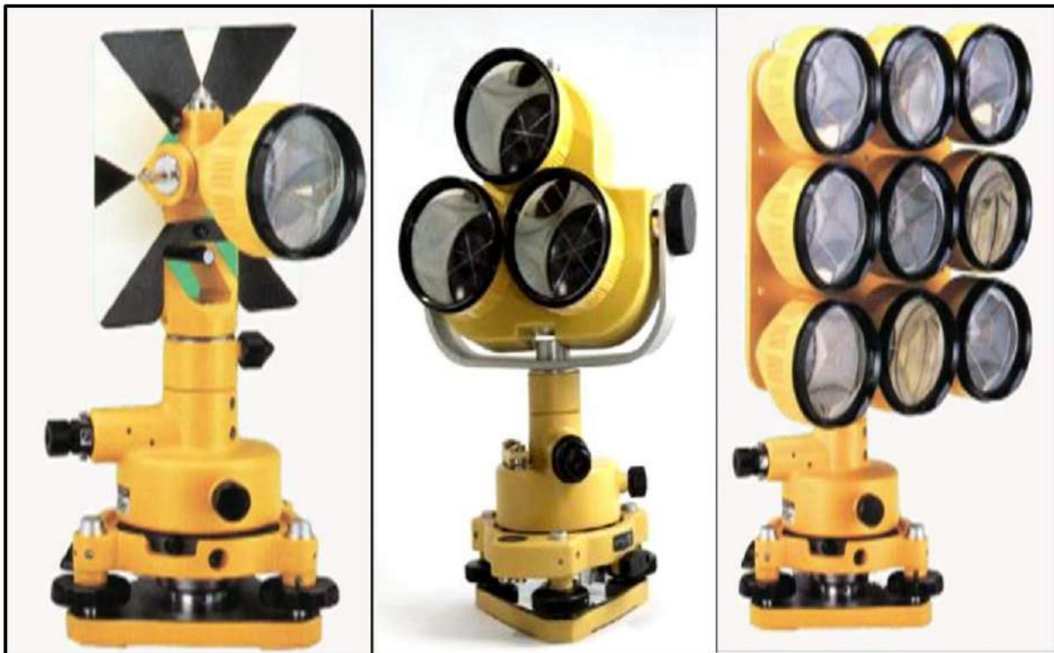
الشكل (1 - 20) انواع العواكس الموشورية الزجاجية
