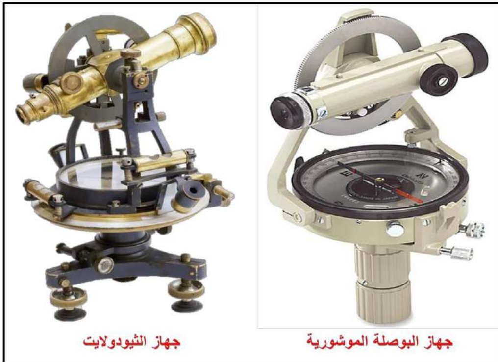
الشكل (1 - 9) أجهزة قياس الزوايا قديماً
