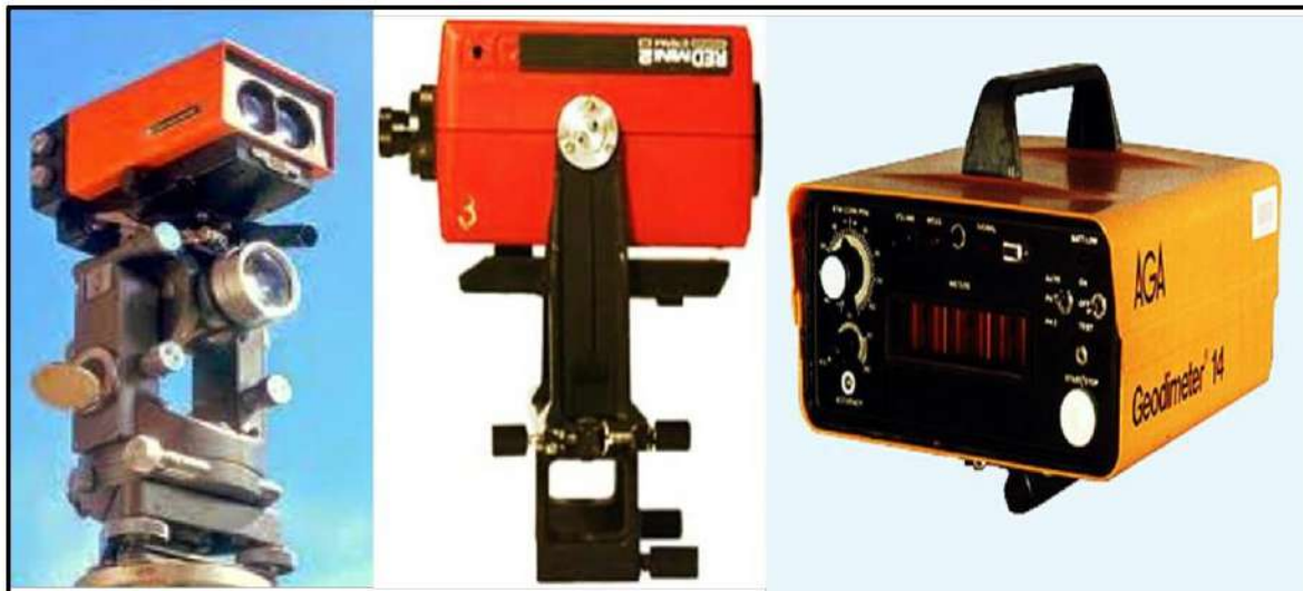
الشكل (1 - 7) أجهزة قياس المسافات المستخدم فيها الاشعة الضوئية
