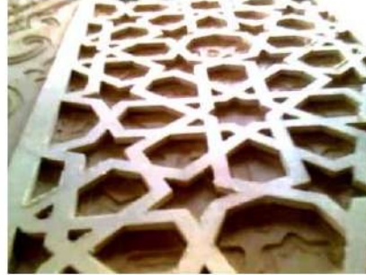
شكل (4 - 5) أعمال التفريغ على ماكينة CNC
