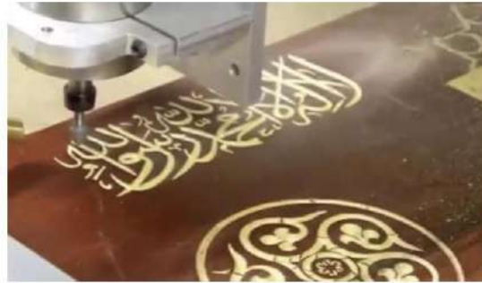
شكل (4 - 6) تنفيذ الكتابة الغائرة على ماكينة CNC
