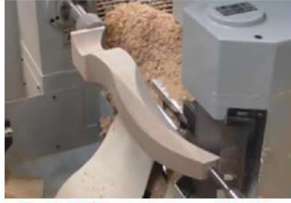
شكل (4 - 8) المخرطة الرقمية ذات الحامل الواحد
