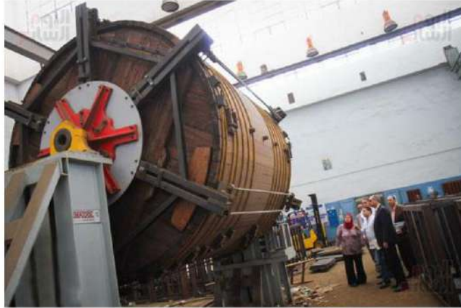
شكل (3 - 17) النواير الخشبية لإزالة الصوف من الجلود في المرحلة الحديثة من الدباغة
