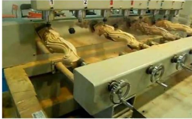
شكل (4 - 9) المخرطة الرقمية ذات الرؤوس المتعددة
