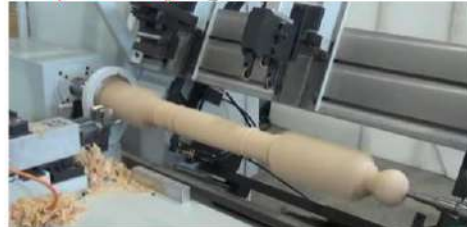
شكل (4 - 7) تنفيذ عصا اسطوانية على المخرطة الرقمية
