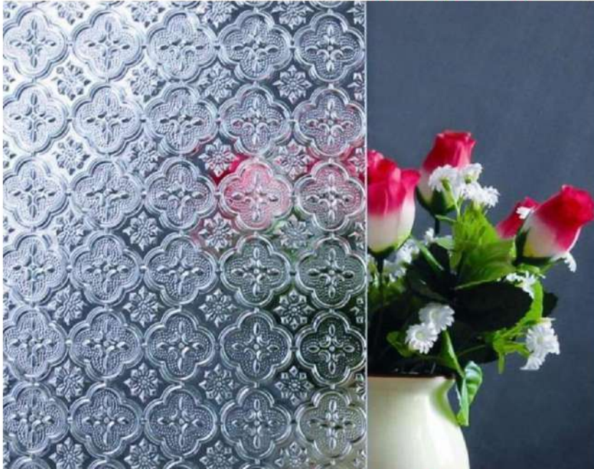
شكل (3 - 8) الزجاج المشجر واستخداماته
