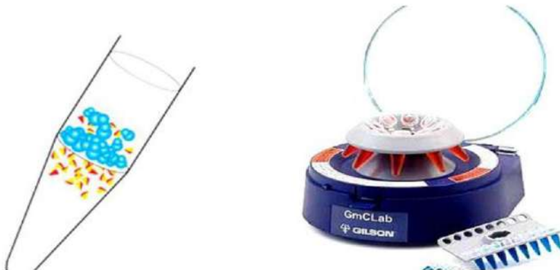
شكل 17 - 8 جهاز الطرد المركزي مع حاويات المحلول. شكل 17 - 9 الانبوبة الحاوية على المحلول بعد تفكيك اجزائه
