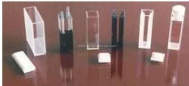
شكل 17-17 يمثل حاوية المحلول المجهول التركيز (Cuvette)
