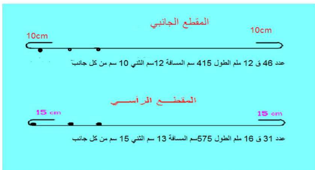
الشكل (10) ثني حديد التسليح وطريقة التوزيع
