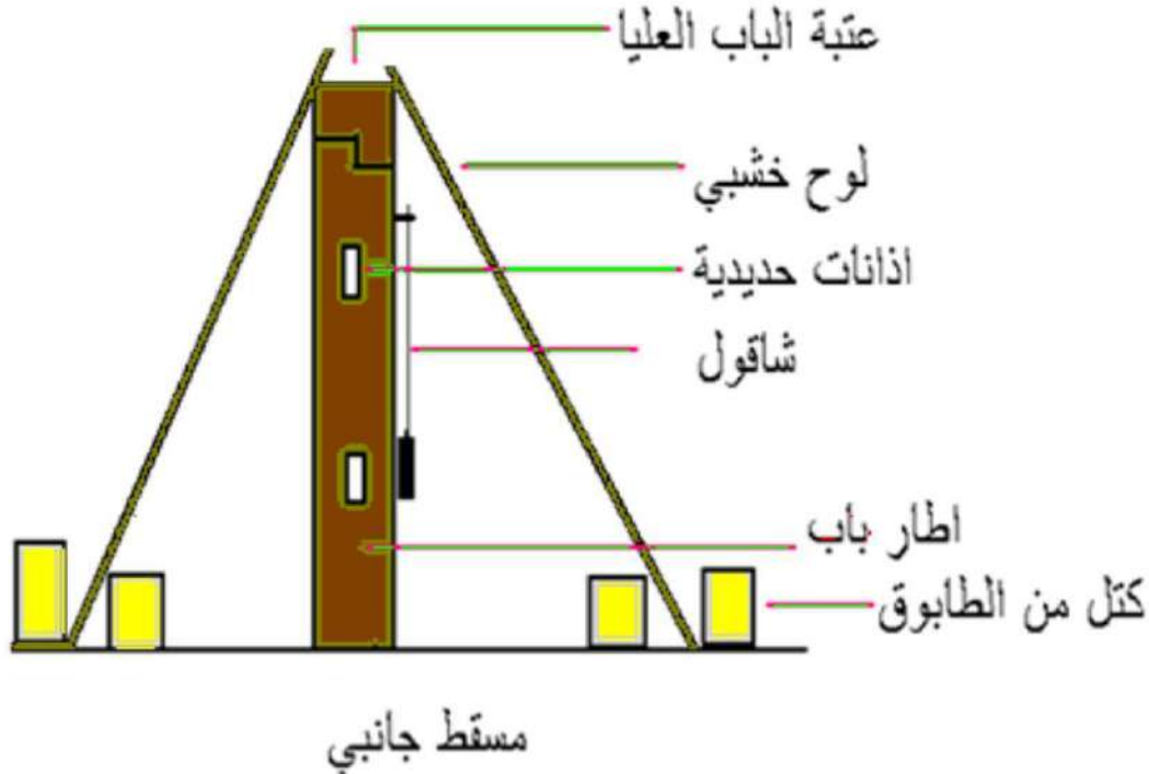
الشكل ( 8 ) طريقة تثبيت الأبواب
