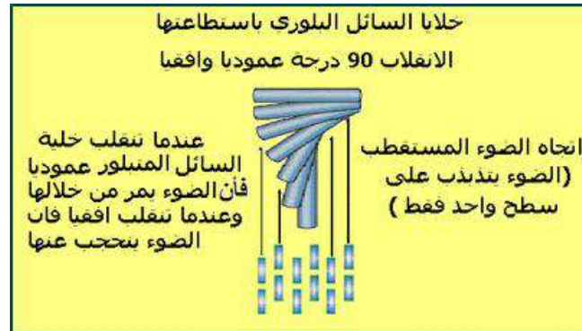
الشكل (3-20) الرسم التوضيحي عن الخلايا البلورية ضمن السائل البلوري
