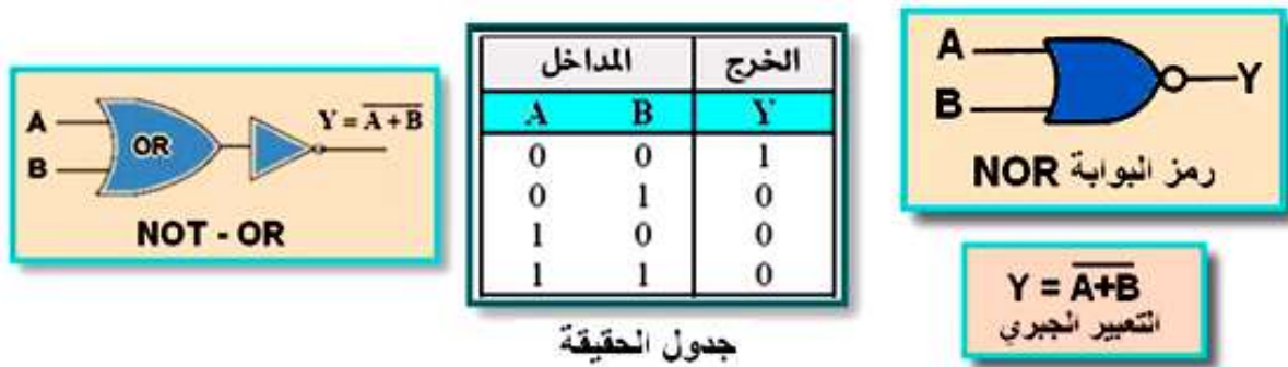
الشكل ( 1 - 16 ) الرمز المنطقي والتعبير الجبري وجدول الحقيقة لبوابة NOR
