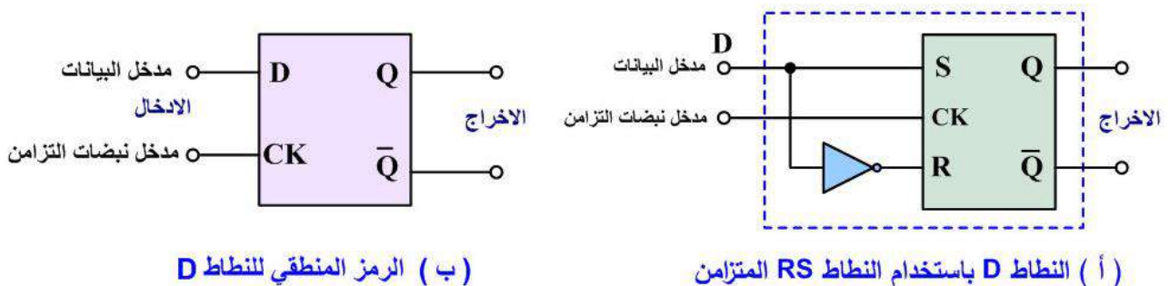
الشكل (1- 31) دائرة النطاق D ورمزه المنطقي
