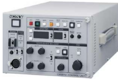
الشكل (7-8) وحدة سيطرة الكاميرات
