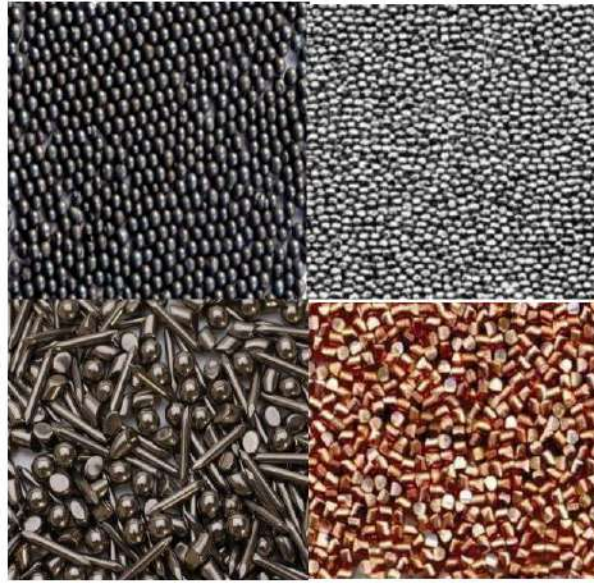
الشكل (4-5) المواد المعدنية المستخدمة بطريقة القذف
