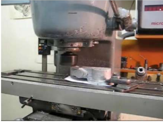
الشكل (16-5) تفريز سطح المسبوكة الشكل (17-5) تجليخ المسبوكة على ماكينة التجليخ
