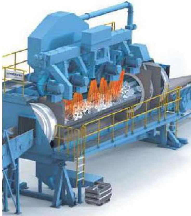
الشكل(5-13) ماكينة تنظيف ذات ريشة لقذف كريات المعدن بدون هواء
