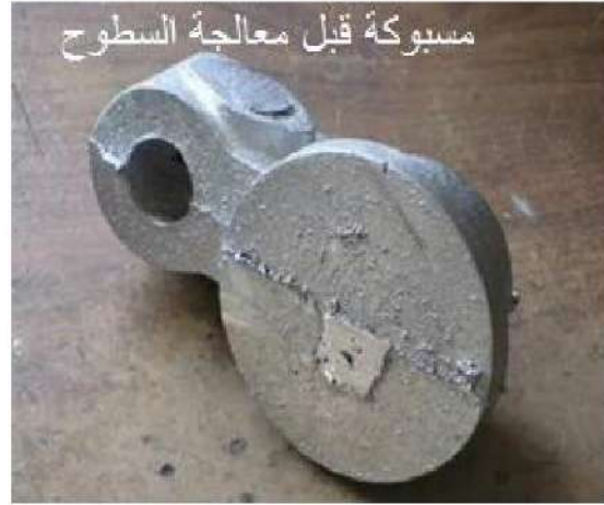
الشكل (18-5) المسبوكة قبل وبعد أنجاز السطوح
