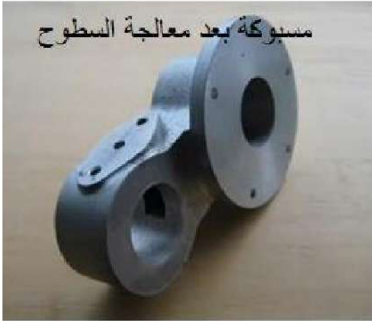
الشكل (18-5) المسبوكة قبل وبعد أنجاز السطوح
