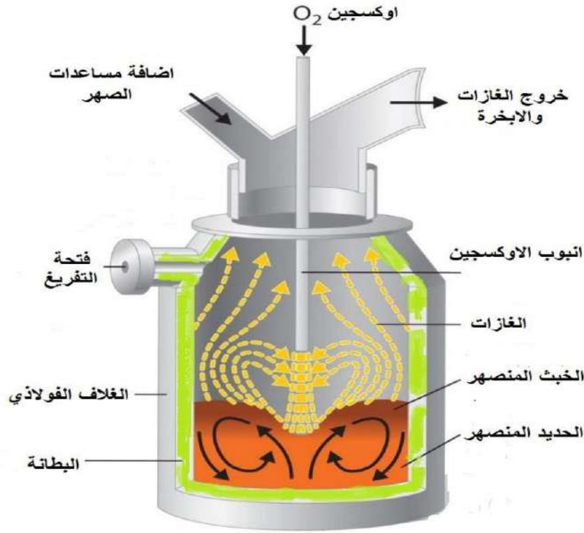
شكل (10-1) صورة توضيحية لفرن الأوكسجين القاعدي
