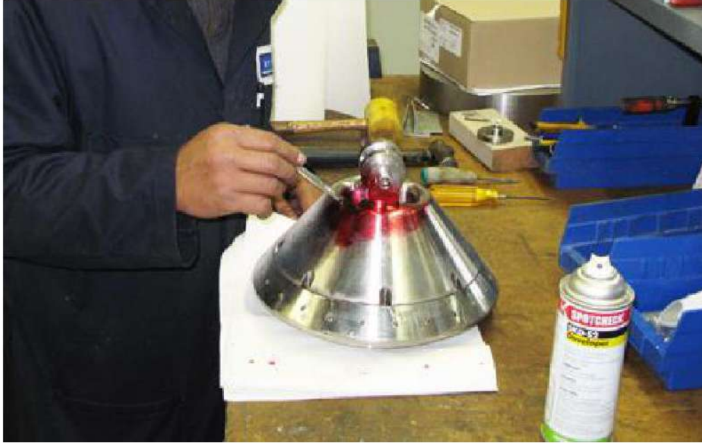
الشكل ( 5-22 ) فحص بالمواد النافذة
