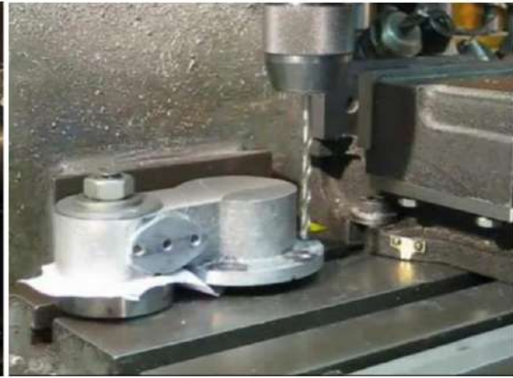
الشكل (5-14) عمل عدة ثقوب في المسبوكة الشكل (5-15) خراطة وجهة للمسبوكة
