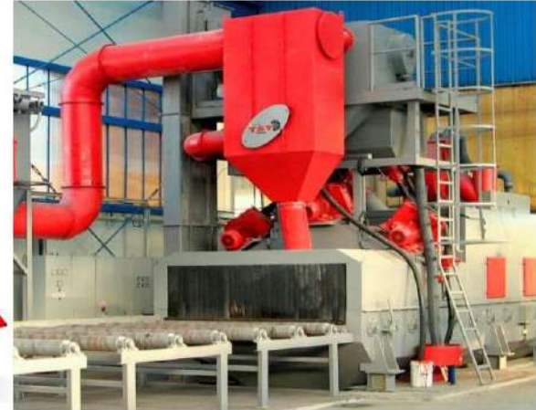
الشكل (5-11) ماكينات تنظيف للمسبوكات الكبيرة
