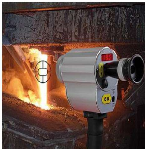
شكل (2-11) صور للمقياس الإشعاعي لقياس درجة الحرارة أثناء تفريغ منصهر المعدن
