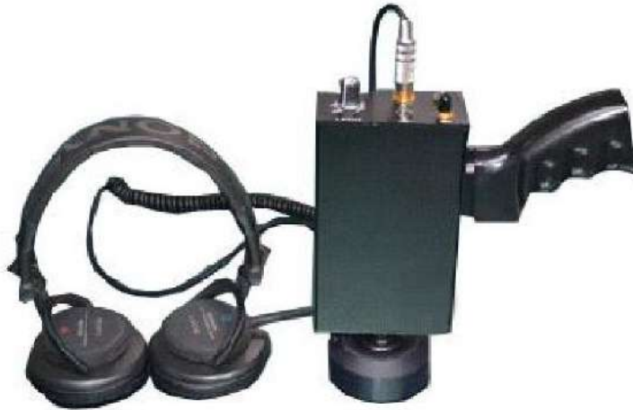
الشكل (21-5) جهاز إلكتروني للفحص بالصوت والطرق
