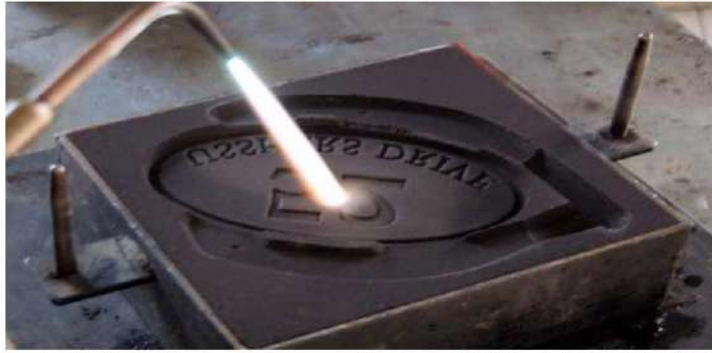
الشكل (4-6) طريقة التجفيف اليدوي باستخدام المشعل الغازي
