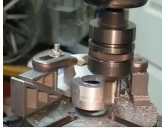
الشكل (16-5) تفريز سطح المسبوكة الشكل (17-5) تجليخ المسبوكة على ماكينة التجليخ
