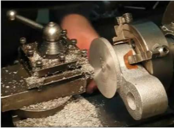
الشكل (5-14) عمل عدة ثقوب في المسبوكة الشكل (5-15) خراطة وجهة للمسبوكة
