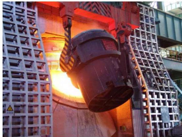
شكل (12-1) صور لعملية شحن المعدن المنصهر إلى فرن الأوكسجين القاعدي
