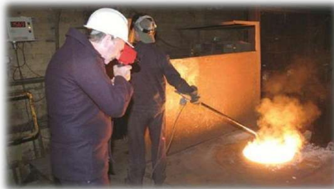
الشكل (2-5) استخدام المزدوج الحراري ومقياس درجة الحرارة الضوئي لقياس درجة حرارة منصهر معدن في الفرن
