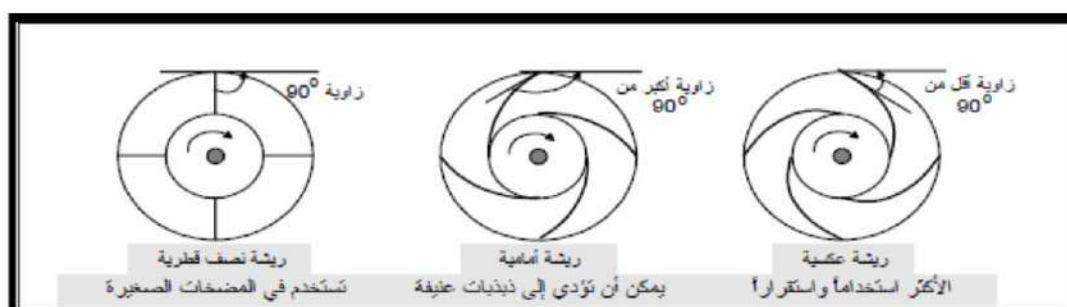
الشكل (10.4) أشكال ريش العضو الدوار
