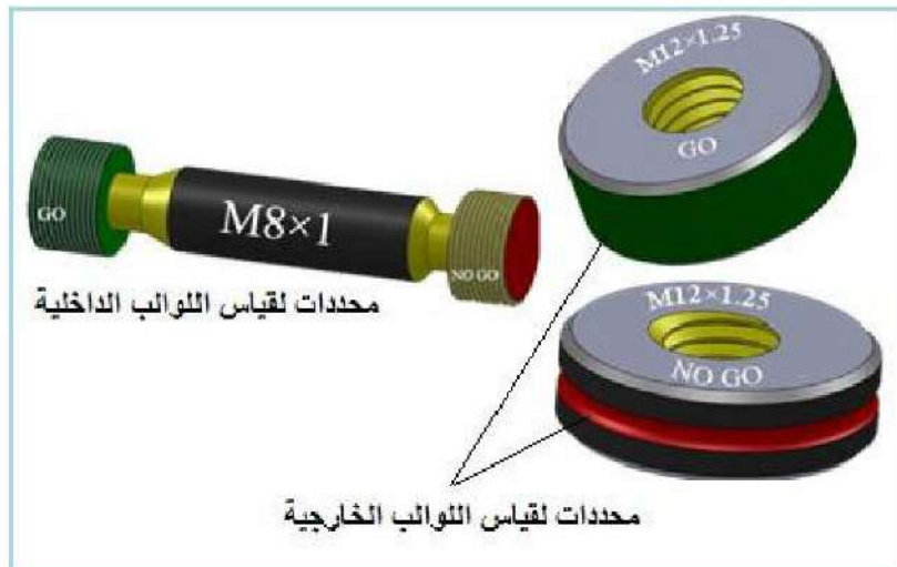
الشكل (59-1) محددات لقياس اللوالب الداخلية والخارجية.
