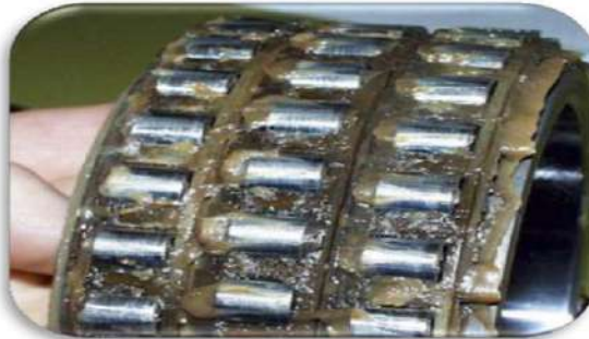
الشكل (16-7) تشحيم كراسي تحميل مخروطي.
