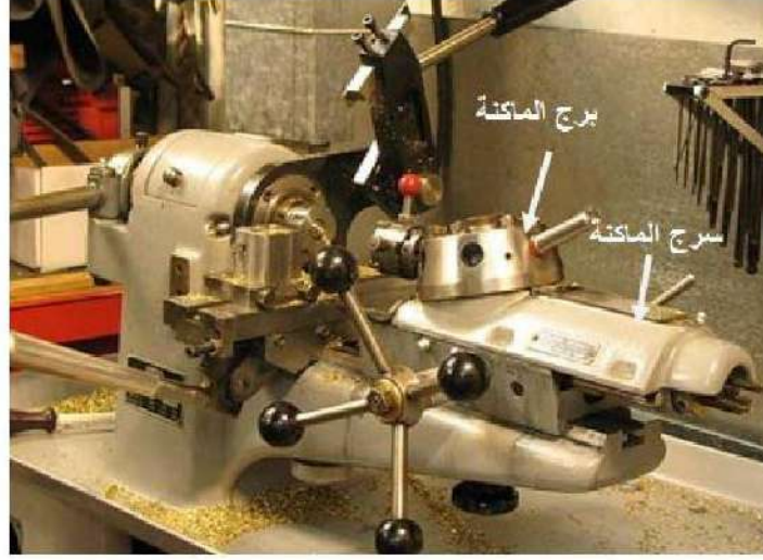
الشكل (1-18) مخرطة التماسح البرجية.
