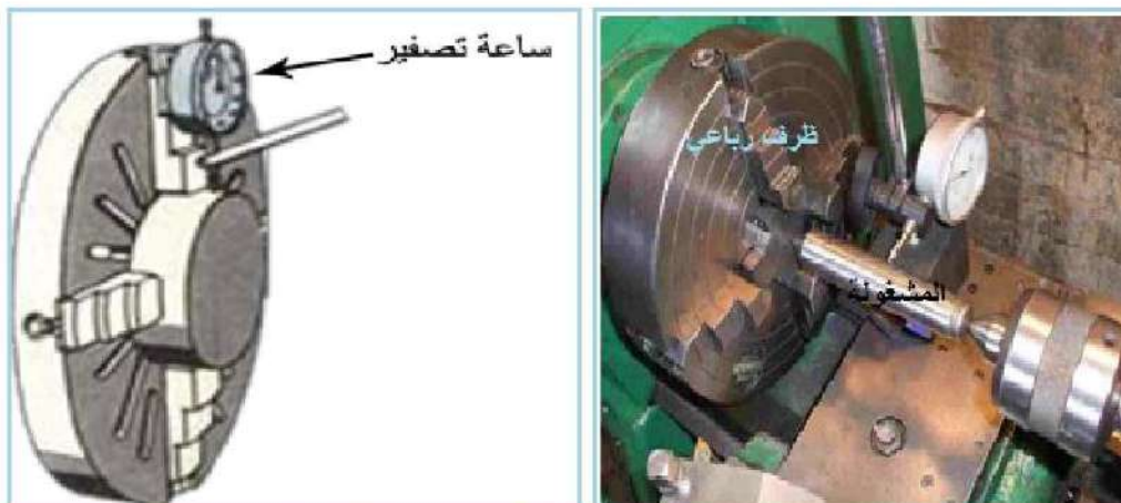
الشكل (1-43) الخراطة اللامركزية باستعمال ظرف رباعي.
