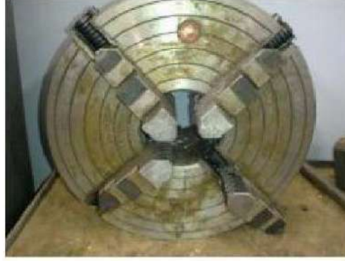
الشكل (27-2) الظرف الرباعي الفكوك ذو اللقم المستقلة.
