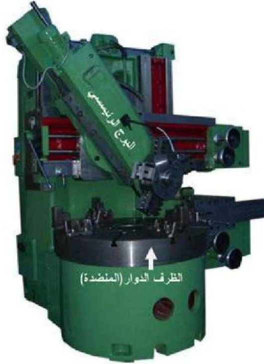
الشكل (19-1) ماكينة الخراطة ذات البرج العمودي.
