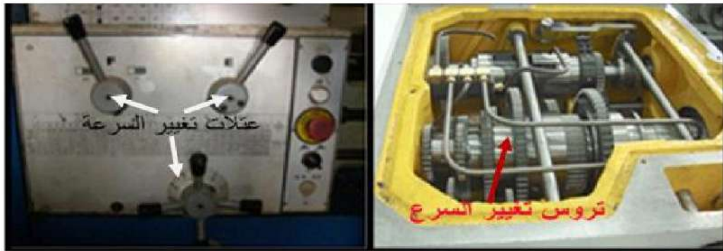
الشكل (15-1) صندوق التروس وجدول السرعة وعتلات التغيير.
