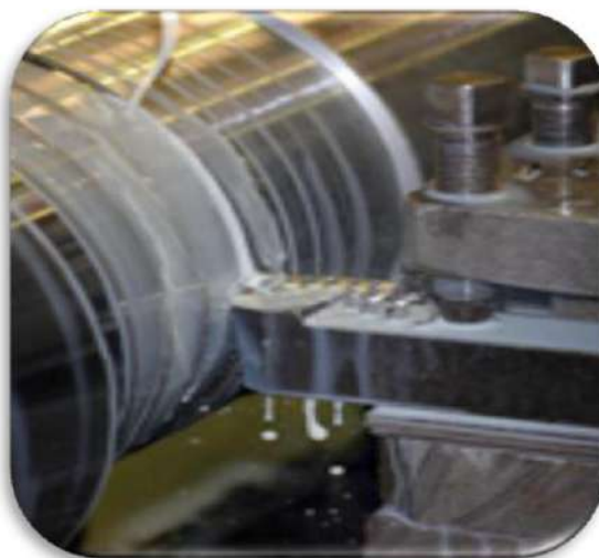
الشكل (5-7) يوضح استعمال المستحلب للتبريد والتنظيف.
