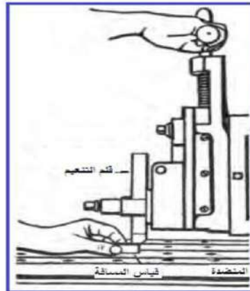
الشكل (5-16) ضبط المسافة بين المشغولة والحد القاطع
