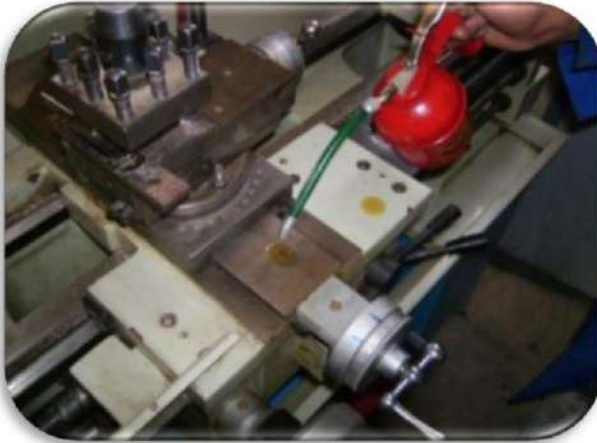
الشكل (7-12) تزييت أجزاء متحركة في المخرطة.
