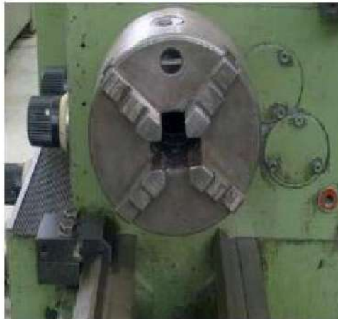
الشكل (26-2) الظرف رباعي الفكوك (اللقم).
