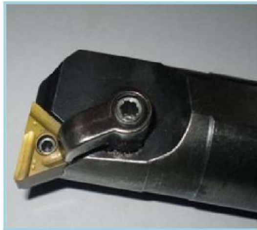
الشكل(2-16) طريقة استعمال القفل لتثبيت اللقم .
