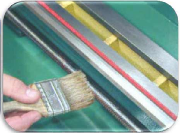
الشكل (7-12) تزييت أجزاء متحركة في المخرطة.
