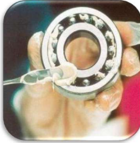
الشكل (7-17) تزييت كرسي التحميل.
