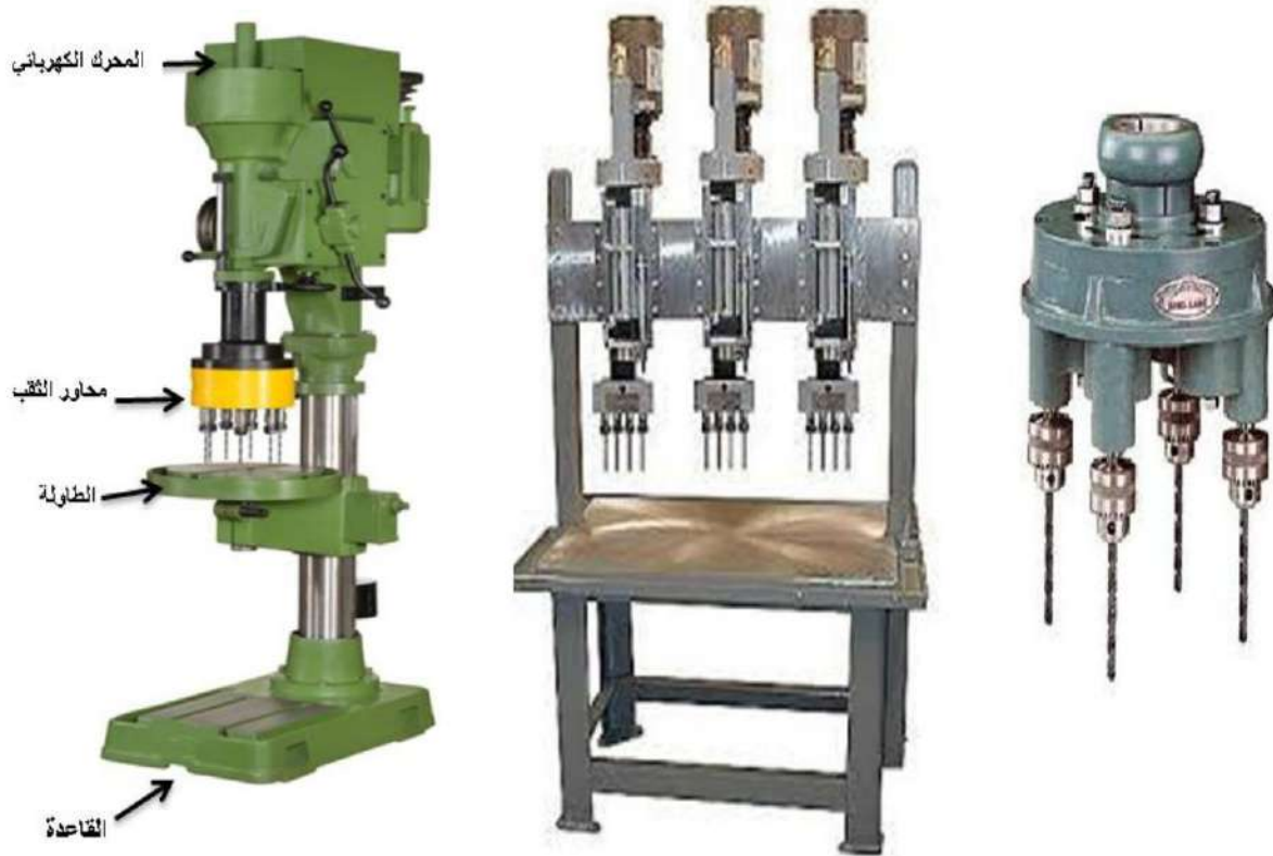
شكل (4-6) : يوضح أكثر من نموذج لآلة الثقب متعددة المحاور.
