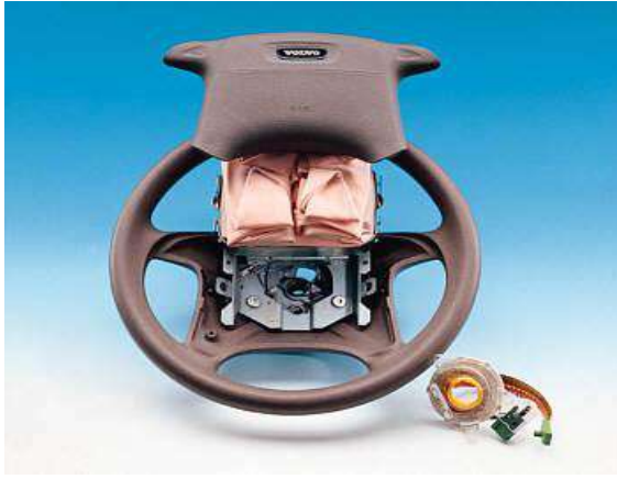
شكل (5-16) وضع كيس الهواء للسائق والراكب الامامي
