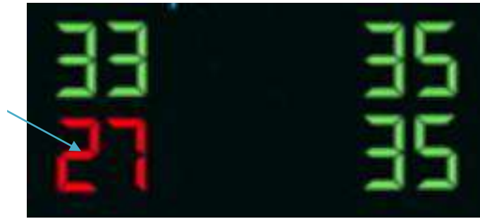
شكل ( 6-15 ) شاشة النظام عليها قراءة لمقدار ضغط الإطار والتحذير باللون الأحمر.
