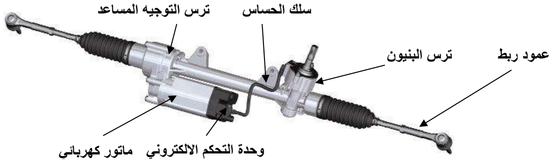
شكل (5- 14) نظام التوجيه الالكتروني المساعد نوع محرك المحور
