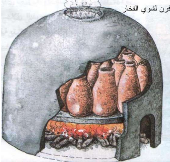
شكل 1-6 الكورة القديمة المستخدمة لشوي المنتجات الخزفية
