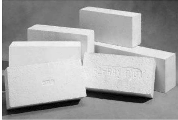
الطابوق الحراري المستخدم لتبطين افران درجات الحرارة العالية
