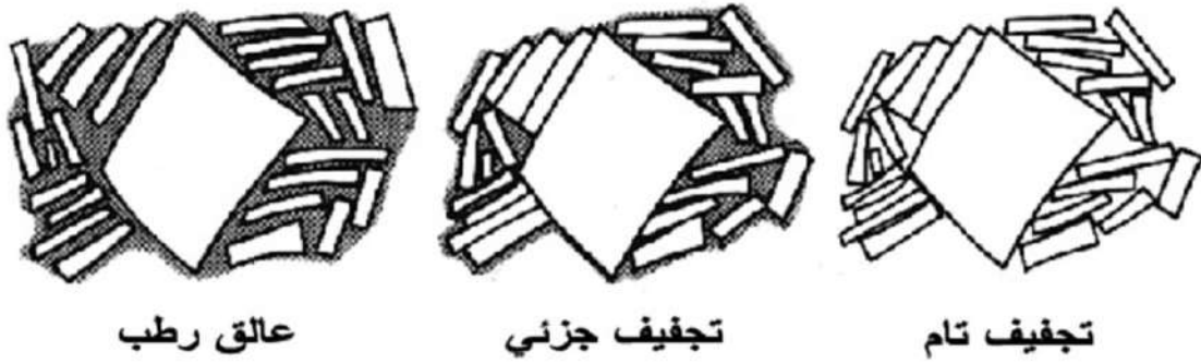
شكل 1-7: التجفيف يؤدي إلى تناقص المسافات البينية بين صفائح الطين بسبب تناقص المحتوى المائي.
