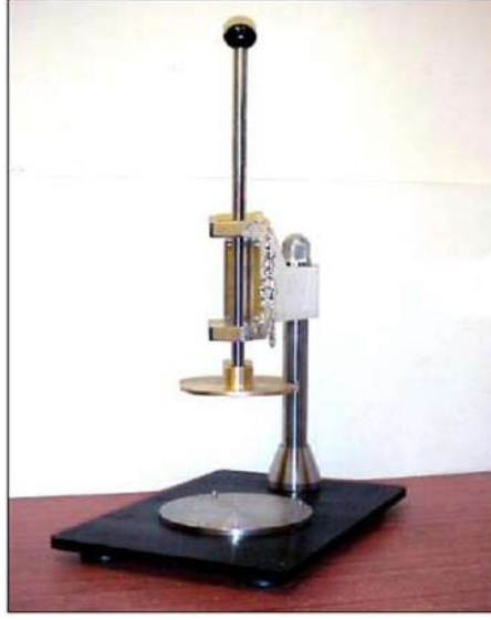
شكل 5-1: جهاز بفركورن لقياس اللدونة
