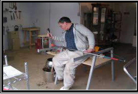
الشكل 5-2 يبين العامل وهو يتعامل مع العجينة الزجاجية بواسطة ملقط ويسند انبوب النفخ على عارضتين.
