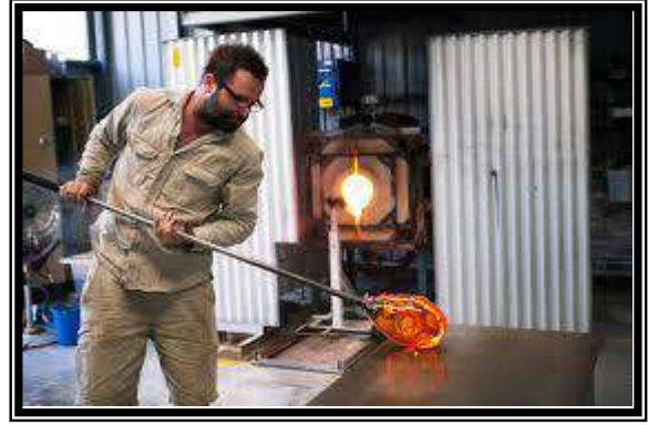
الشكل 5-1 يبين العامل وهو يشكل العجينة الزجاجية بواسطة انبوب النفخ على منضدة التشكيل.
