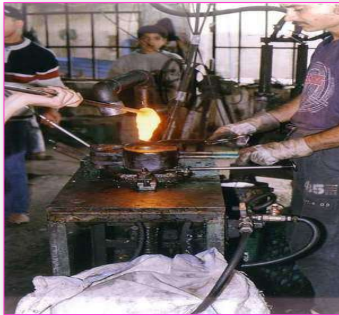
شكل 5-6 طريقة صب الزجاج في قوالب بعد النفخ
