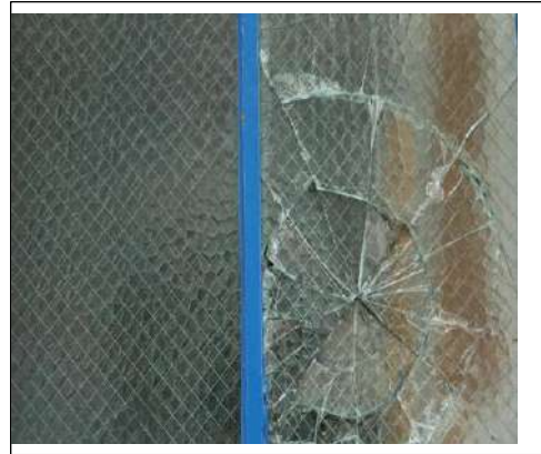
شكل 7-6 الزجاج المنقوش والمدعم بالأسلاك (لاحظ الزجاج لا يتطاير بعد الكسر لوجود الاسلاك المعدنية)
