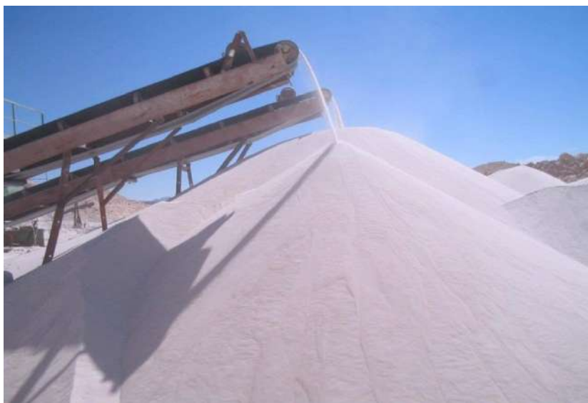
الشكل 2-3 تهيئة رمل السيلكا لصناعة الزجاج.
