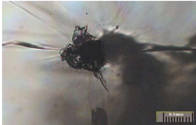
شكل 25-7 الشقوق الظاهرة على حافة منطقة الانهيار الكهربائي للزجاج.
