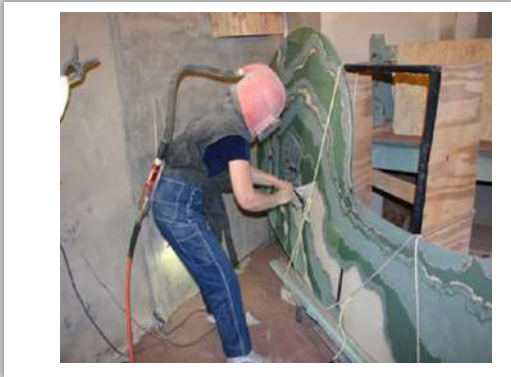
شكل 5-41 تشكيل لوحة من الزجاج بالسفّع بالرمل.
