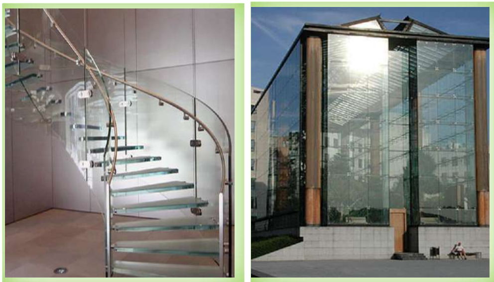
شكل 5-32 بناية مغلقة بالزجاج ودرج زجاجي مصنعين من الزجاج المقوى حرارياً.
