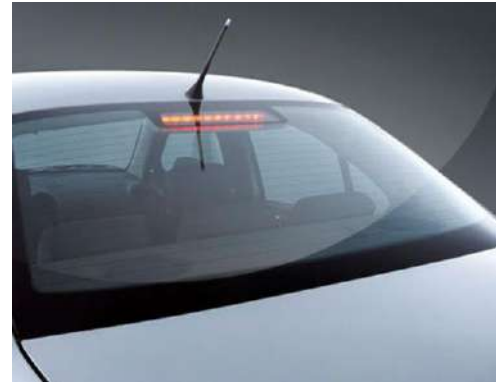
شكل 5-35 استعمالات الزجاج المقسى في الزجاج الخلفي للسيارات وشاورات الحمامات.
