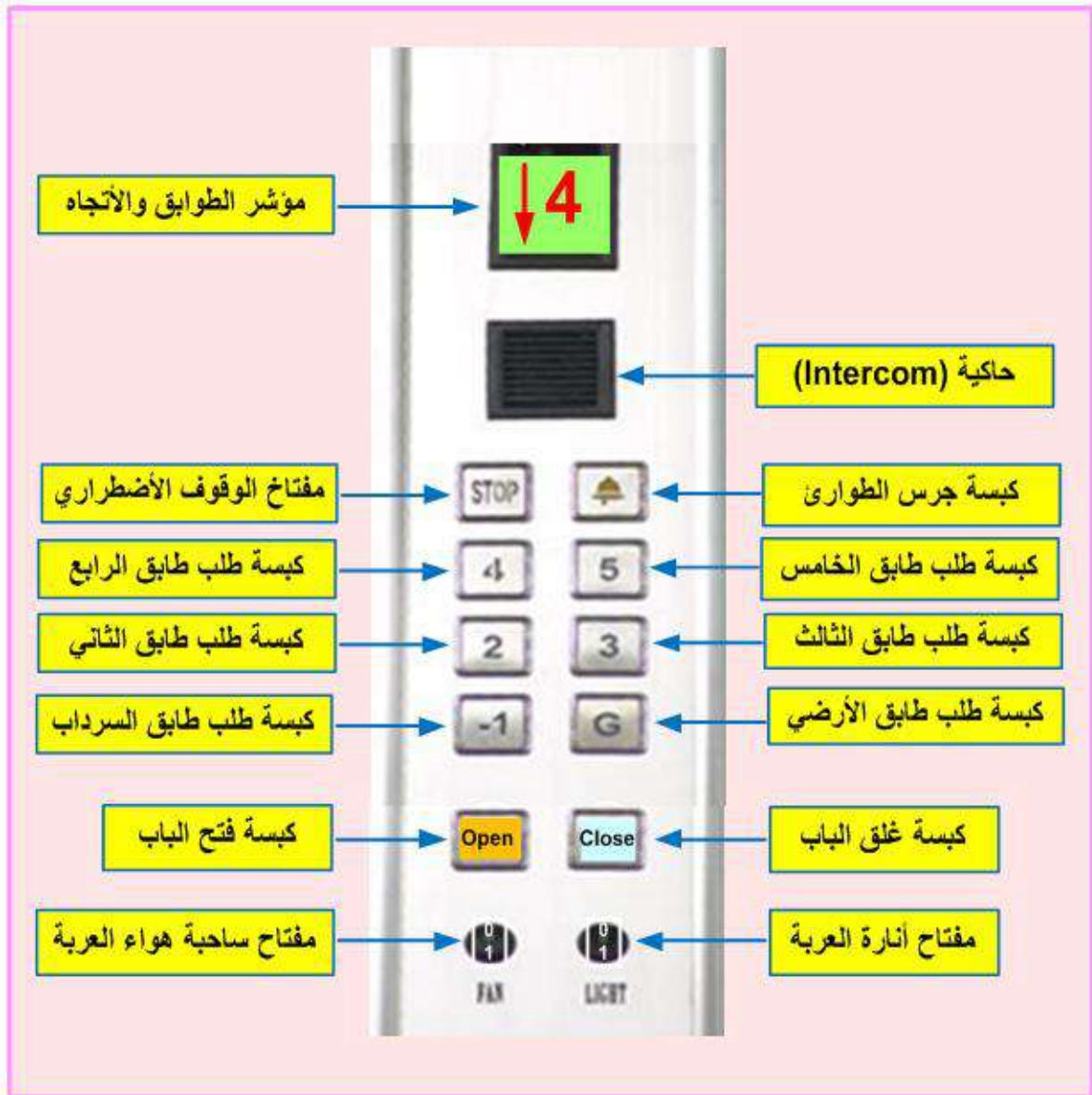
شكل 3 - 14 أجزاء لوحة الطلبات الداخلية لمصعد ستة طوابق وباب آلي
