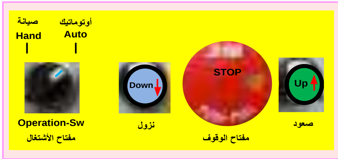
شكل 3 - 6 الأجزاء الرئيسية لصندوق الصيانة
