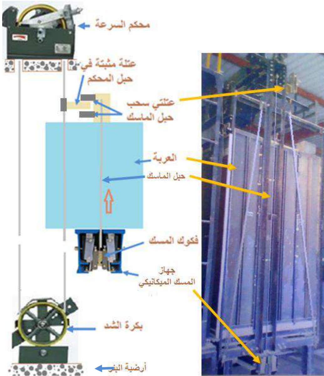
شكل 23-1 عمل جهاز الأمان الميكانيكي
