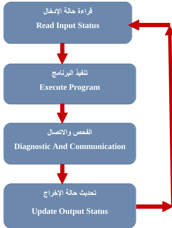
شكل 23-5 عملية المسح لـ (PLC)
