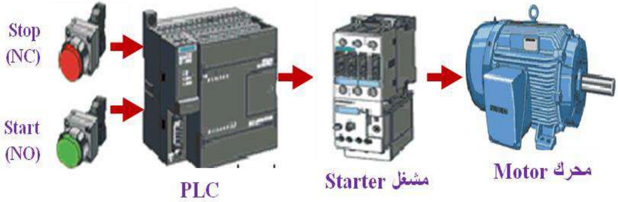
شكل 3-5 ربط الأجهزة أو المعدات مع (PLC)
