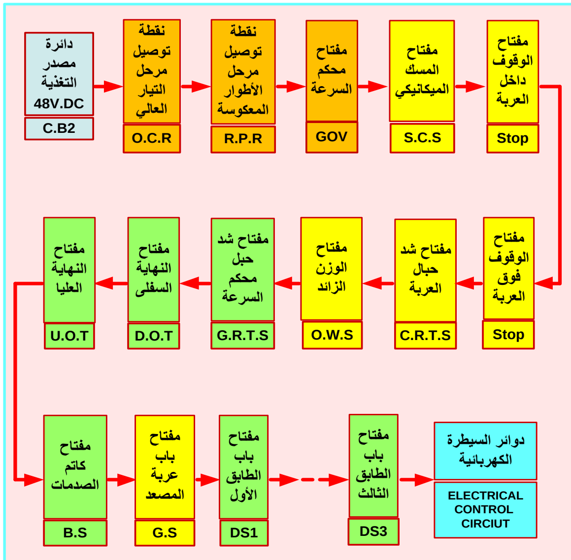
شكل 3 - 2 مخطط توضيحي لدائرة الأمان
