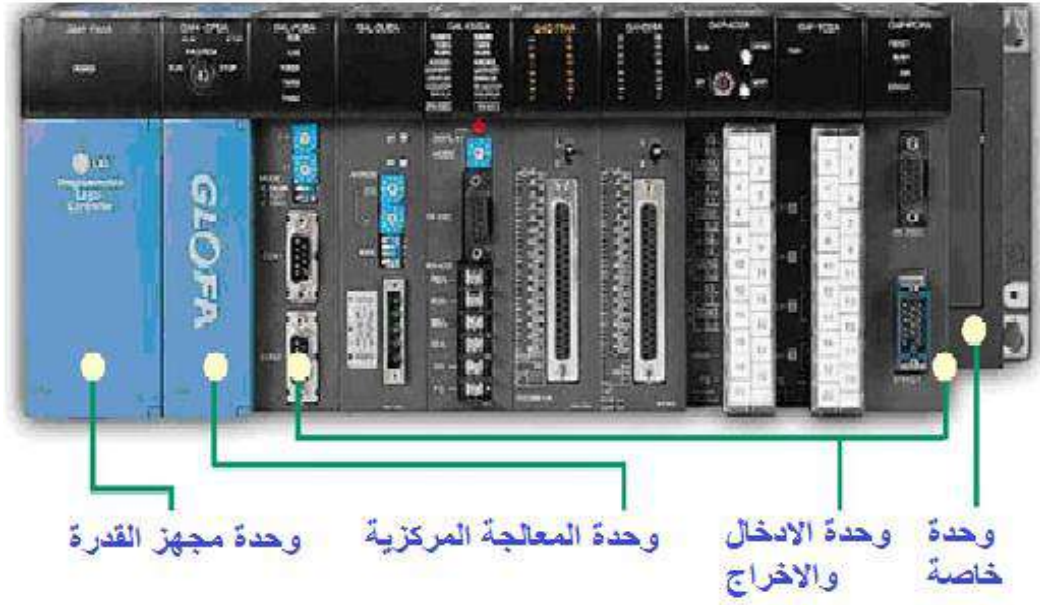
شكل 5-25 أجهزة (PLC) نوع التركيبية
