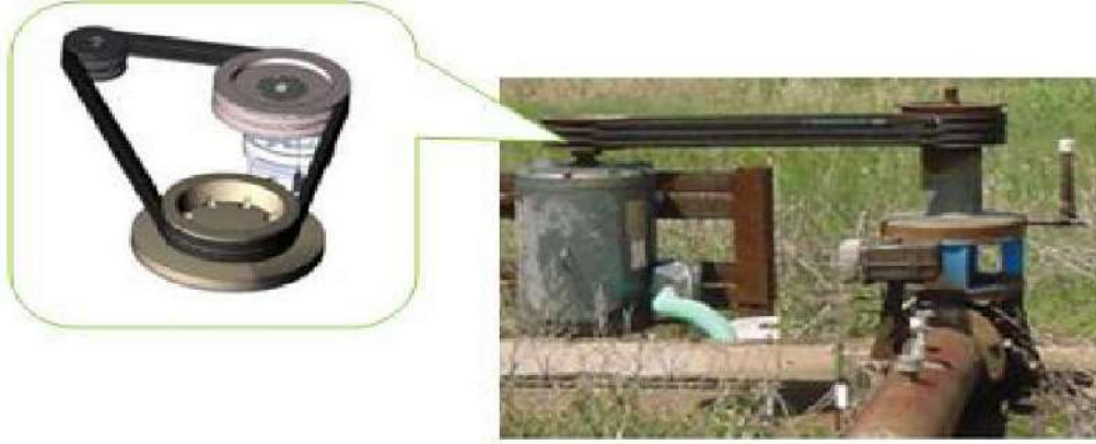
شكل 4 - 31 نقل الحركة بواسطة السيور
