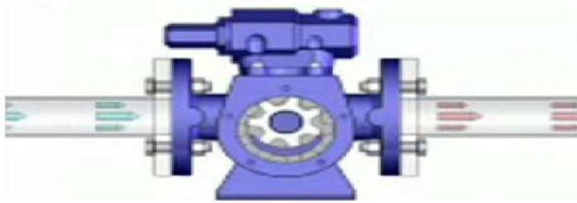
شكل 4 - 25 مضخة ذات التروس الداخلية
