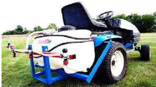
الشكل 5 - 18 آلة رش محمولة خلف الجرار الزراعي.
