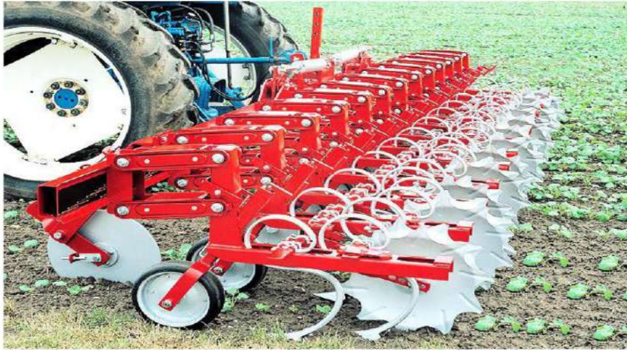
الشكل 4-5 : العازقة المركبة ذات المدى الواسع.
