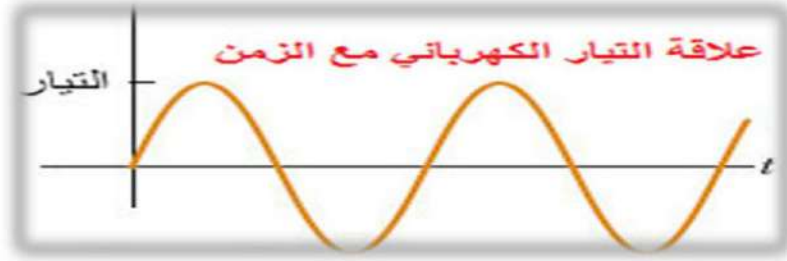
شكل 3-7 : التيار الكهربائي الناتج عن المولد ويسمى التيار المتردد.
