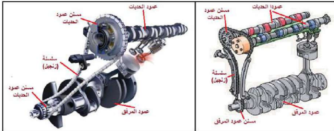
شكل 1-32 : موقع عمود الحدبات في رأس كتلة الأسطوانات
