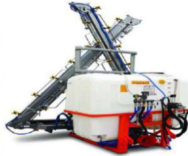
الشكل 5 - 18 آلة رش محمولة خلف الجرار الزراعي.
