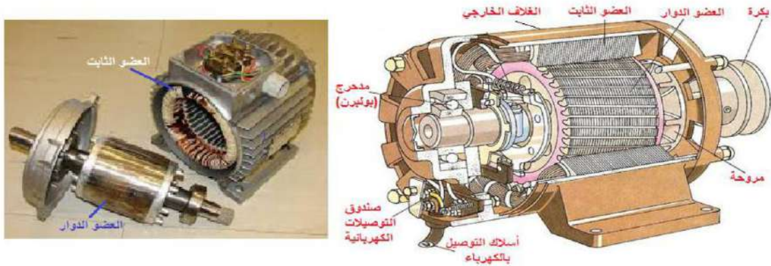
شكل 7- 12: المكونات الرئيسية للمحرك الكهربائي
