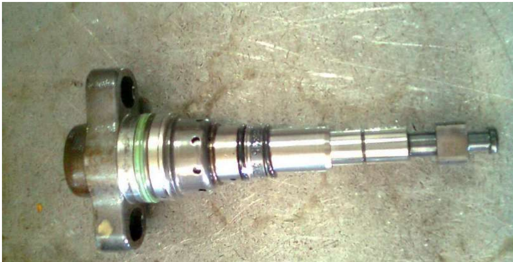
شكل (141-1) مجموعة الكباس مبين فيها الكباس
