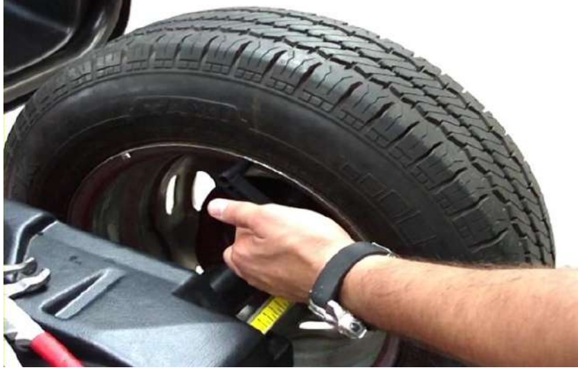
شكل (4-108) سحب مسطرة القياس في الجهاز إلى شفة الإطار المعدني وقم بأخذ القياس
