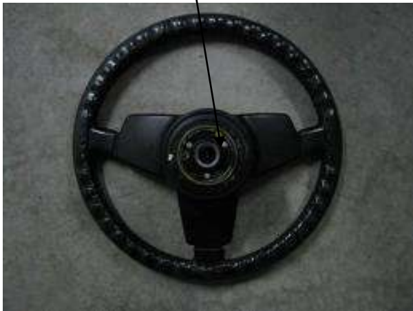
شكل ( 7-4 ) اخرج عجلة القيادة شكل ( 8-4 ) فحص حزوز وسط العجلة وباقي أجزائها
