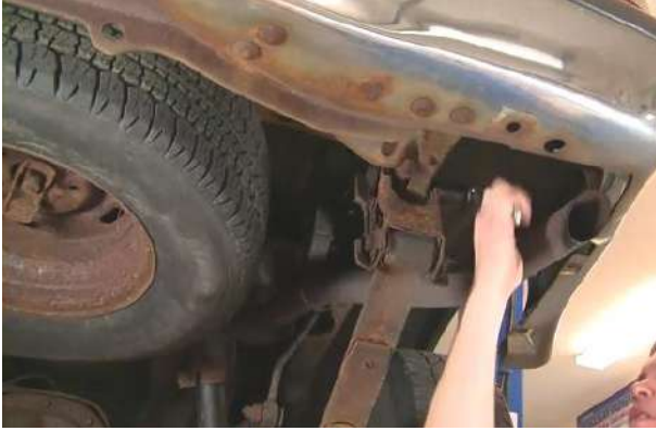
شكل ( 5-3 ) فك صامولة لولبي ربط الطرف الحر للنابض الورقي بالشاصي
