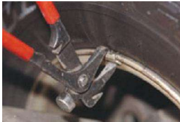
شكل (4-107) رفع قطع الرصاص الموجودة في الإطار المعدني من داخل الإطار وخارجه
