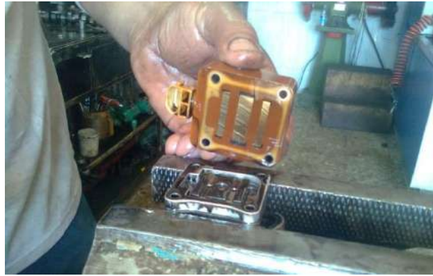
شكل (161-1) فتح المغناطيس الكهربائي للحاقن
