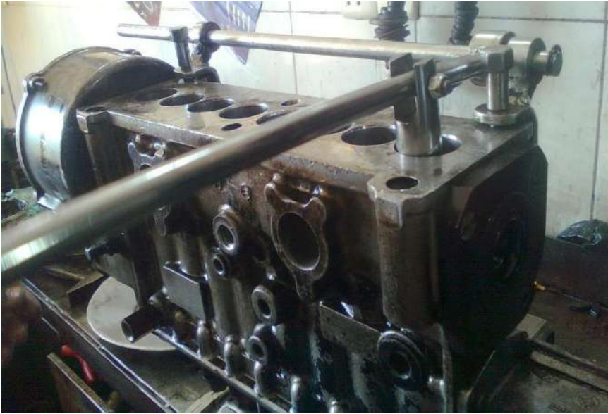
شكل (147-1) العدة الخاصة لضغط مجموعة الكباس
