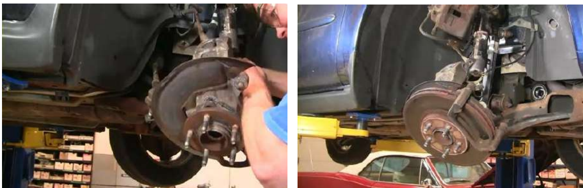
شكل (56-3) تعليق الموقف في مكان مناسب شكل (57-3) افتح اللوالب المثبتة لسرّة العجلة في الحامل
