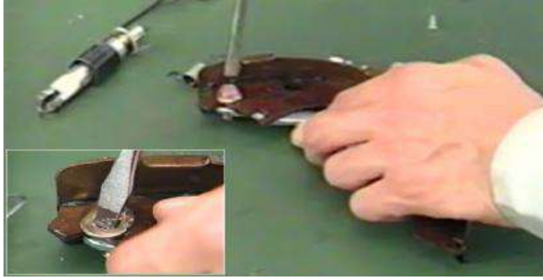
شكل (30-2) فصل الاطار الخلفي الواقى للحذاء الموقف
