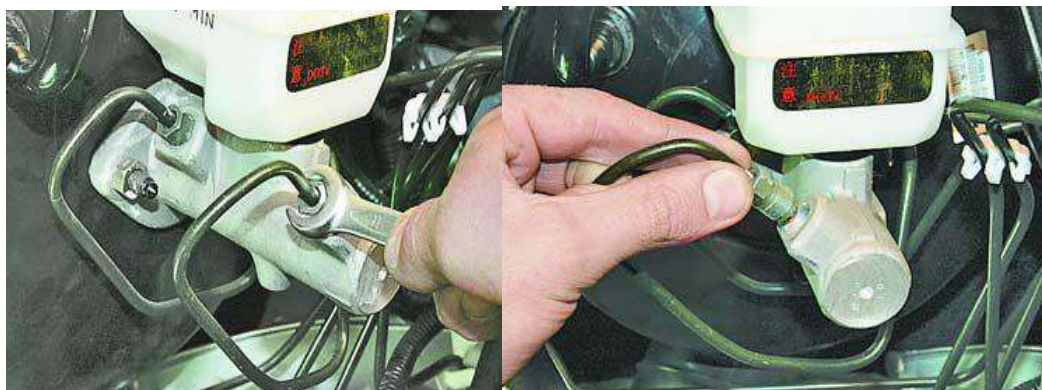
شكل (9-2) فتح الانابيب المتصلة بالاسطوانة الرئيسية للموقف
