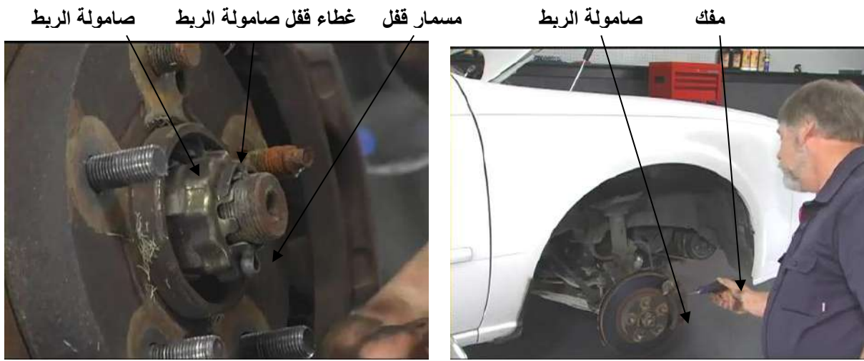
شكل (93-3) منع حامل العجلة من الحركة بوضع المفك شكل (94-3) مسمار قفل الصامولة
