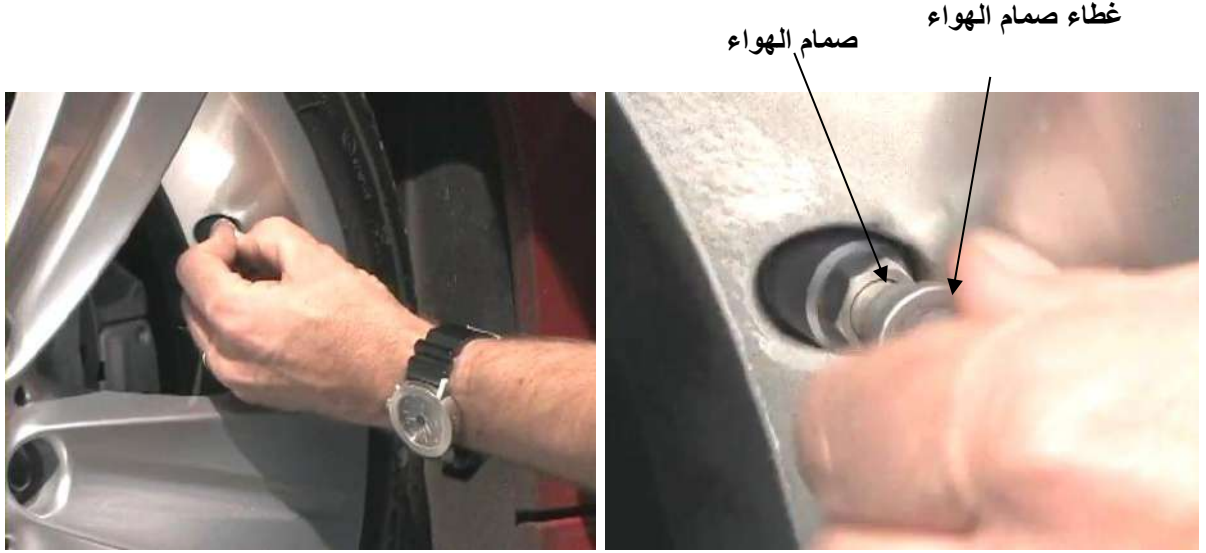
شكل (5-15) أخرج الهواء الزائد
