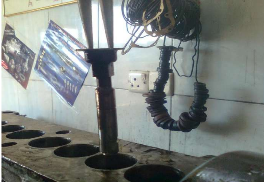
شكل (1-136) استخراج الكباسات من فتحات السدادات النحاسية
