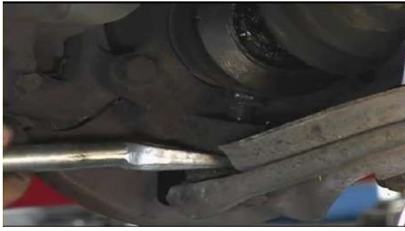
شكل (101-3) سحب مسمار القفل وفتح الصامولة شكل (102-3) نزع وصلة التعليق عن العجلة
