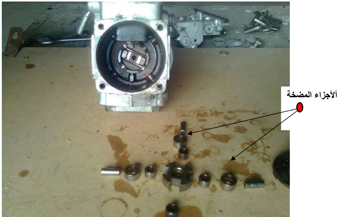
شكل (157-1) أجزاء مضخة التوزيع
