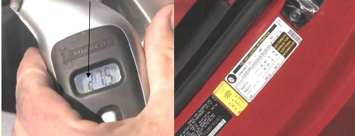
شكل (5-10) جهاز فحص ضغط الهواء شكل (5-11) توصيات ضغط الإطار على باب السائق
