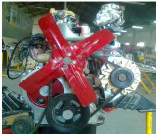
شكل (1-103) تركيب البكرات والسيور بعد اكمال تركيب غطاء مسننات التوقيت
