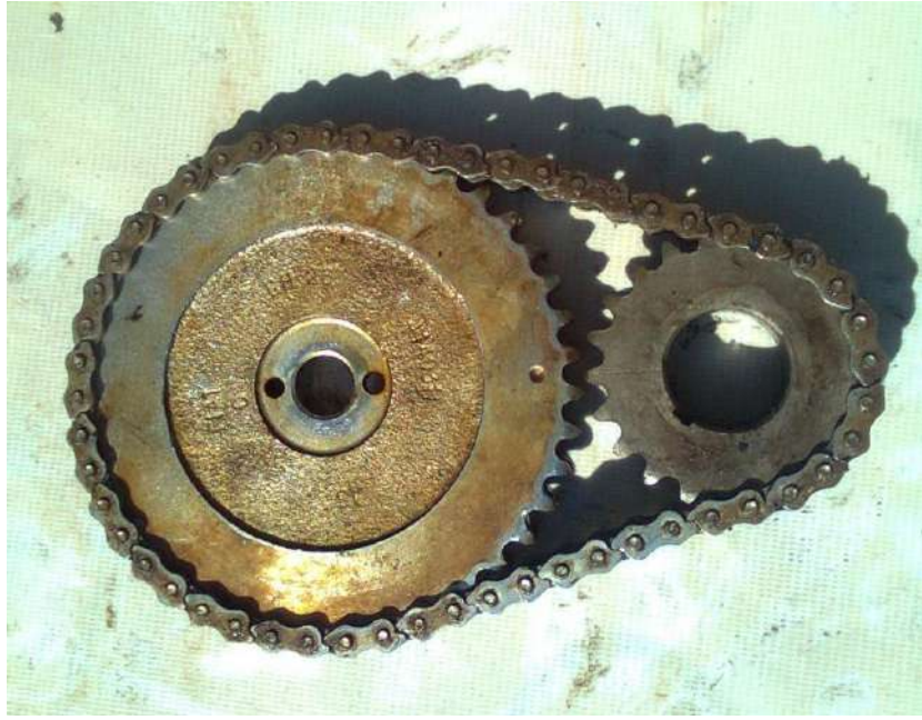
شكل (108-1) تثبيت المسننات والسلسلة خارج المحرك
