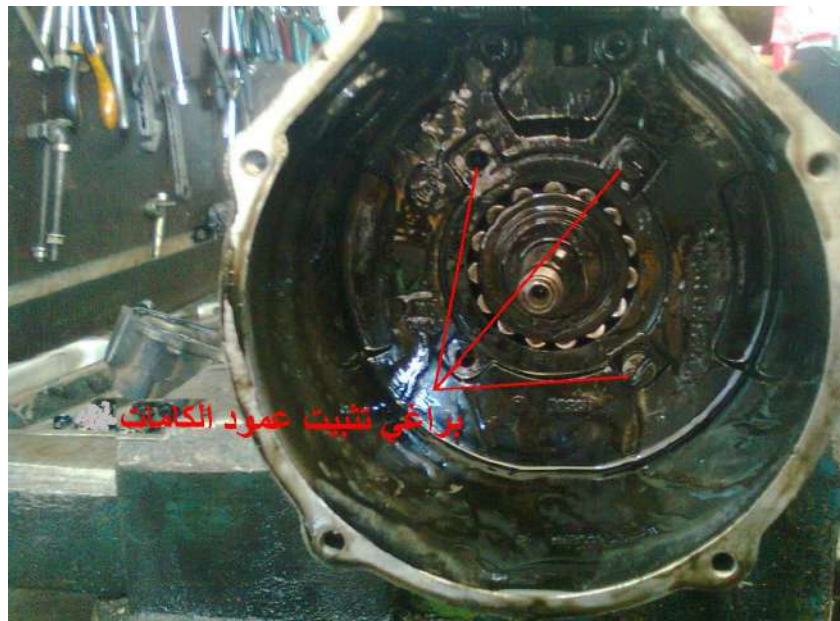
شكل (1-131) براغي تثبيت عمود الحدبات
