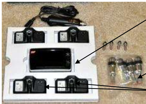
شكل (5-19) جهاز قياس ضغط وحرارة الإطار
