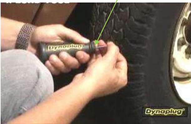
شكل (3-5) تحميل العدة بالحشوة
