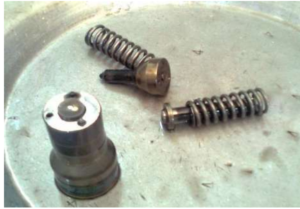
شكل (160-1) اجزاء رأس الحقن
