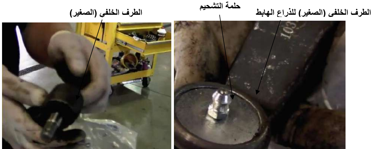
شكل ( 49-4 ) حلمة التشحيم مربوطة مع الطرف الخلفي للذراع شكل ( 50-4 ) ذراع جديد
