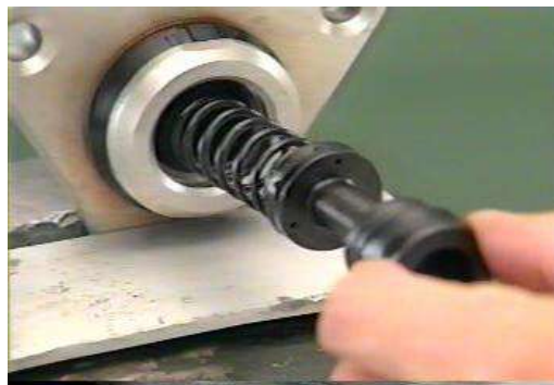
شكل (14-2) إخراج المكبس الثانوي بسحبها من جسم الاسطوانة الرئيسية للموقف
