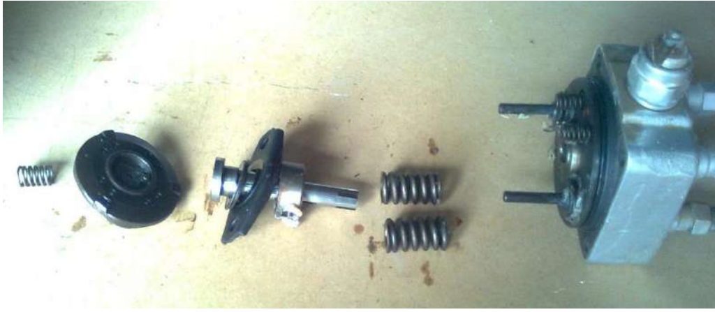
شكل (156-1) تفكيك موزع الوقود
