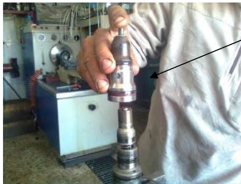
شكل (167-1) إعادة تركيب الحاقن الكهربائي
