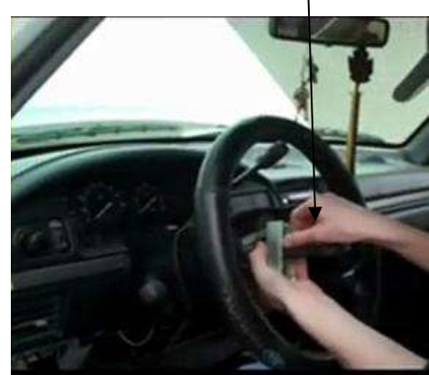
شكل ( 5-4 ) وضع فخة السحب شكل (6-4) إدارة لولب تثبيت عجلة القيادة بواسطة المفتاح
