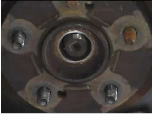
شكل ( 105-3 ) الطرق على الصامولة شكل ( 106-3 ) طرد بداية العمود خارج حامل العجلة
