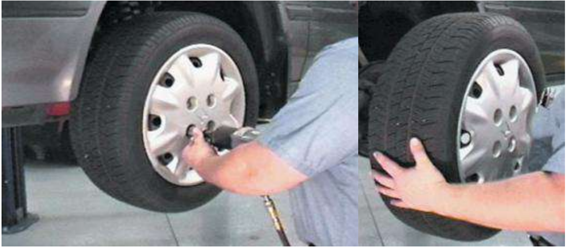
شكل (21-2) فتح لوابب تثبيت العجلة في المركبة
