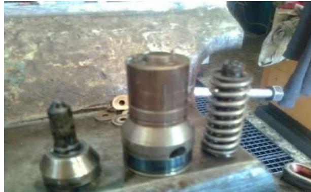
شكل (1-159) ترتيب أجزاء الحاقن
