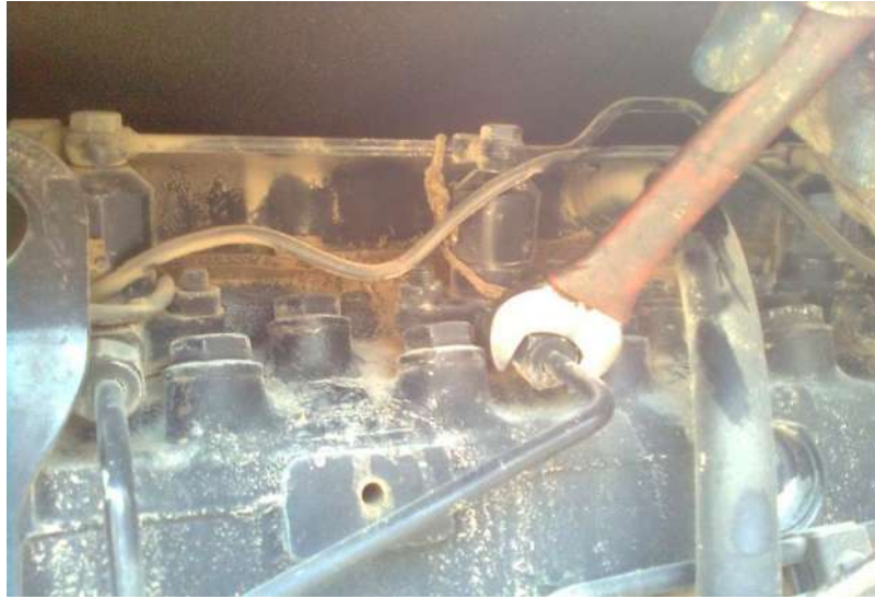
شكل (179-1) تنفيس الحاقنات (البخاخات)
