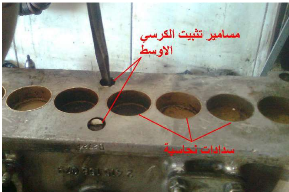
شكل (133-1) براغي (مسامير) تثبيت الكرسي الأوسط
