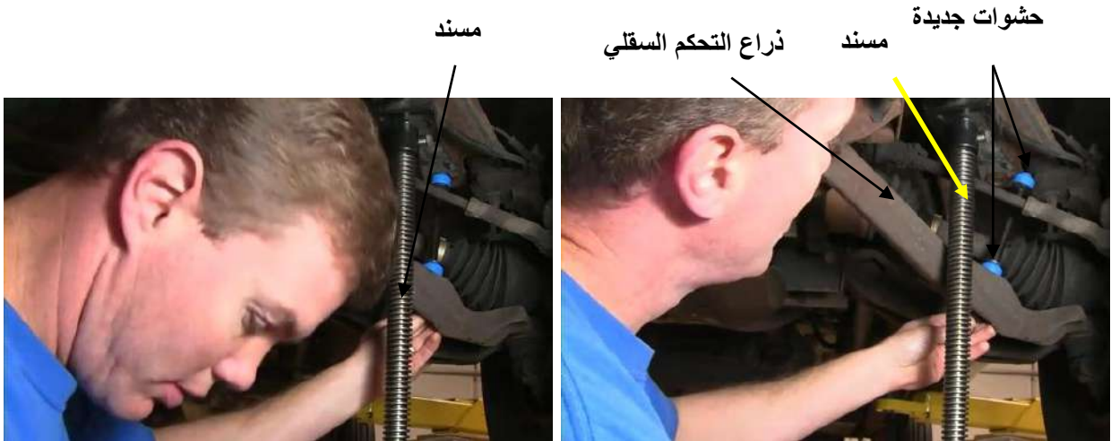
شكل ( 30-3 ) إنزال المسند بعد إدخال اللولب
