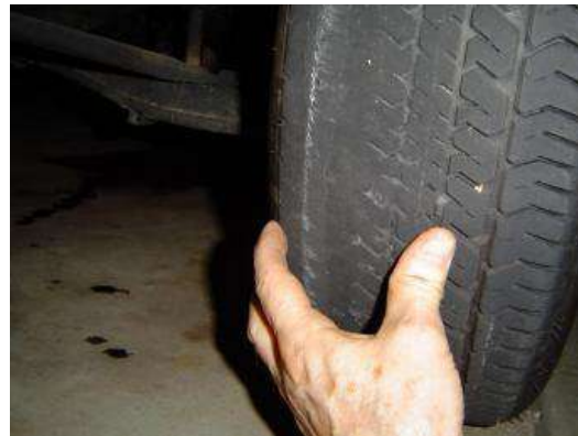
شكل (4-102) فحص الإطار المطاطي من وجود الشقوق
