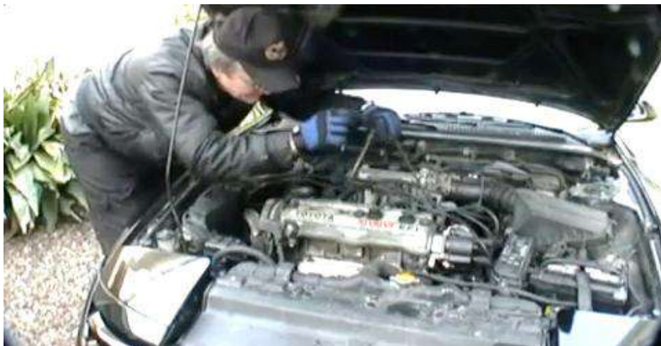
شكل (47-1) إزالة اسلاك التوصيل او خراطيم الوقود (محرك الديزل)
