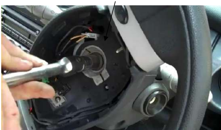
شكل ( 5-4 ) وضع فخة السحب شكل (6-4) إدارة لولب تثبيت عجلة القيادة بواسطة المفتاح
