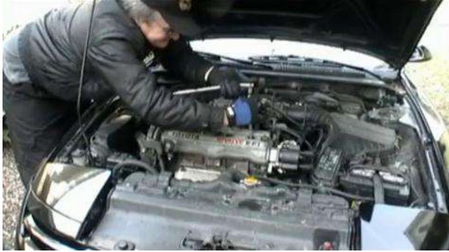
شكل (48-1) فك شمعات القدح او حاقنات الوقود (محرك الديزل)
