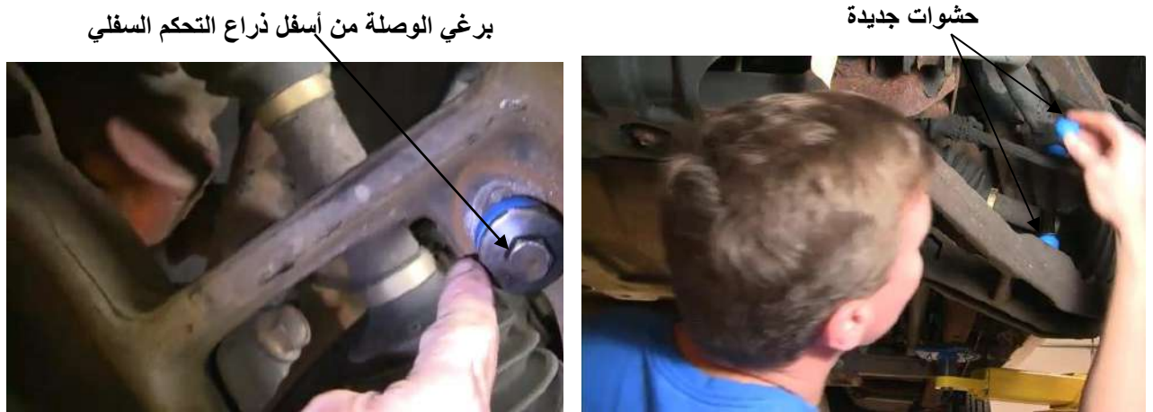
شكل ( 31-3 ) إدخال الحشوة المطاطية شكل ( 32-3 ) يظهر رأس اللولب الذي تم تركيبه مع الوصلة من أسفل ذراع التحكم السفلي
