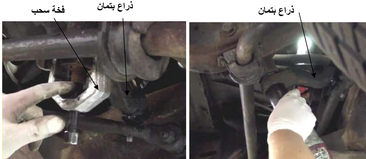
شكل ( 46-4 ) تركيب عدة السحب الفخّة الطرف الأمامي للذراع الهابط (بتمان)
