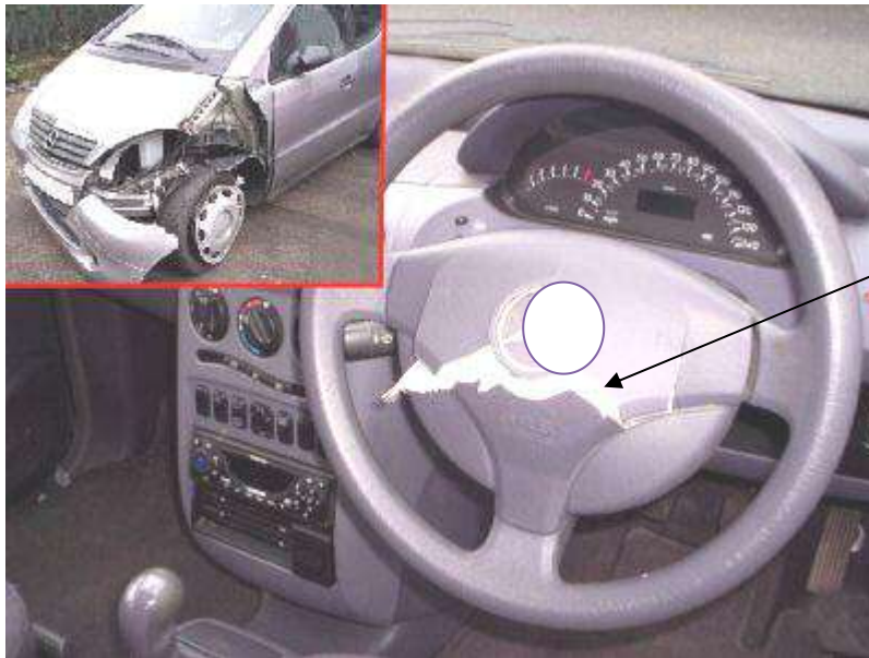
شكل ( 4-72 ) وسادة هواء محطمة بسبب حادث اصطدام
