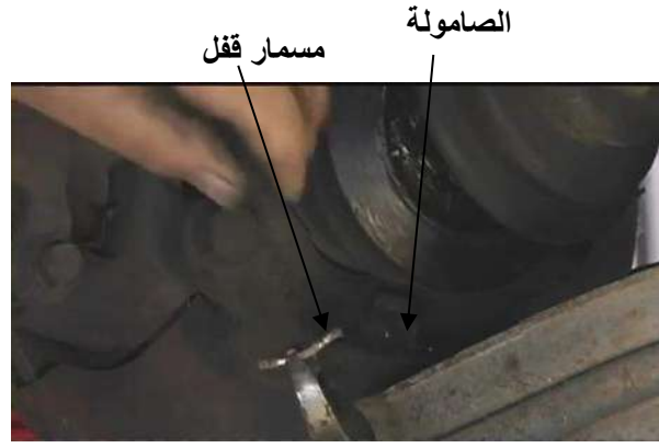
شكل (101-3) سحب مسمار القفل وفتح الصامولة شكل (102-3) نزع وصلة التعليق عن العجلة
