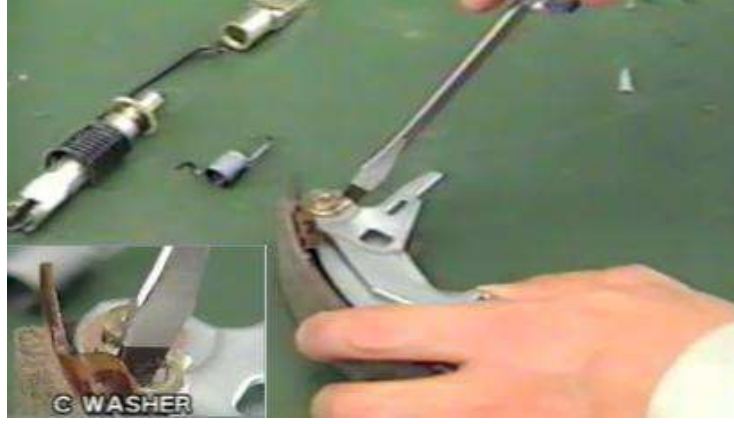
شكل (29-2) فصل حلقة تثبيت عتلة المعايرة
