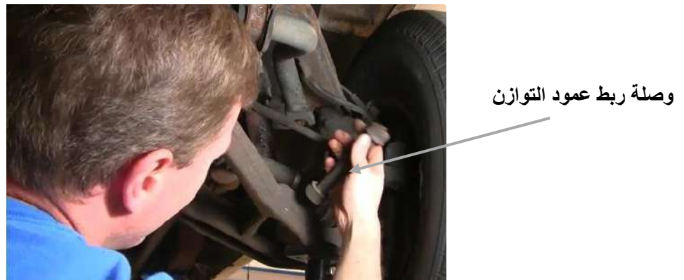
شكل ( 27-3 ) نزع وصلة الطرف الآخر
