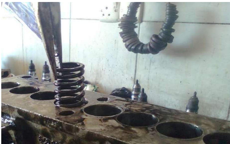
شكل (1-137) استخراج النوايض
