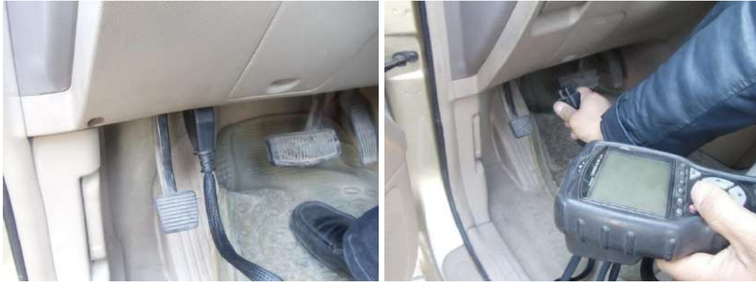
شكل (2-48) وضع وصلة تشخيص الأعطال الجهاز في مكانه المخصص له
