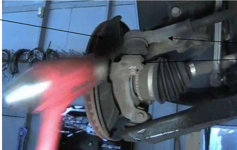
شكل ( 34-4 ) الطَّرْق على ذراع التوجيه
