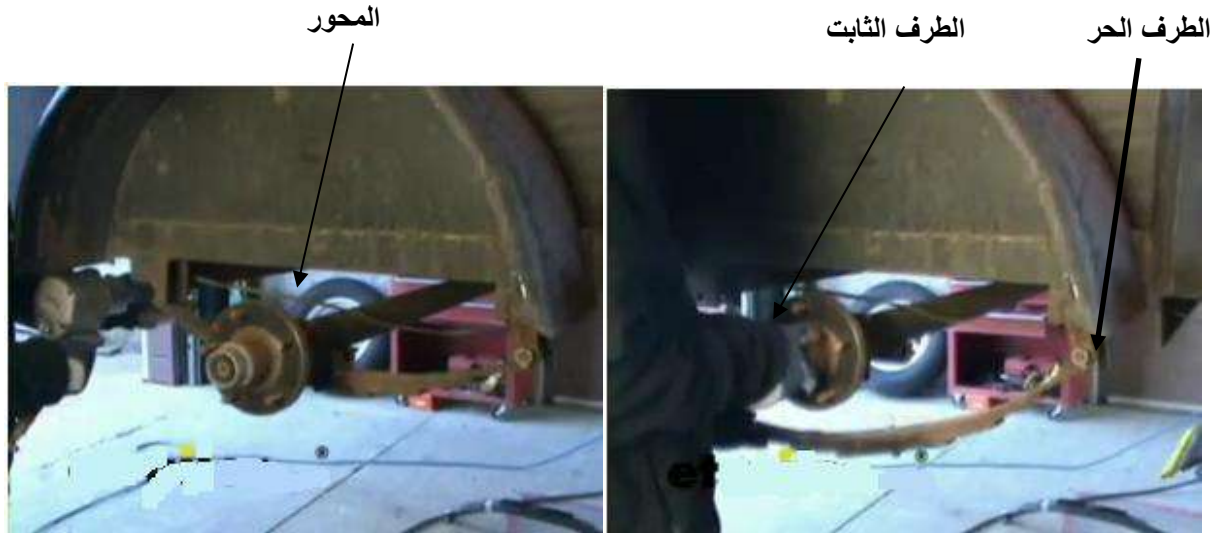
شكل ( 16-3 ) فتح صامولة برغي ربط النابض بالطرف الثابت شكل ( 17-3 ) إسناد النابض باليد
