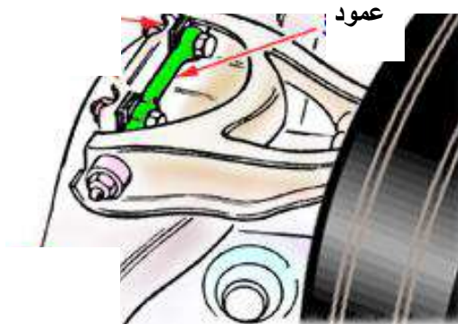
شكل (4-87) ضبط زاوية الانقياد التتبعي و زاوية ميل العجلة بواسطة رقائق معدنية للمعايرة
