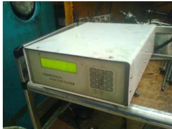
شكل (162-1) جهاز فحص ملف المغناطيس الكهربائي للحاقن الكهربائي
