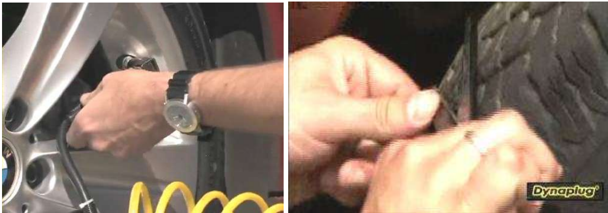
شكل ( 7-5 ) تزويد الإطار بالهواء
