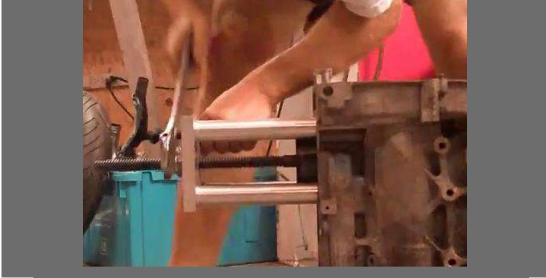
شكل (1-36) لف صامولة العمود المسنن مع اتجاه عقرب الساعة لإخراج البطانة
