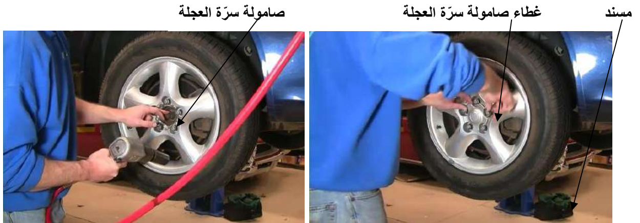
شكل (3-46) رفع وإسناد مقدمة السيارة وفك سرّة العجلة شكل (3-47) فك صامولة سرّة العجلة
