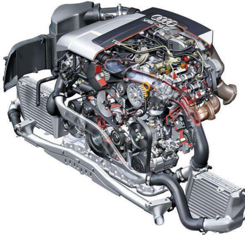
شكل (1-98) محرك ديزل يستخدم السير المطاطي المسنن في ادارة مسننات التوقيت
