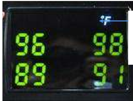
شكل (5-17) الشاشة تظهر درجة حرارة الإطارات الأربع
