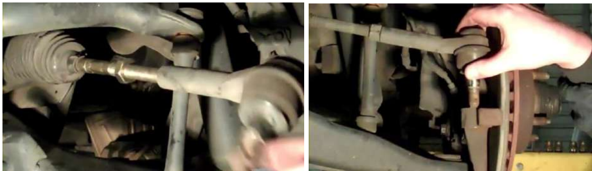
شكل ( 16-4 ) رفع عمود الربط الخارجي
