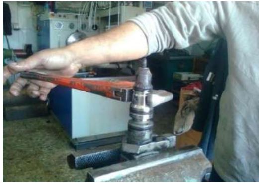
شكل (1-158) فتح الحاقن الكهربائي
