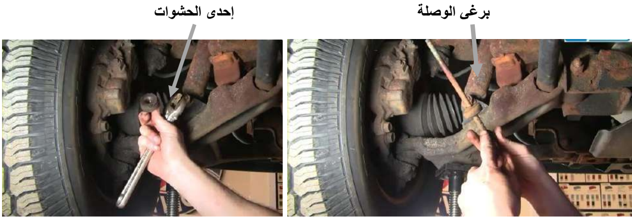
شكل ( 25-3 ) اخرج اللولب من مكانه شكل ( 26-3 ) فحص الحشوة
