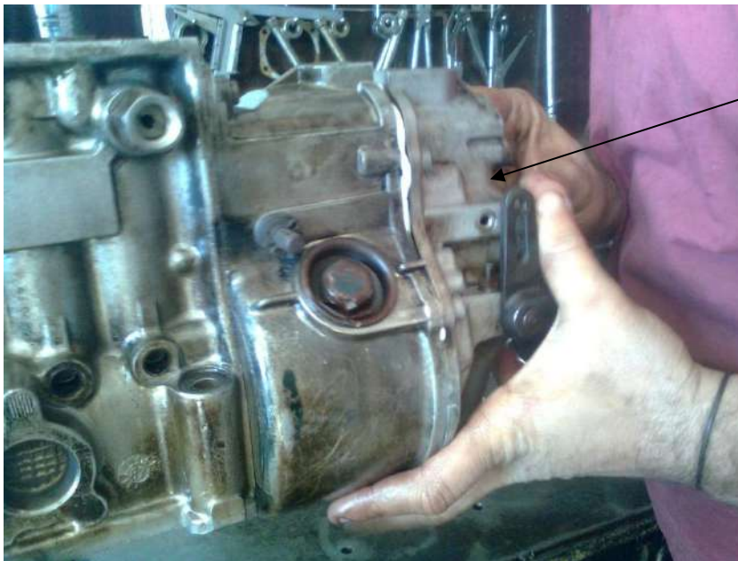
شكل (148-1) تركيب مجموعة الحاكم الميكانيكي
