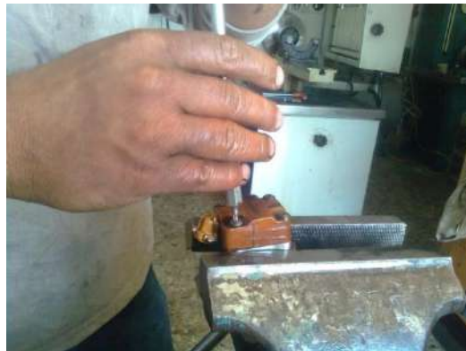
شكل (168-1) براغي تثبيت الملف الكهربائي على الحاقن
