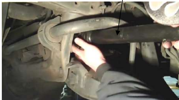
شكل ( 23-4 ) تركيب الجزء الهلالي للعدة على صامولة المفصل شكل ( 24-4 ) فتح صامولة المفصل
