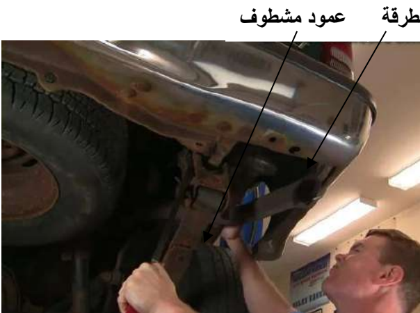
شكل ( 7-3 ) سحب اللولب بالعمود المشطوف والطرق
