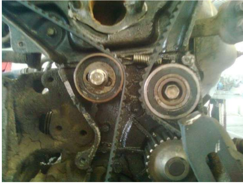
شكل (114-1) تثبيت نابض الضاغطات وشد البراغي
