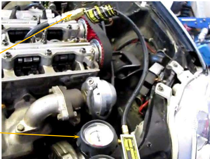
شكل ( 62-1 ) وصل الخرطوم بالمقياس
