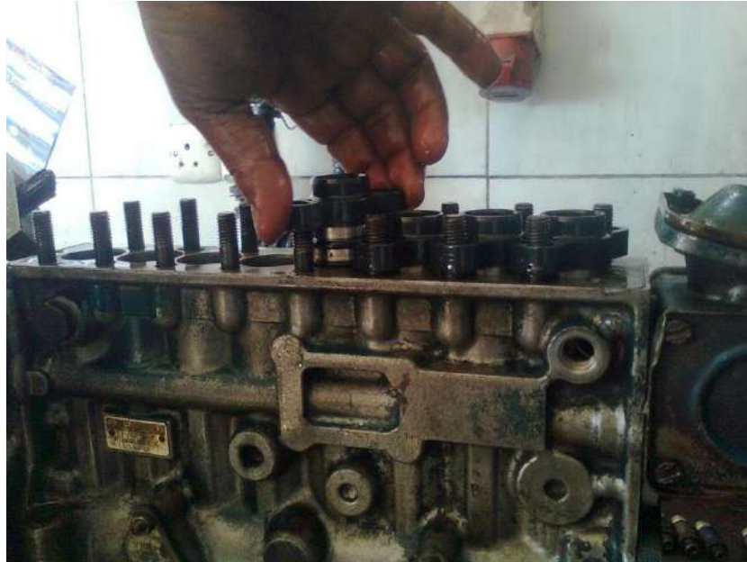
شكل (144-1) تثبيت مجموعة الكباس على جسم المضخة
