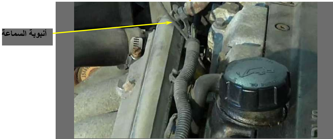
شكل (1-197) وضع أنبوبة السماعة على الحاقن(البخاخ)
