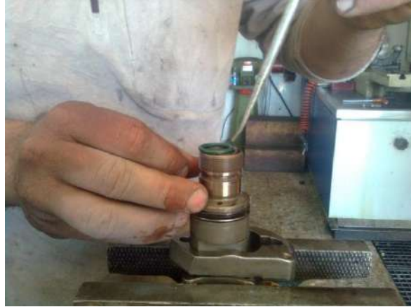
شكل (163-1) تركيب الواشر المطاطي ( مانع التسرب )
