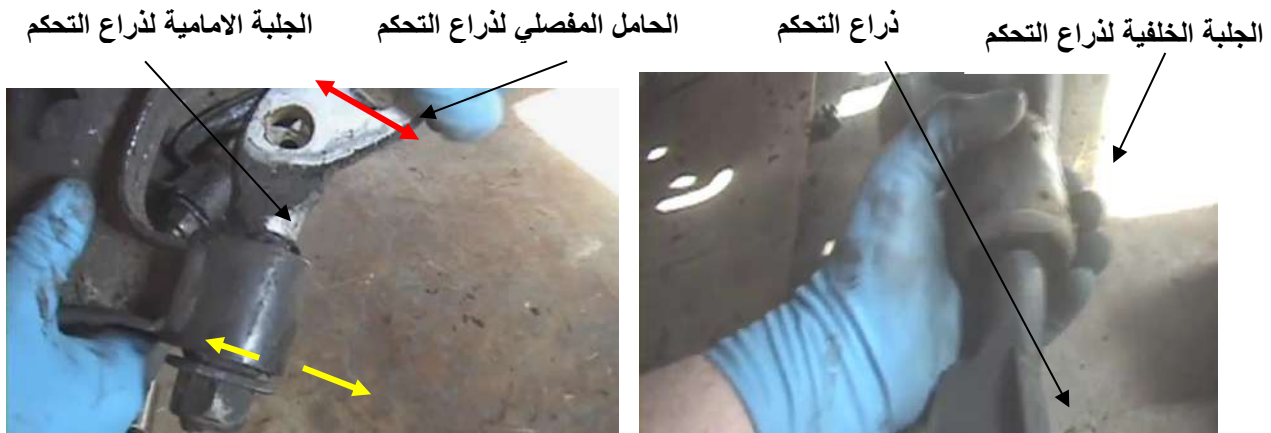
شكل (84-3) فحص الجلبة الخلفية للذراع شكل (85-3) فحص الجلبة الامامية للذراع
