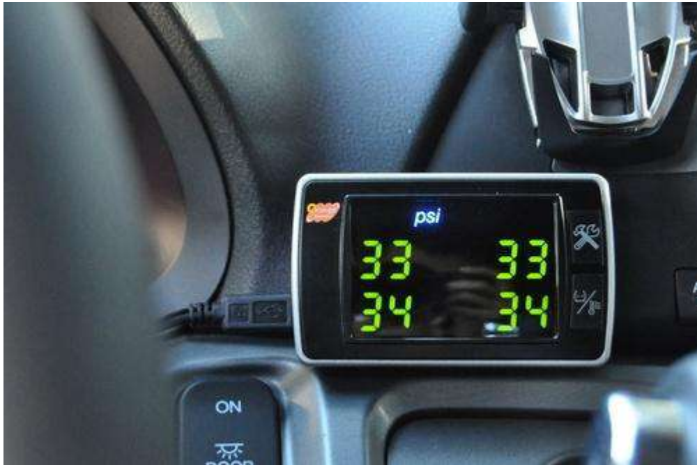
الشكل ( 5-24 ) تثبيت شاشة جهاز مراقبة ضغط الإطار ودرجة حرارته على لوحة المقاييس (الدشبول) أمام السائق
