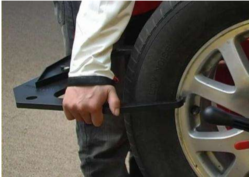
شكل (4-109) قياس عرض الاطار المعدني من الشفة الداخلية للإطار إلى الشفة الخارجية
