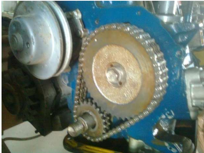
شكل (105-1) إزالة غطاء مسننات التوقيت بالسلاسل
