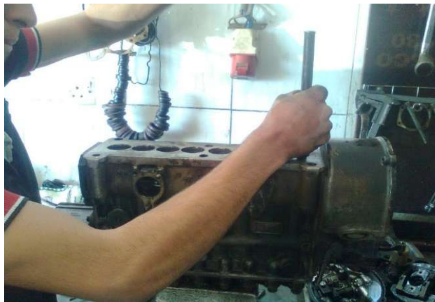
شكل (135-1) اخراج السدادات النحاسية
