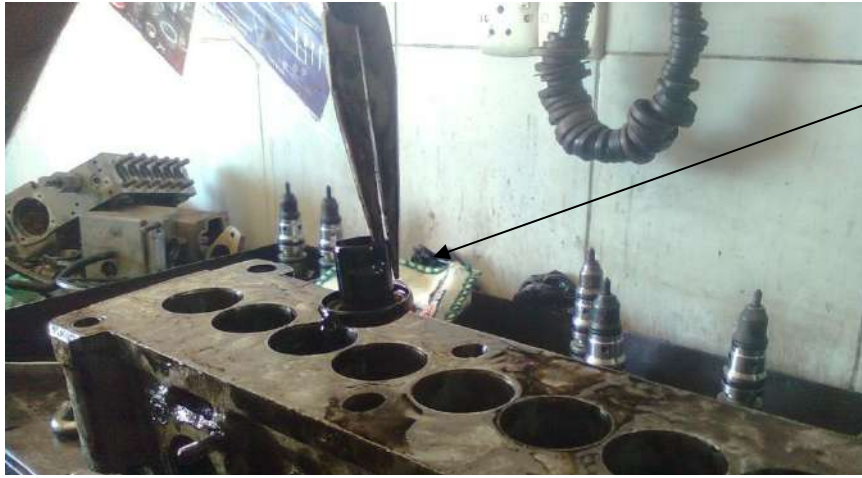
شكل (138-1) استخراج دليل الكباس
