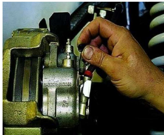
شكل (2-43) استنزاف الهواء من منظومة الموقف للعجلات الأمامية
