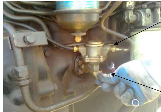
شكل (176-1) تشغيل مضخة الوقود الابتدائية يدوياً
