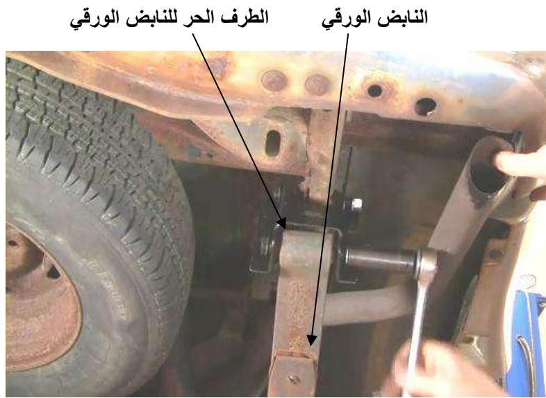
شكل ( 12-3 ) شد صامولة لولب ربط عين النابض
