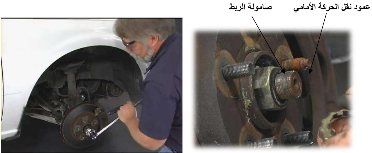
شكل (95-3) الصامولة بعد سحب مسمار القفل شكل (96-3) فتح الصامولة
