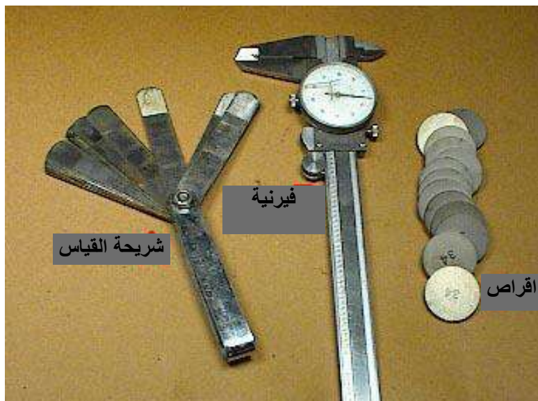
شكل (1-87) الأدوات المستعملة لضبط الخلوص
