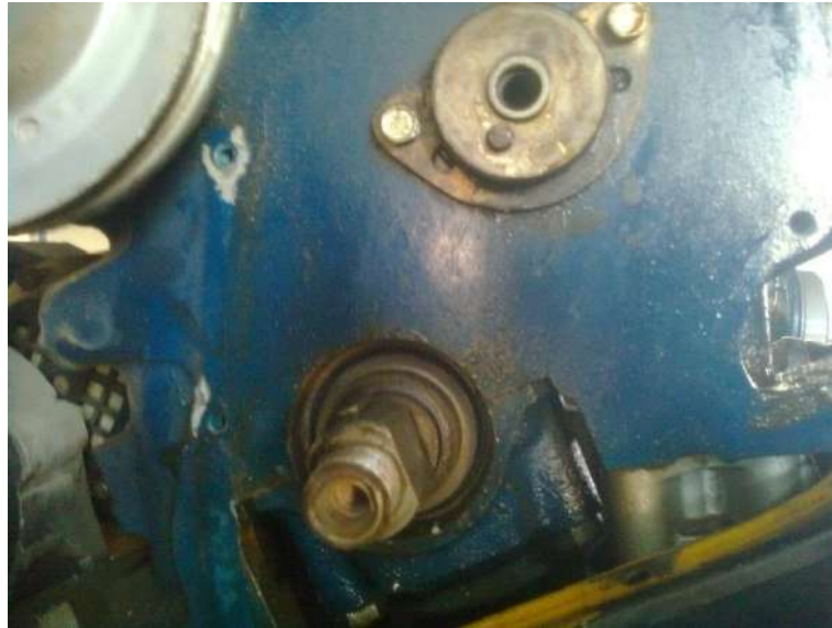
شكل (107-1) رأس المحور القلاب عندما يكون المكبس رقم (1) في ن.م.ع
