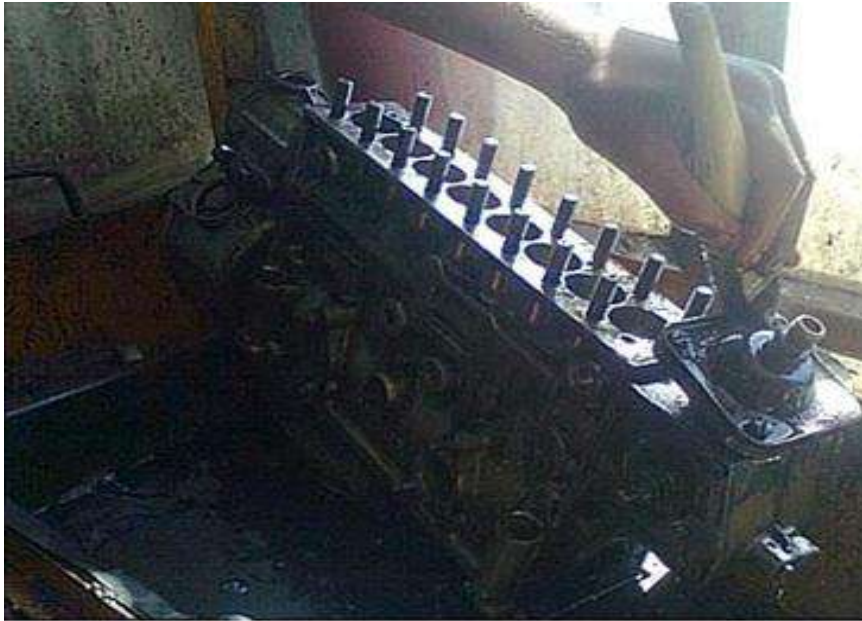
شكل (1-142) تنظيف جسم مضخة الحقن
