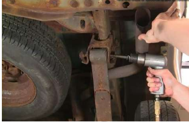
شكل ( 8-3 ) دفع اللولب بمطرقة تعمل بالهواء المضغوط
