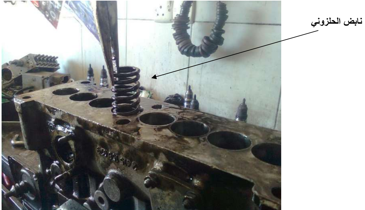
شكل (1-145) تركيب نابض الكباس في جسم المضخة
