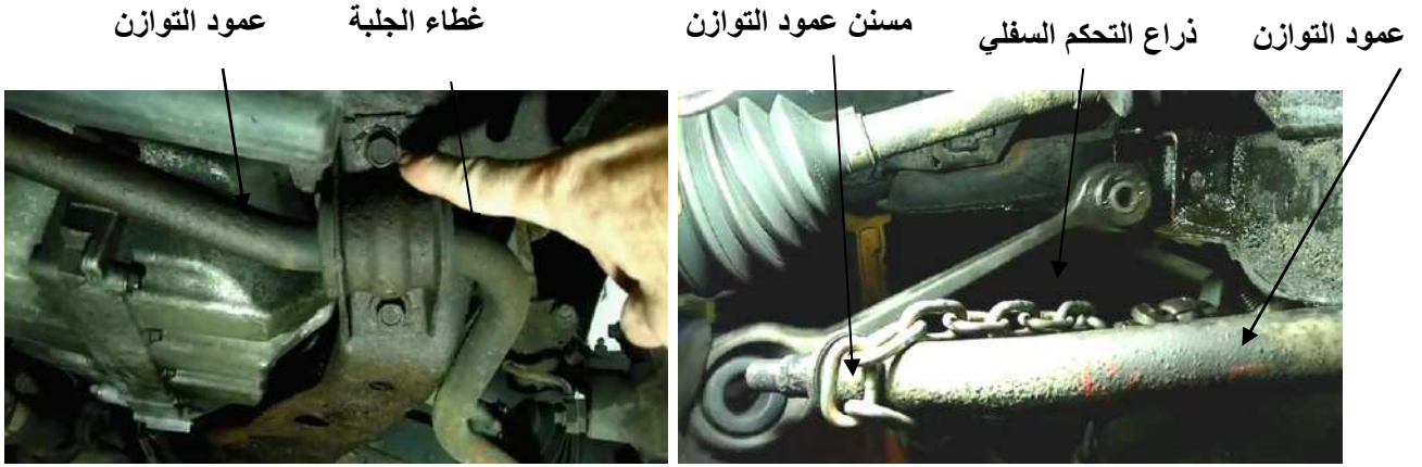
شكل ( 3-41 ) انزع ذراع التحكم السفلي من مكانه شكل ( 3-42 ) براغي غطاء الجلبة المطاطية
