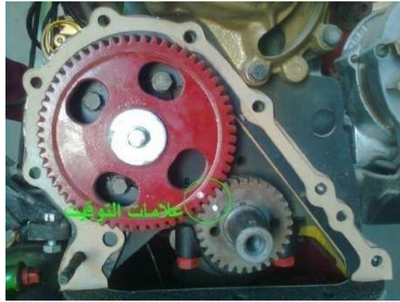
شكل (1-102) تعشيق المسننين عند تقابل العلامات
