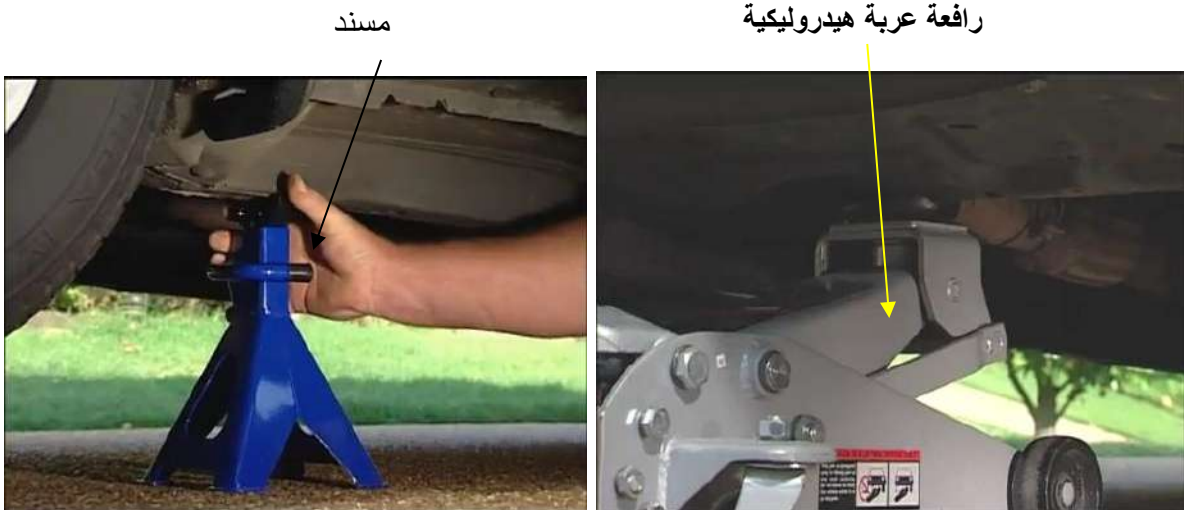
شكل (3-92) وضع المسند تحت السيارة
