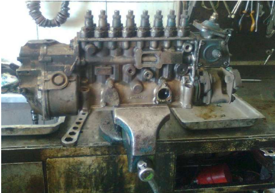
شكل (127-1) تهيئة مضخة الحقن على منضدة العمل
