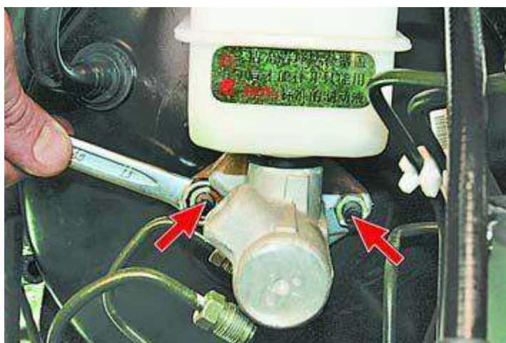
شكل (10-2) فتح صواميل تثبيت الاسطوانة الرئيسية للموقف في جسم الموقف المساعد
