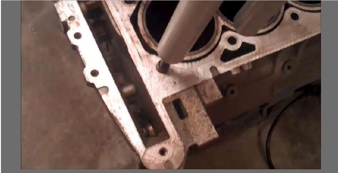
شكل (31-1) تثبيت برغي التثبيت على كتلة الاسطوانات
