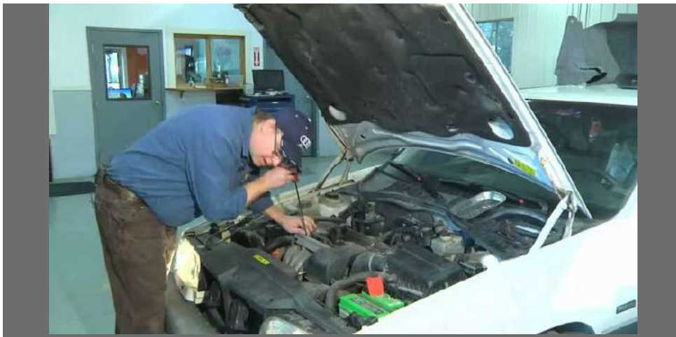
شكل (201-1) سماع صوت عمل الحاقن
