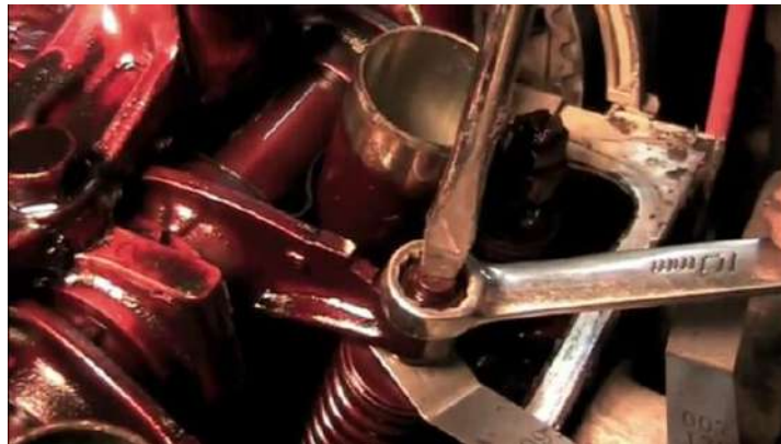
شكل (84-1) تدوير لولب الصمام مع تثبيت الصامولة ووضع شريحة القياس للتعبير
