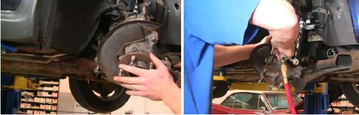
شكل (3-58) تحريك سرّة العجلة بالمطرقة الهوائية شكل (3-59) إخراج سرّة العجلة من مكانها
