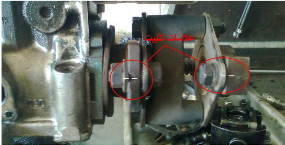
شكل (132-1) تأشير وصلة تدوير مضخة الحقن (الكوبلن)
