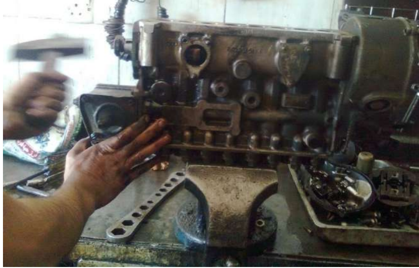
شكل (134-1) اخراج عمود الحدبات بواسطة الطرق على نهايته
