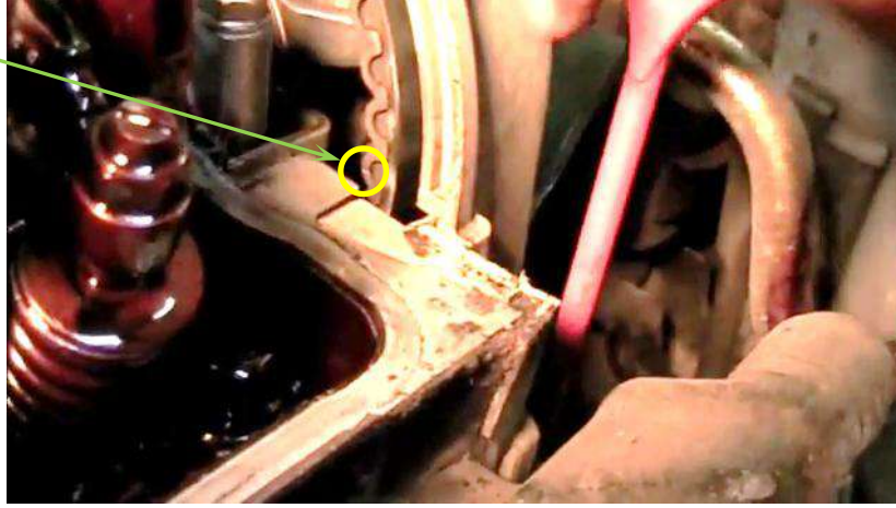
شكل (1-80) وجود علامة على بكرة عمود الكامات لتحديد النقطة الميتة العليا
