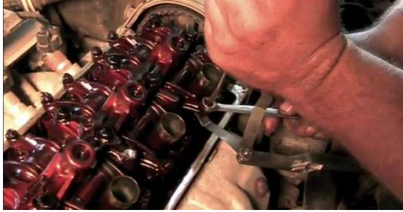
شكل (85-1) تدوير صامولة الصمام مع تثبيت الصامولة ووضع شريحة القياس لغرض المعايرة
