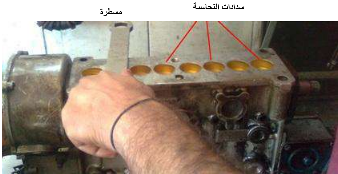
شكل (1-150) استخدام المسطرة في تثبيت السدادات النحاسية
