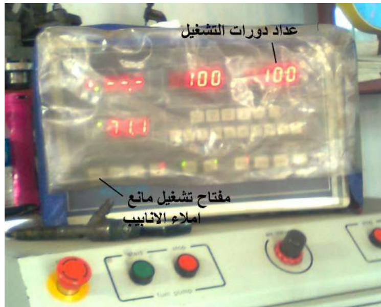
شكل (172-1) تشغيل جهاز الفحص على السرعة الحثائية 100 دورة\ دقيقة
