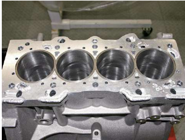
شكل (1-26) محرك ذو اسطوانات مصبوبة بشكل مفرد
