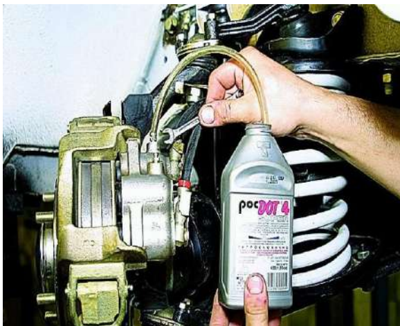
شكل (2-43) استنزاف الهواء من منظومة الموقف للعجلات الأمامية
