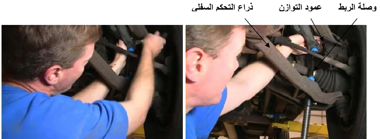
شكل ( 33-3 ) إدخال صامولة برغي ربط الوصلة شكل ( 34-3 ) شد الصامولة بوساطة بالمفتاح
