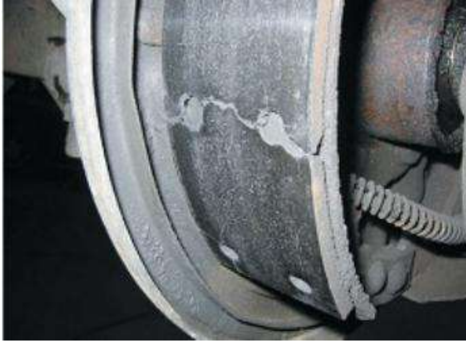
شكل (2-34) تآكل بطانة الاحتكاك لموقف الهلالي
