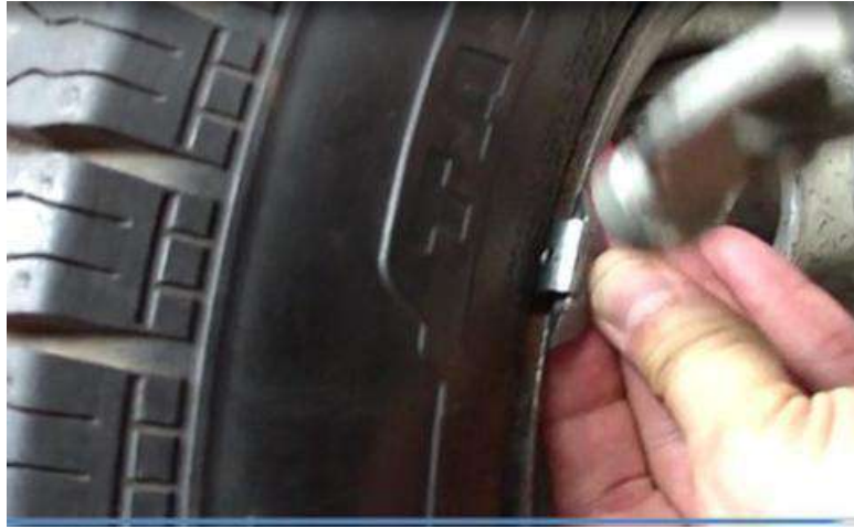
شكل (4-112) تثبيت الرصاص بطرق حسب القيمة المعطاة
