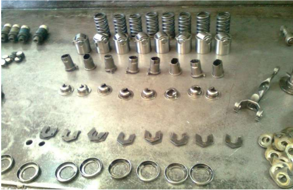
شكل (140-1) وضع الأجزاء بالترتيب بعد غسلها
