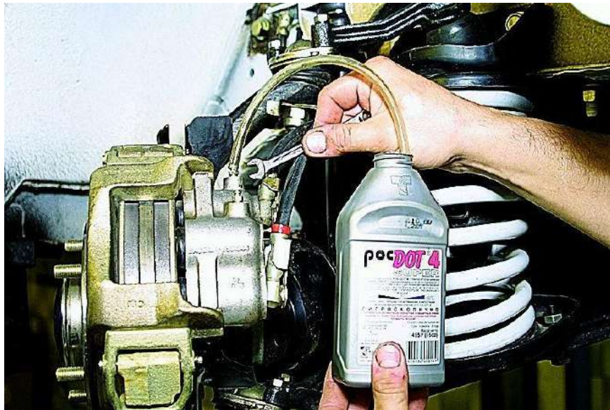
شكل (2-36) تركيب الأنبوب المطاطي على لولب التنفيس
