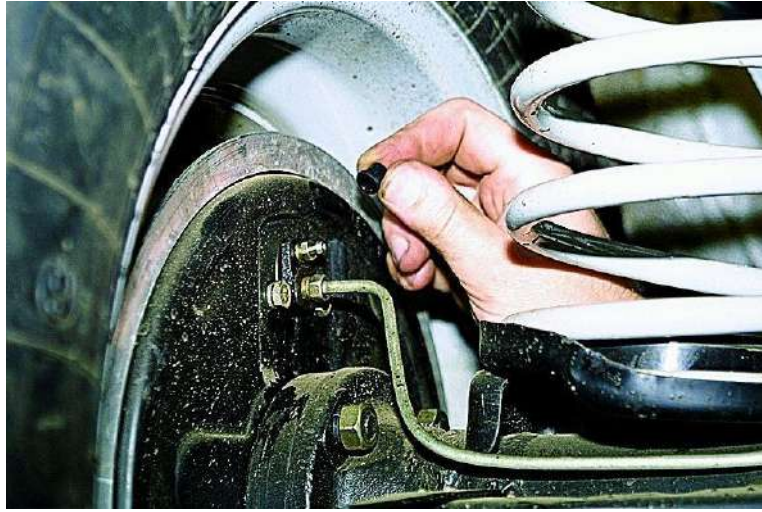
شكل (2-35) فتح الغطاء المطاطي للولب التنفيس
