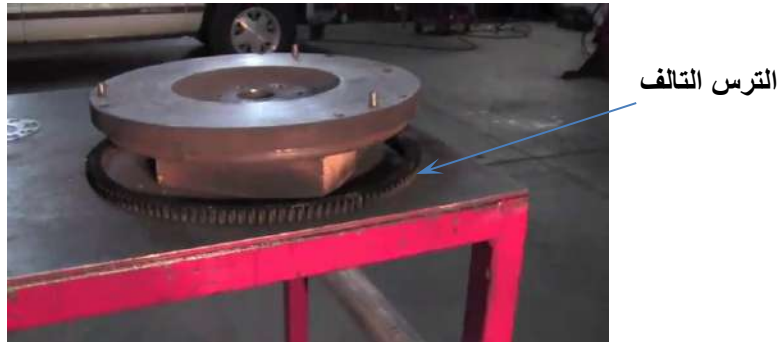
شكل (70-1) فصل الترس عن الحذافة
