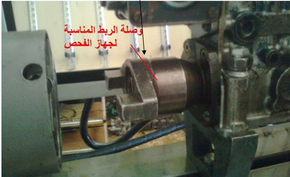
شكل (152-1) تركيب وصلة الربط المناسبة لجهاز الفحص
