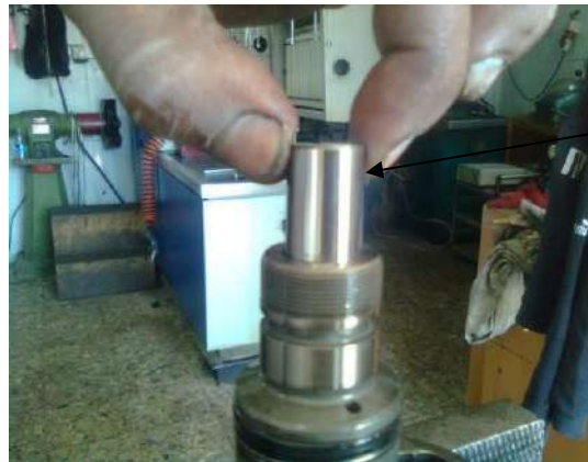
شكل (164-1) تركيب المكبس في جسم الحاقن
