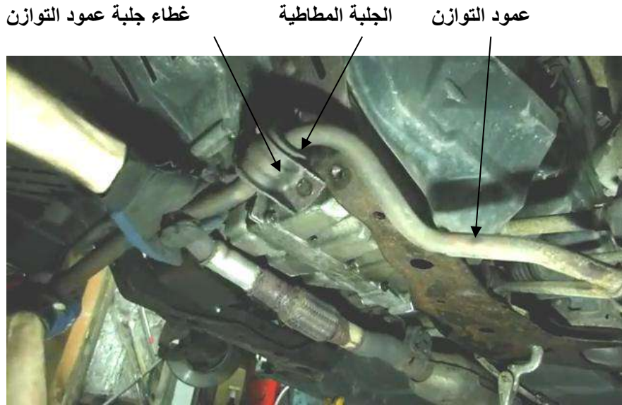
شكل ( 3-43 ) نزع عمود التوازن من مكانه
