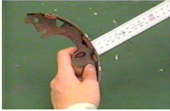
شكل (2-31) قياس بطانة الاحتكاك لحذاء الموقف
