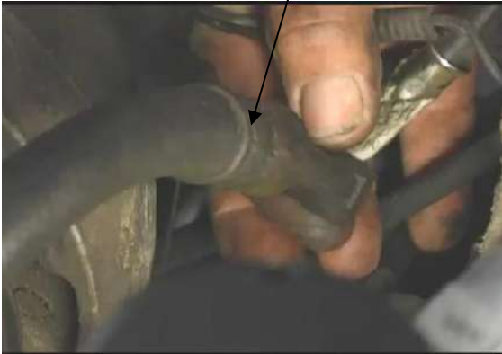
شكل (64-4) فك خرطوم الزيت من المضخة
