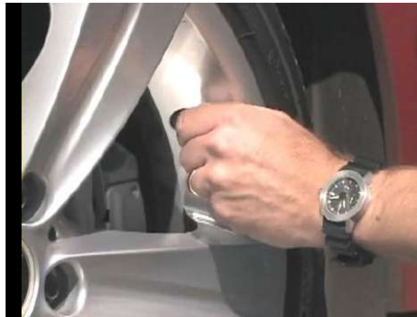
شكل (8-5) فك غطاء صمام الهواء.
