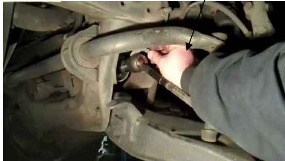
شكل ( 23-4 ) تركيب الجزء الهلالي للعدة على صامولة المفصل شكل ( 24-4 ) فتح صامولة المفصل
