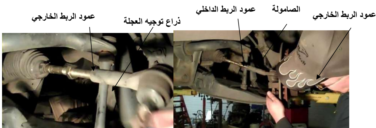
شكل ( 28-4 ) تركيب عمود الربط الخارجي شكل (29-4) شد الصامولة
