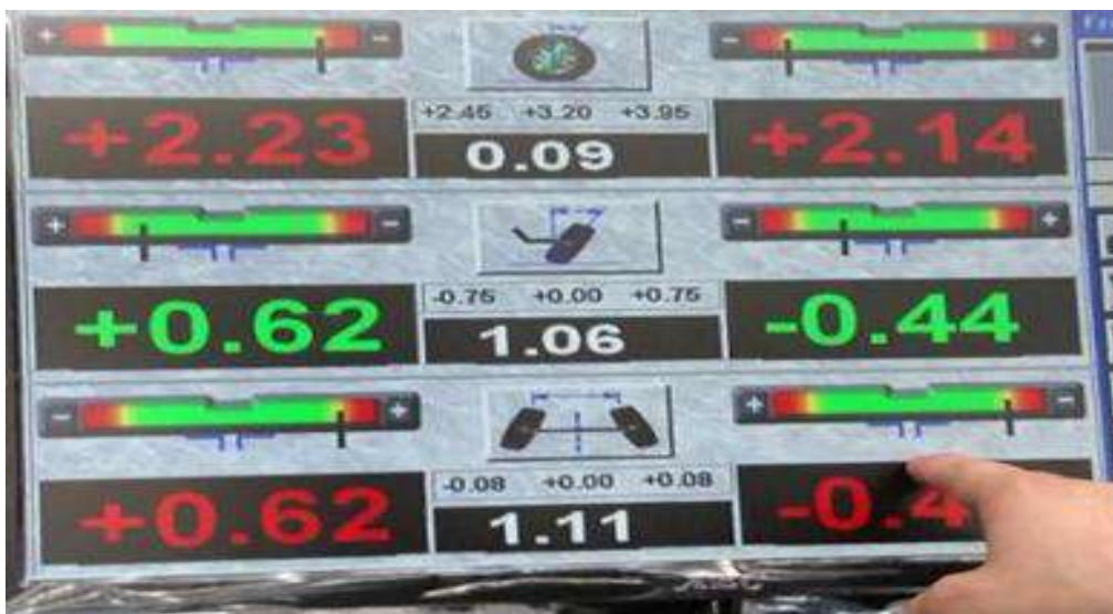
شكل (101-4) تحدد نوع الزاوية لعمل الصيانة
