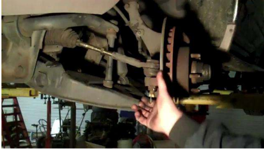
شكل ( 30-4 ) إدخال المسمار المفلوق
