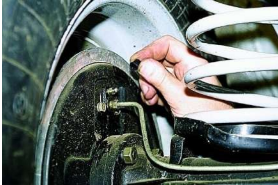
شكل (2-41) تركيب الغطاء المطاطي للولب التنفيس
