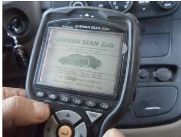
شكل (2-49) وضع مفتاح تشغيل جهاز الفحص على ON
