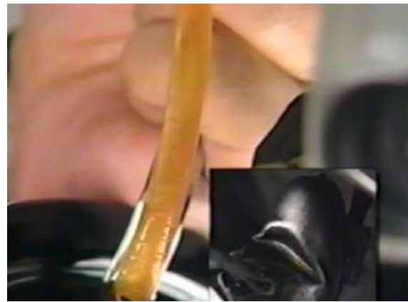
شكل (39-2) خروج الزيت من غير فقاعة هوائية
