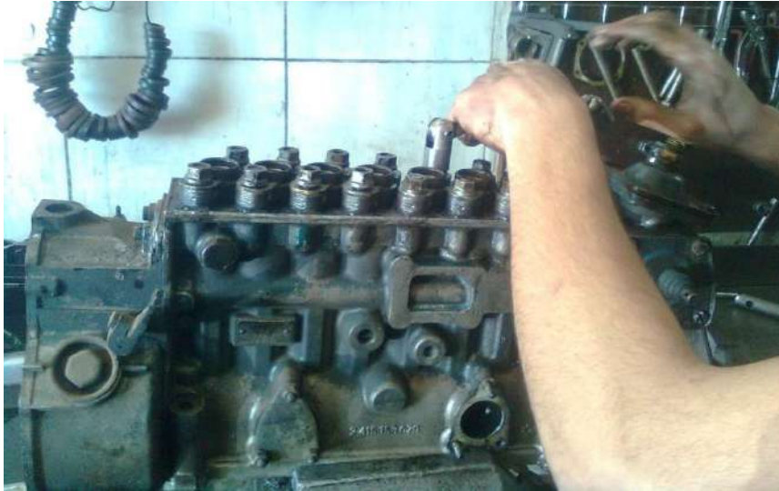
شكل (1-130) تعليق الكباس
