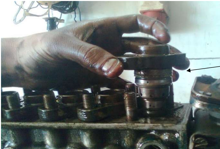
شكل (139-1) استخراج مجموعة الكباس
