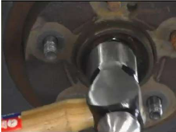
شكل (104-3) دفع العمود عن حامل العجلة بالطرق
