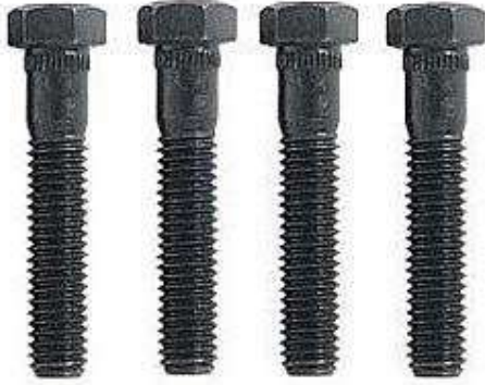
شكل (3-80) لوالب الربط القصيرة التي تربط الوصلة المفصلية لذراع التحكم
