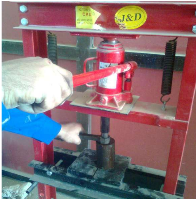
شكل (24-1) الضغط على الجلبة الجديدة بالتدريج لتركيبها على ذراع التوصيل
