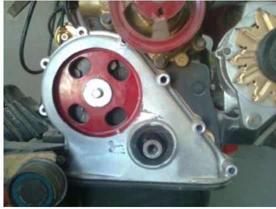
شكل (100-1) غطاء مسننات التوقيت بعد ازالة البراغي
