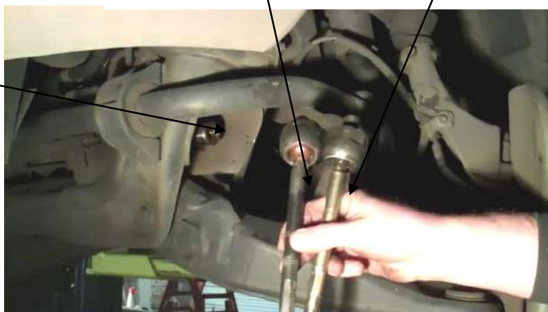
شكل ( 25-4 ) نزع عمود الربط من مكانه وإحضار عمود ربط جديد
