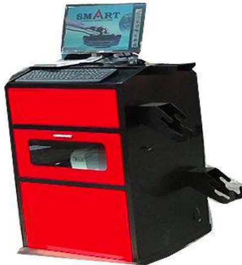
شكل (4-94) تشغيل جهاز ضبط ميزانية المركبة
