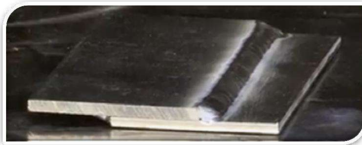
شكل 1-5 وصلة لحام تراكبية لقطعتي ألمنيوم
