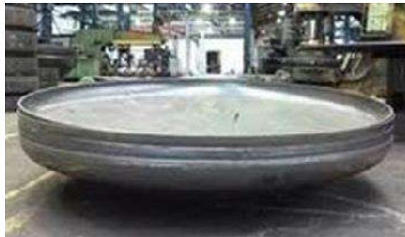
شكل 5-11 الصفائح الطرفيتين (End Plates) أو الصحنان (Dishes)
