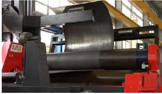
شكل 5-12 ماكينة الدرفلة لتشكيل قشرة الخزان الأسطوانية (Shell)
