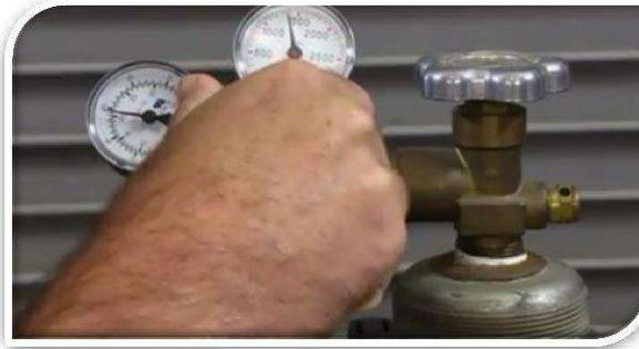
شكل 2- 13 إغلاق صمام أسطوانة الغاز ومنظم تدفق الغاز
