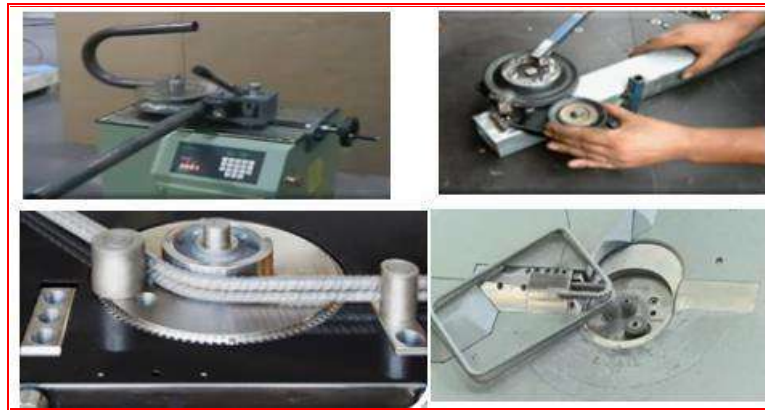
شكل 5-8 بعض المكائن والأدوات المستخدمة في عملية الحنى للمشغولات
