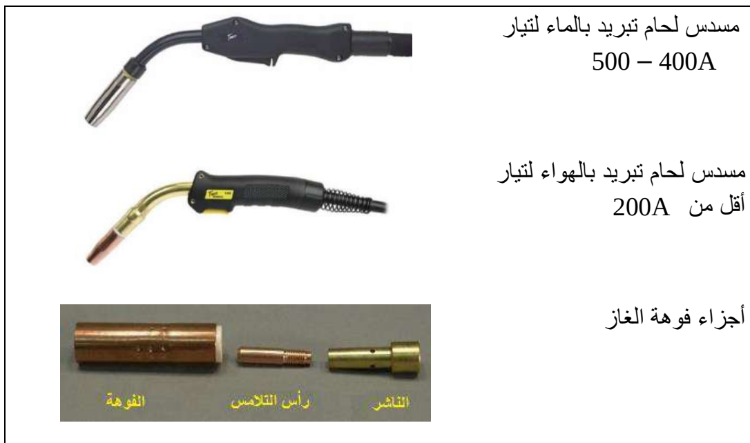
شكل 2-5 مسدس اللحام وأجزاء فوهة الغاز
