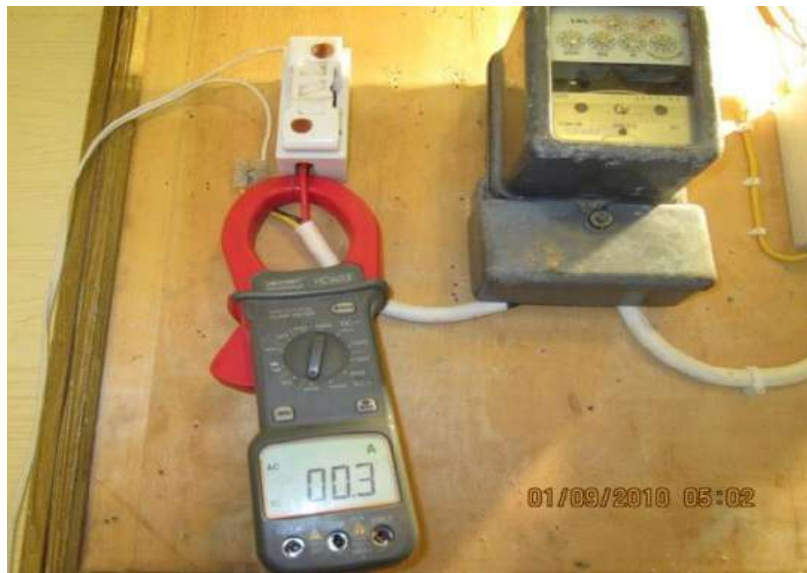
الشكل (6-55) قياس قيمة التيار المسحوب لحمل (مصباح) بواسطة الكلامبيتر
