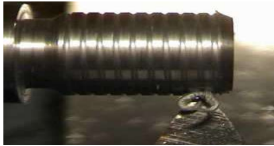
الشكل ( 24 - 6 ) عملية قطع السن في قطعة العمل
