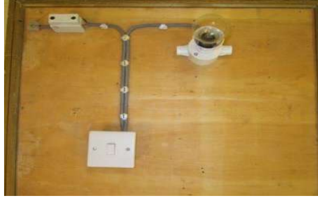
الشكل (6-19) ربط الكيبلات الممددة الى العناصر الكهربائية بحسب المخطط
