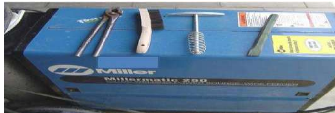
الشكل (1-16) يوضح العمل الخطأ بوضع العدد على الماكينة
