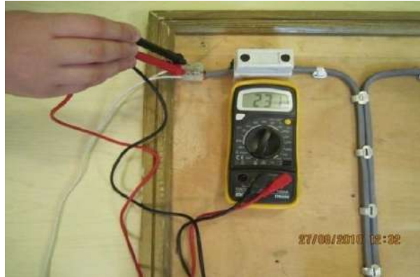
الشكل (6-20) قياس جهد المصدر المغذي بواسطة جهاز AVO
