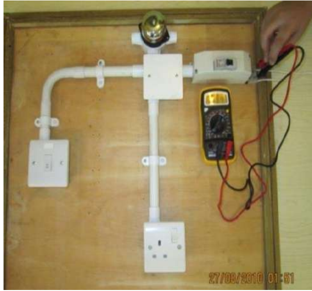
الشكل (6-44) قياس قيمة جهد مصدر التغذية بواسطة AVO
