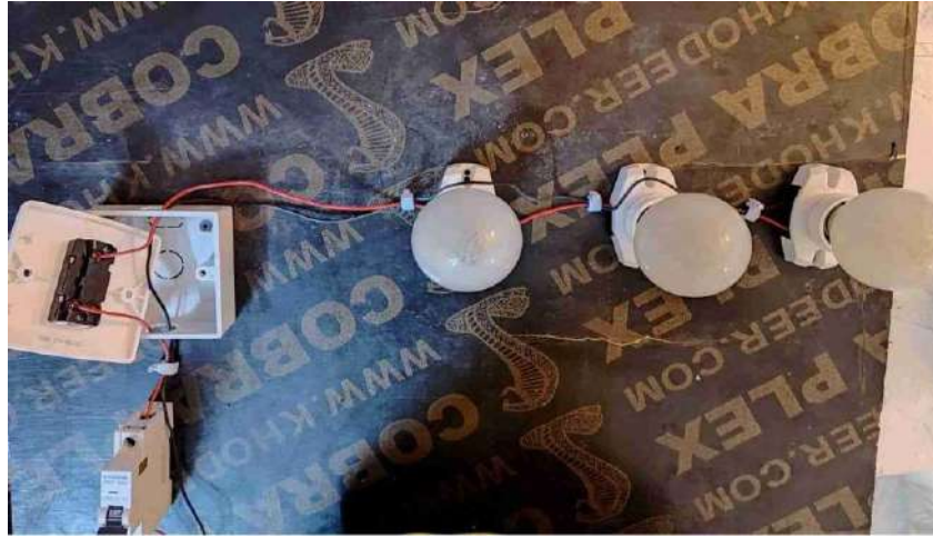
الشكل (3-8) ربط الاسلاك بقطع التمرين في حالة ربط التوالي
