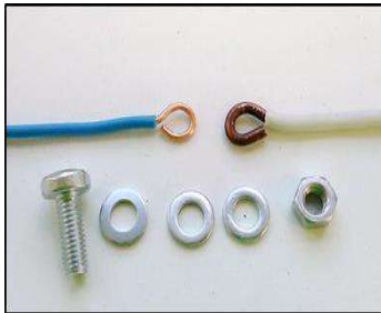
الشكل (1-36) طريقة حني نهاية السلك الشكل (1-37) حلقات اطراف الاسلاك وأدخال لولب في الحلقة
