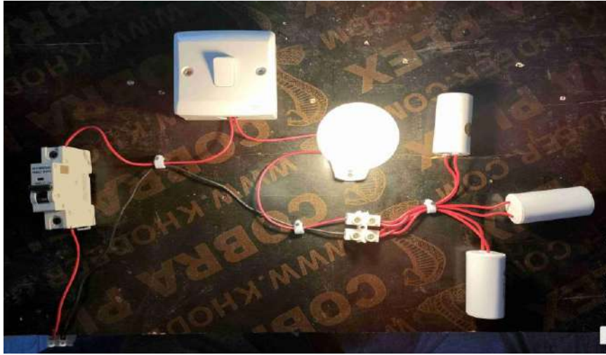
الشكل (5-35) شحن المتسعات في حالة التيار المتناوب
