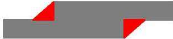
الشكل ( 5 - 6 ) لحام القطع المترابكة
