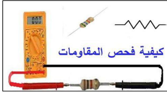
الشكل (2-20) استخدام الافوميتر لفحص المقاومات
