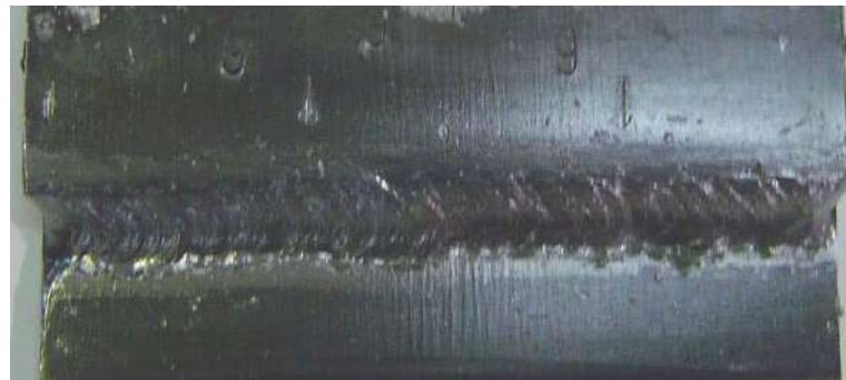
الشكل ( 5 - 12 ) يوضح لحام القطع المتراكبة
