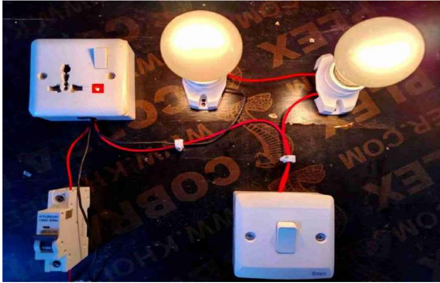
الشكل (25-6) فحص عمل التمرين لدائرة التوالي
