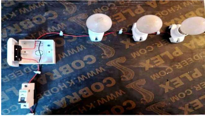
الشكل (3-13) ربط الاسلاك بقطع التمرين في حالة ربط التوازي
