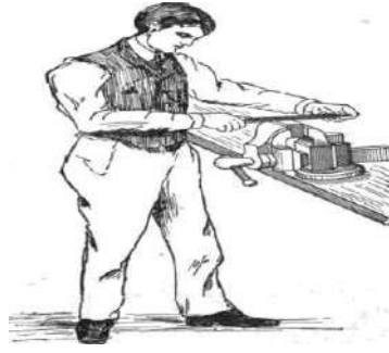
الشكل ( 6 - 2 ) الوقوف الصحيح أثناء عملية البرادة
