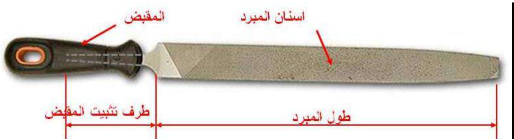
الشكل ( 1 - 2 ) يوضح أجزاء المبرد
