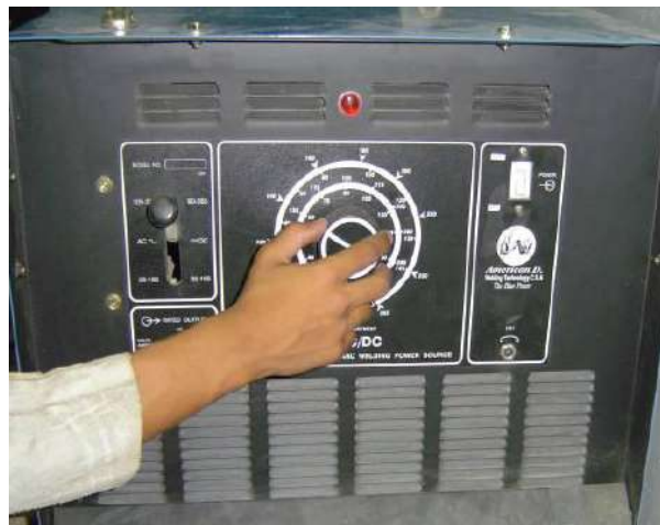
الشكل ( 4 - 5 ) ضبط قيمة التيار بماكنة اللحام
