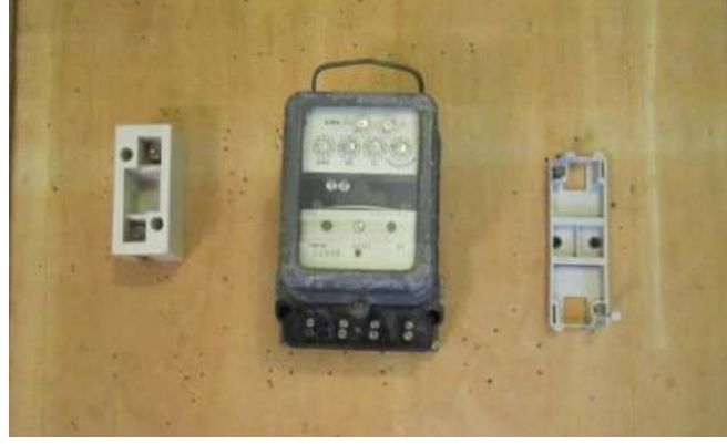
الشكل (6-52) تثبيت عداد الساعة 1Ph وقاعدة المصهر وغلاف القاطع على اللوحة
