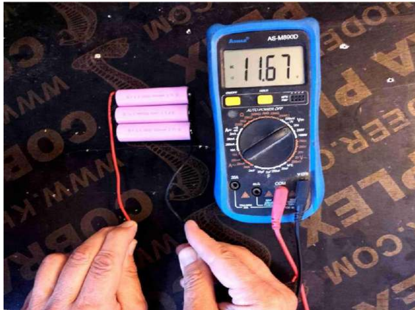
الشكل (4-13) قياس جهد البطارية الكلية في حالة ربط التوالي
