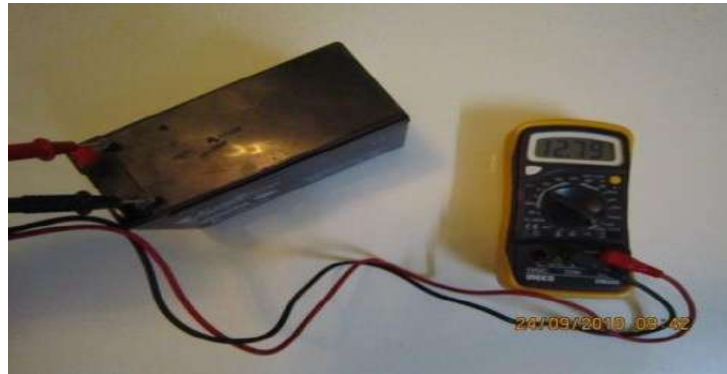
الشكل (4-9) قياس جهد البطارية الجافة 12V/7Ah
