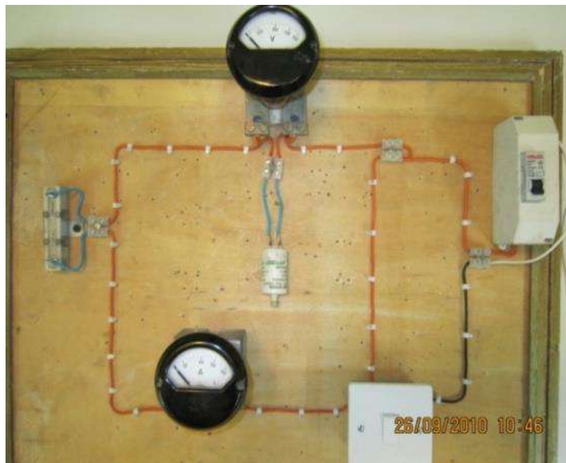
الشكل (5-31) توصيل متسعة قيمتها 1.5Mf/400v في دائرة الشحن والتفريغ
