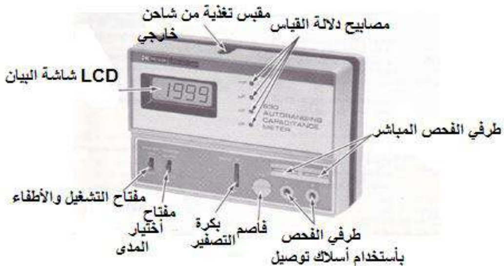
الشكل (18-5) جهاز قياس السعة الرقمي واسع المدى المستقل
