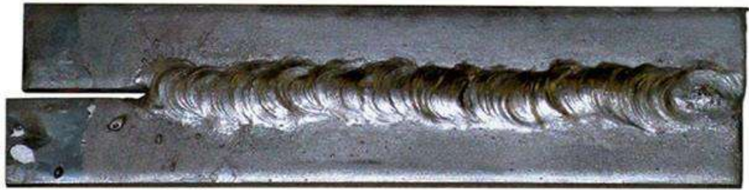
الشكل ( 5 - 11 ) عملية لحام قطعتين متقابلتين
