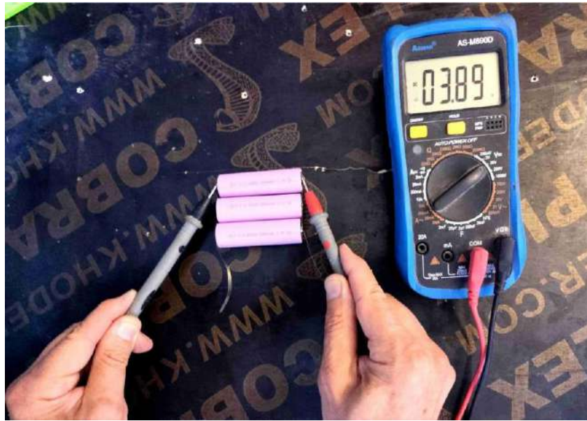
الشكل (4-17) قياس جهد كل بطارية
