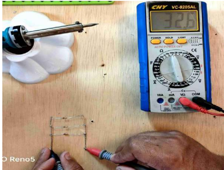
الشكل (3-16) قياس قيمة المقاومة الكلية في حالة ربط التوازي
