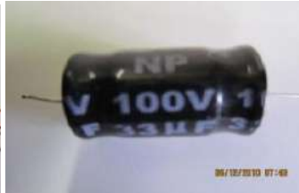
الشكل (5-6) الشكل المتسعة غير المستقطبة الالكتروليتيّة
