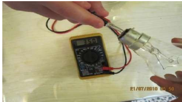
الشكل (2-22) استخدام الافوميتر لفحص صلاحية المصباح
