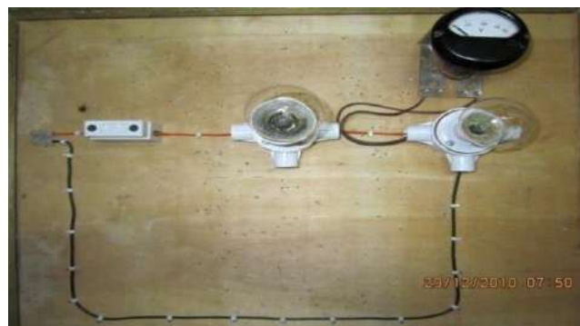
الشكل (2-18) توصيل الأسلاك الى هولدر المصباحين وقاعدة المصهر والكونكتر والمقياس
