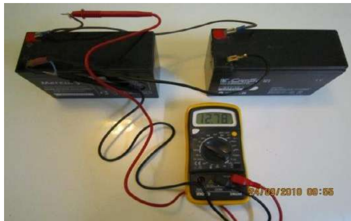
الشكل ( 4- 16 ) قياس جهد بطاريتين جافتين على التوازي
