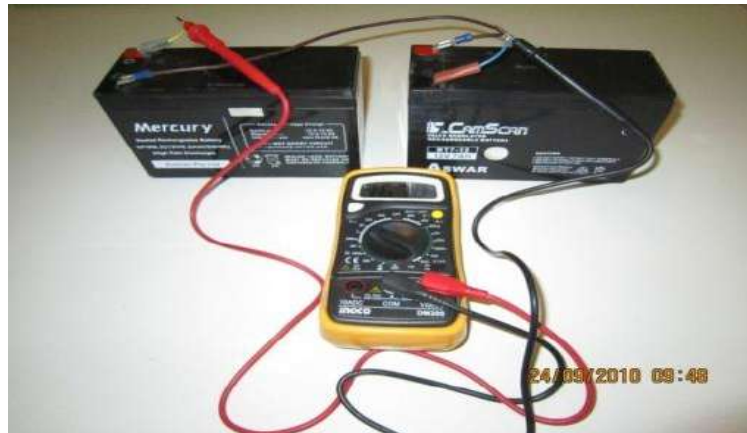
الشكل (4-11) قياس جهد البطاريتين الجافتين الموصلتين على التوالي
