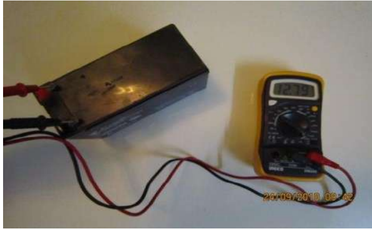
الشكل (4-14) قياس جهد البطارية الجافة 12V/7Ah
