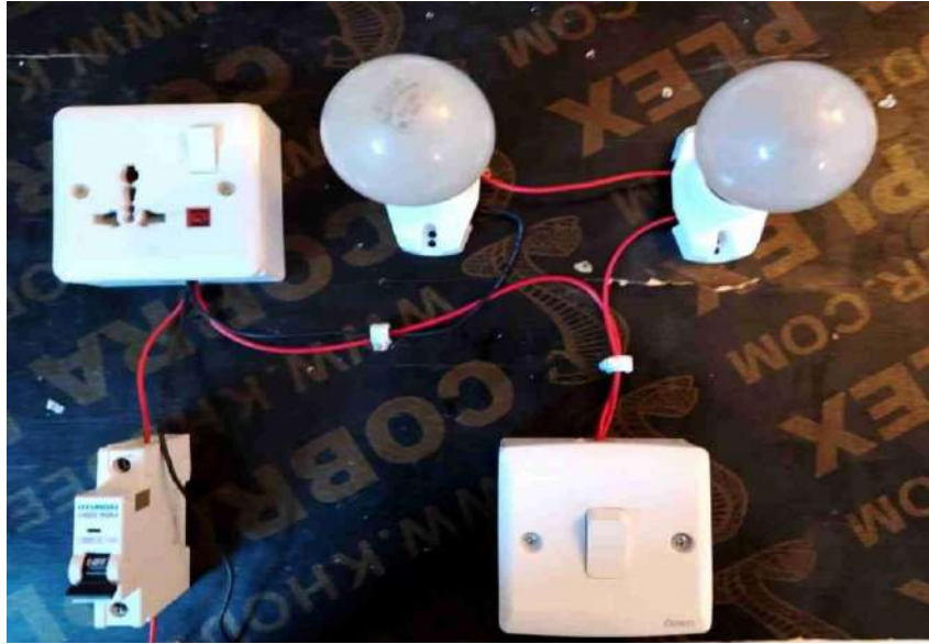
الشكل (6-24) توصيل الاسلاك بمواد التمارين
