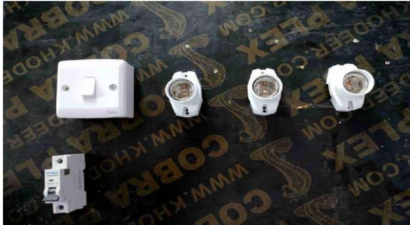
الشكل (3-7) تثبيت قطع التمرين في حالة ربط التوالي
