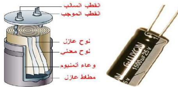
الشكل (5-2) تركيب المتسعة الكتروليتية (المستقطبة) وأشكالها
