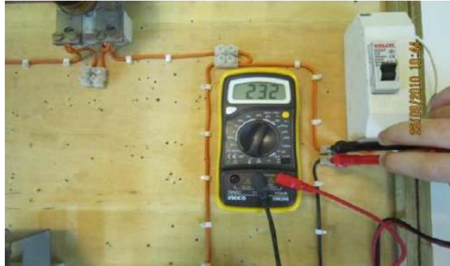
الشكل (5-30) قياس قيمة جهد المصدر المتناوب المغذي 220v/50Hz
