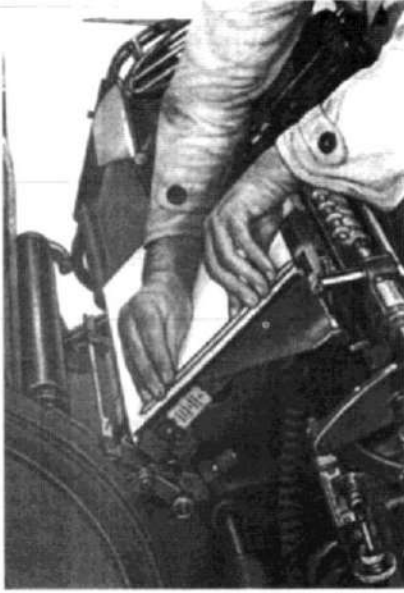
الشكل (18) شد الحشو للجهة اليسرى للوحة الكبس
