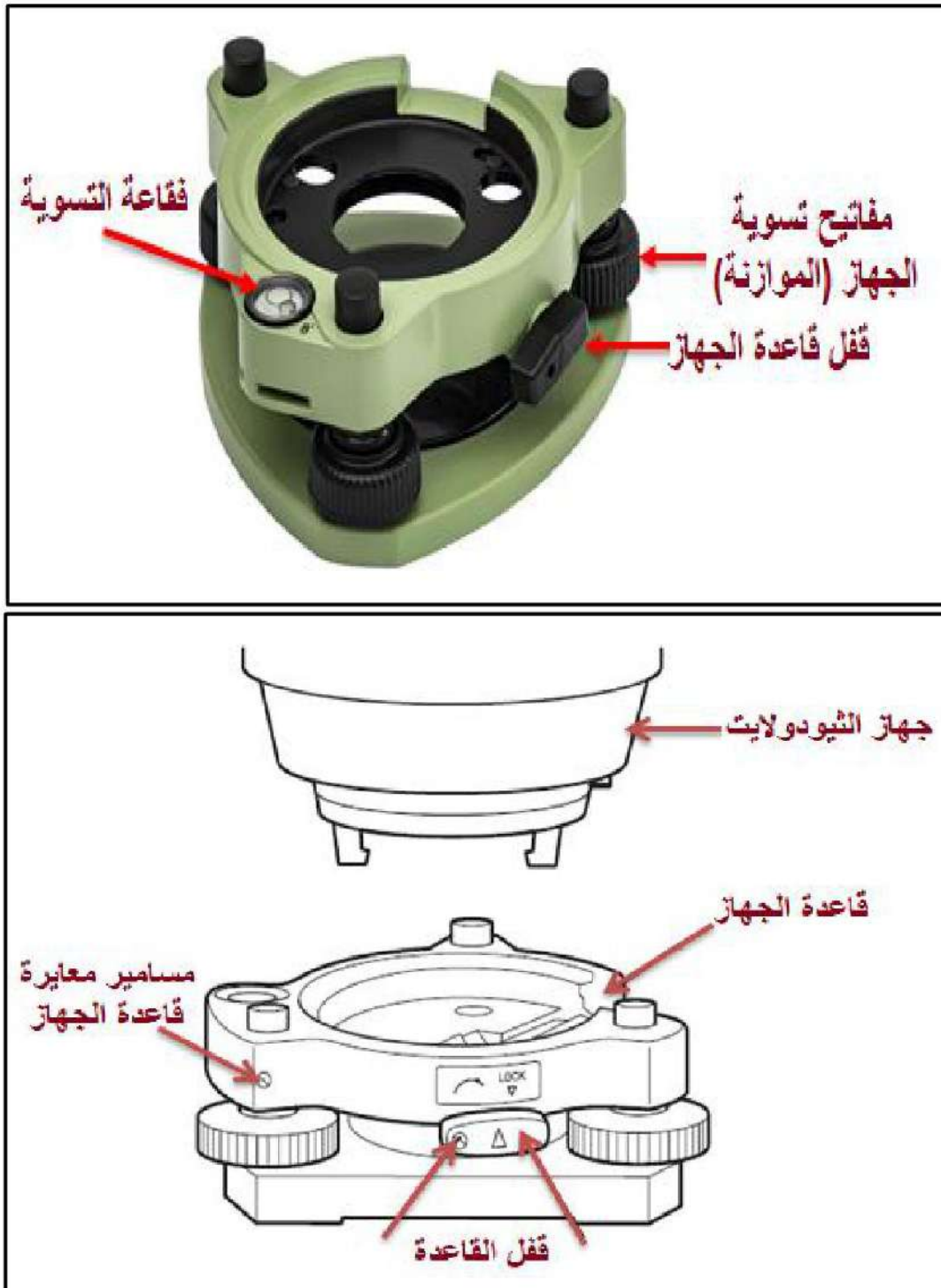
الشكل (6 - 11) قاعدة الجهاز (الترايبرخ)
