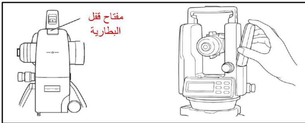
الشكل (6 - 26) تركيب بطارية الجهاز
