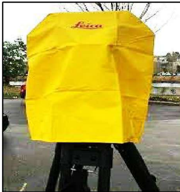
الشكل (2-4) يوضح كيفية استخدام واقى المطر لأجهزة المساحة
