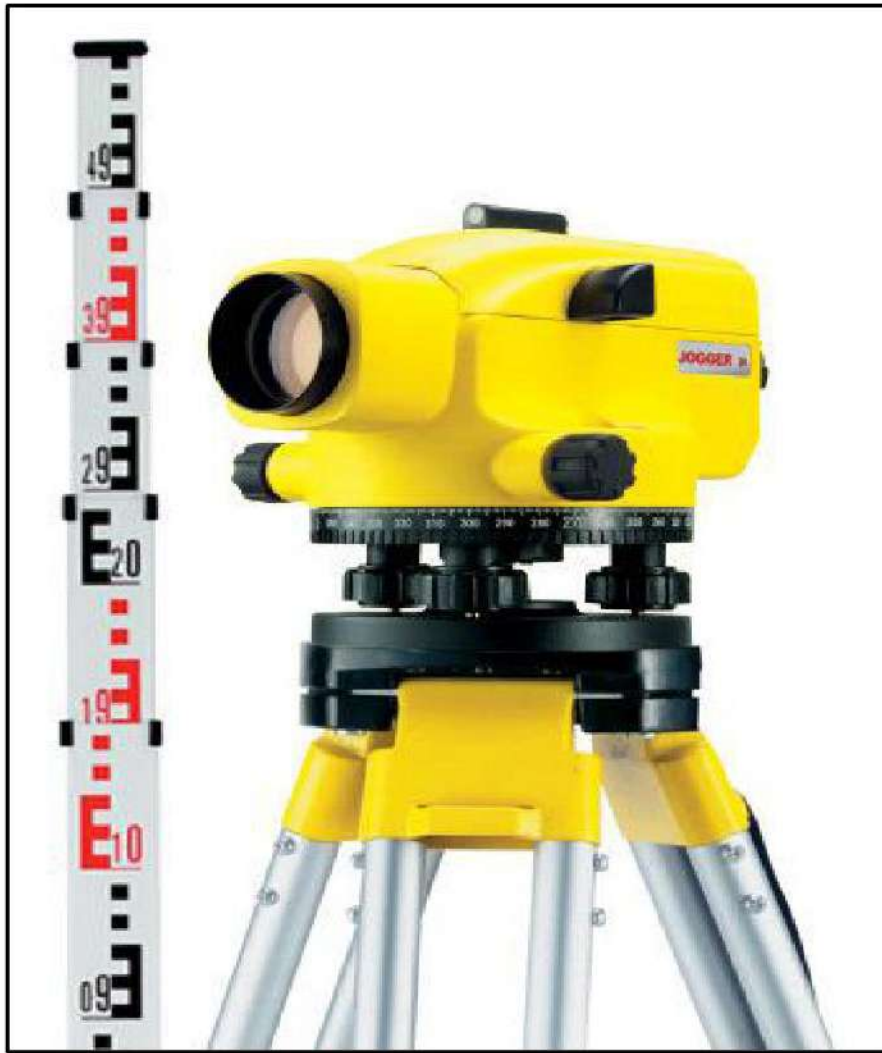
الشكل (1-5) جهاز الميزان أو جهاز التسوية (Level)
