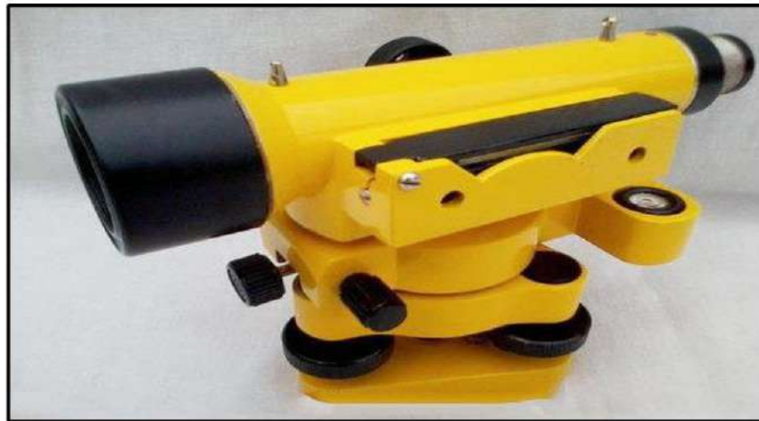
الشكل (6-5) جهاز التسوية الميال Tilting Level
