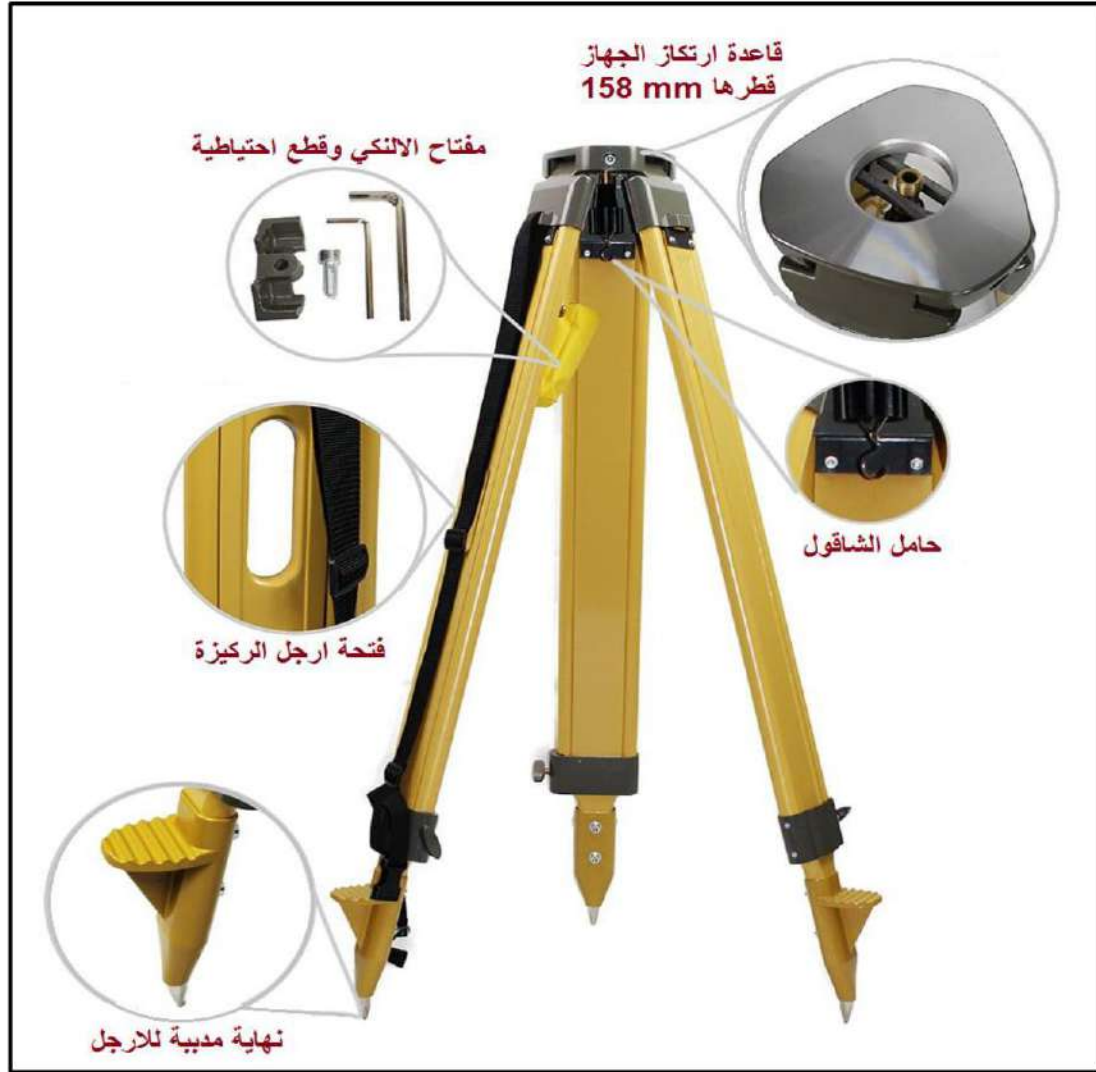
الشكل (6 - 12) اجزاء الركيزة
