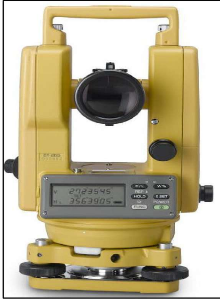
شكل (6 - 4) جهاز الثيودولايت الرقمي نوع Topcon ياباني
