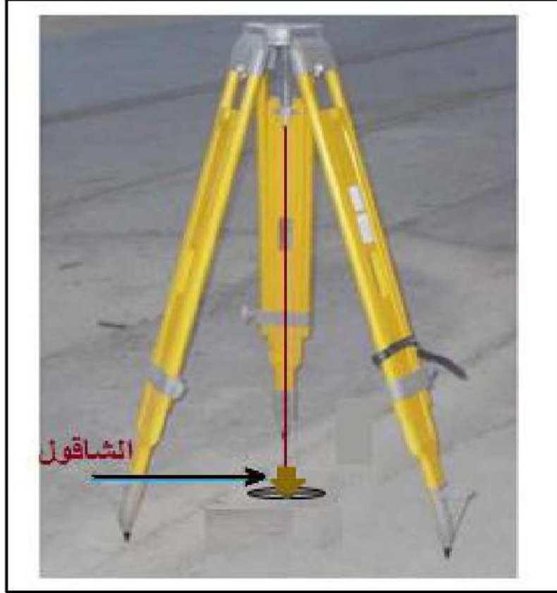
الشكل (6 - 21) نصب الركيزة على نقطة التسامت
