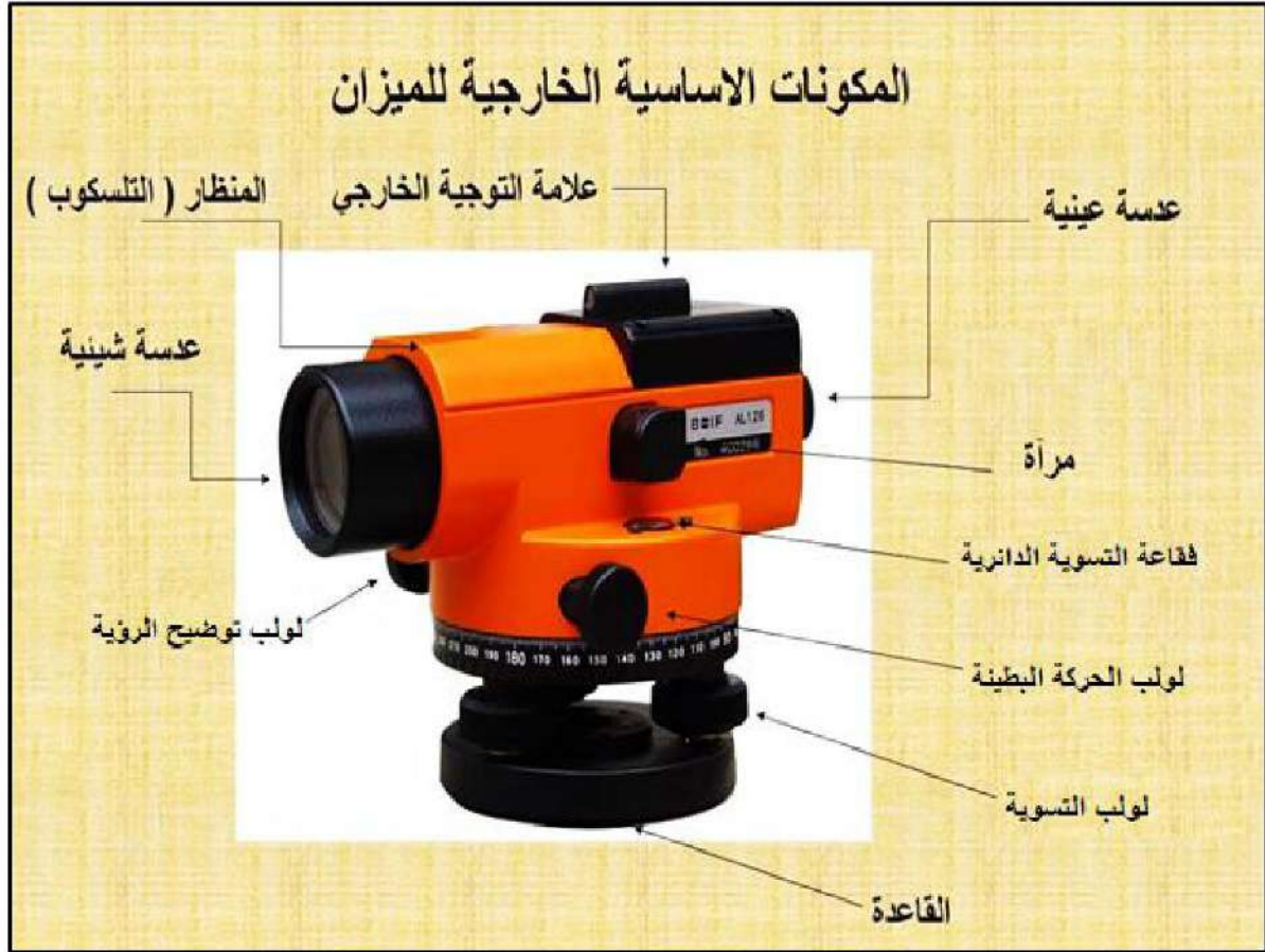
الشكل (9-5) اجزاء التلسكوب وملحقاته لجهاز الميزان
