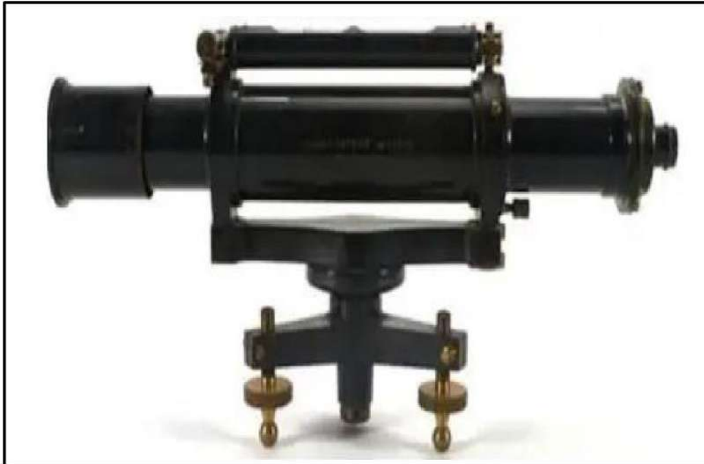
الشكل (4-5) جهاز التسوية من النوع القلاب
