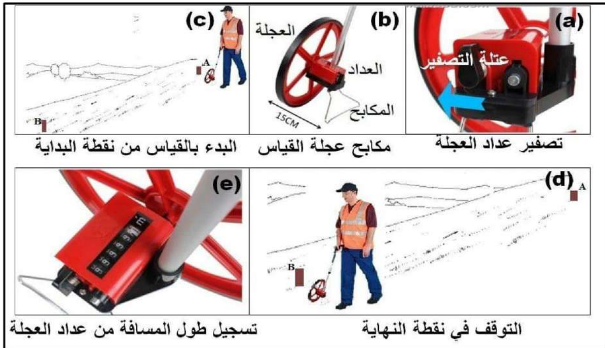
الشكل (1-25) خطوات قياس المسافة باستخدام عجلة القياس
