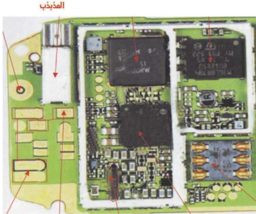
الشكل (4-12) موقع المذبذب المتعدد (نوع الكوارتز) في الهاتف الخليوي
