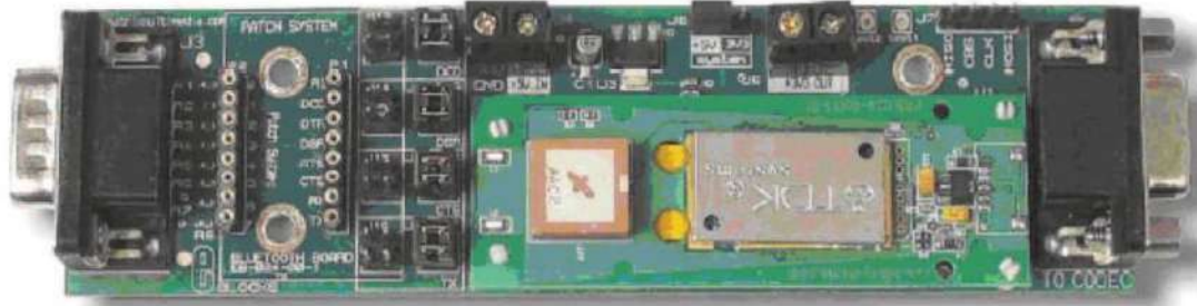
الشكل (2- 37) لوحة تدريبية للإرسال والاستلام باستخدام البلوتوث
