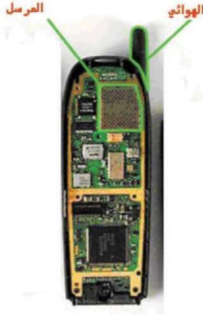
الشكل (1 - 4) اللوحة المطبوعة لأحد أنواع الهواتف الخليوية
