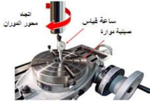
الشكل (1 - 24) ضبط محور الدوران مع مركز المنضدة الدوارة
