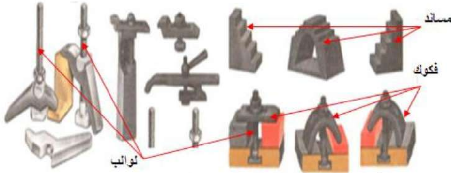
الشكل (1 - 19) أنواع الماسكات التي تستخدم في تثبيت المشغولات على المنضدة مباشرة
