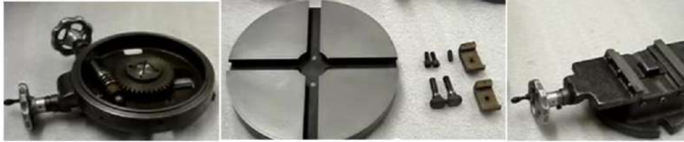
الشكل 4 - 7 مكونات المنضدة الدائرية
