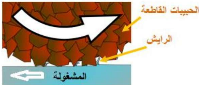
شكل 8 - 1 إزالة الرايش بحجر التجليل
