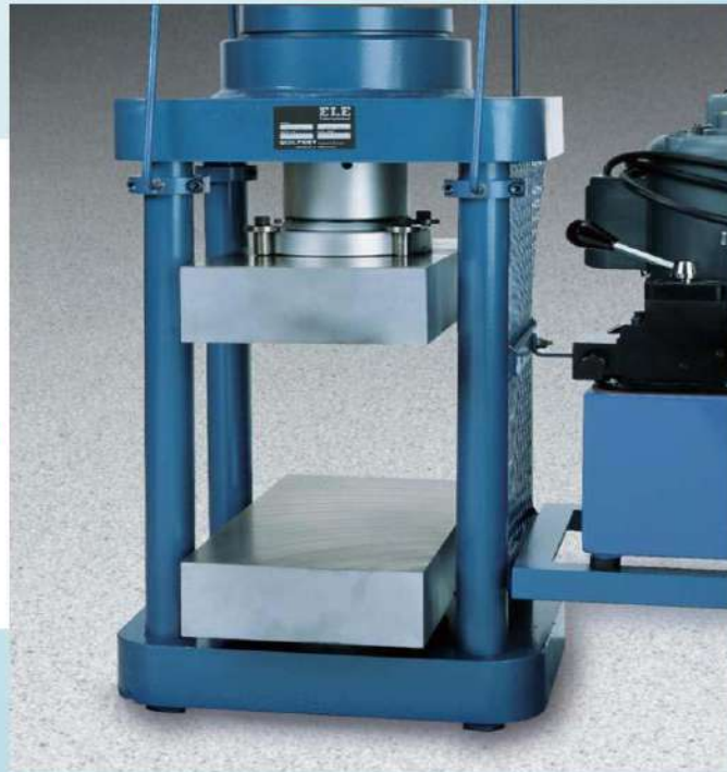
جهاز انضغاط مونة السمنت
