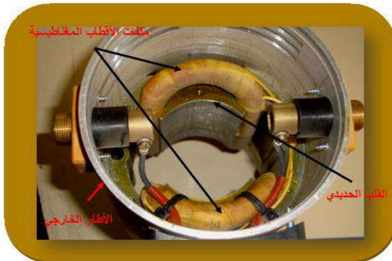
شكل (4-2) يبين الإطار الخارجي، القلب الحديدي وملفات الأقطاب مع بعضها
