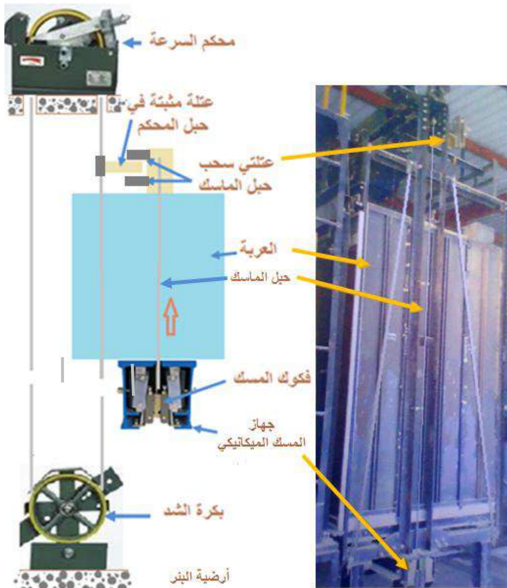
شكل (8-1) يبين أجزاء محكم السرعة القرصي مع جهاز المسك الميكانيكي
