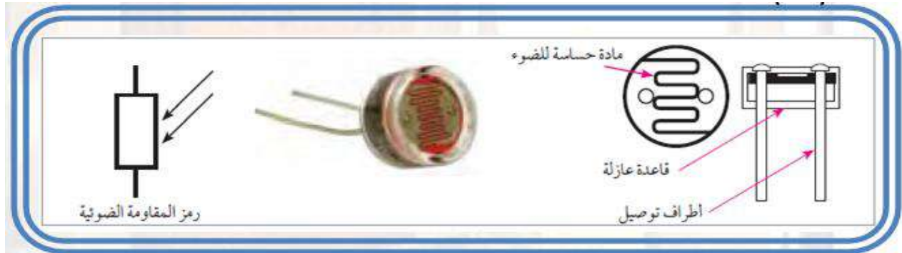
شكل (1-7) شكل المقاومة الضوئية وتركيبها ورمزها
