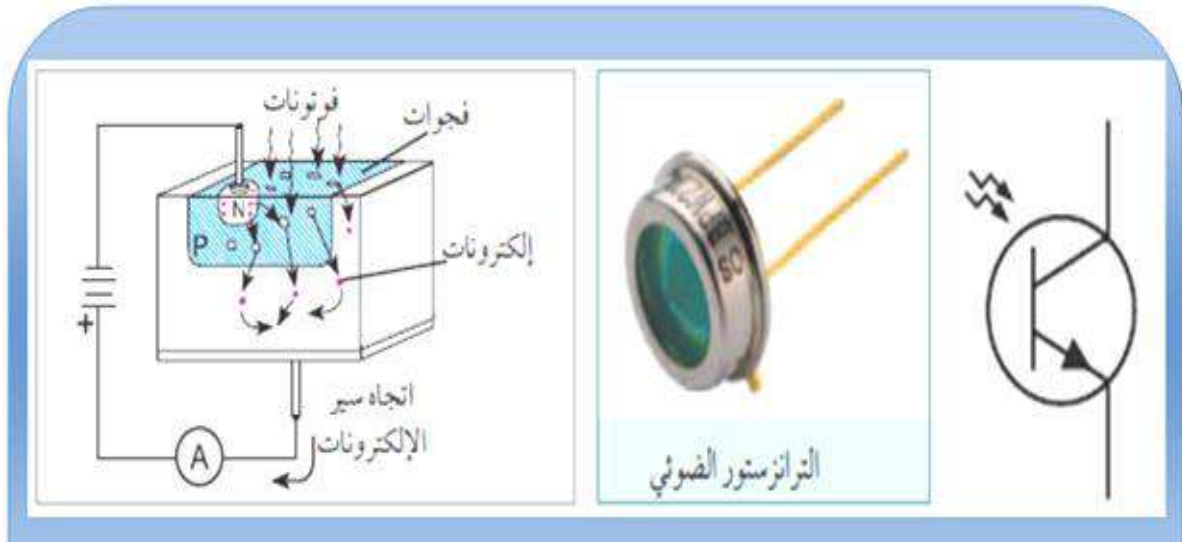
شكل (2-7) الترانزستور الضوئي ورمزه وتركيب
