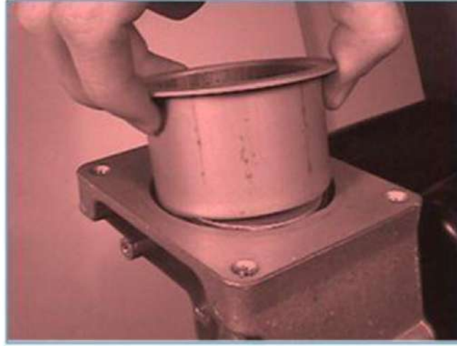
شكل رقم ( 71-3 ) يبين رفع اسطوانة المكبس
