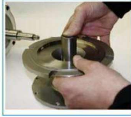
الشكل رقم ( 22-3 ) يبين رفع بقية أجزاء المجموعة الحاصرة
