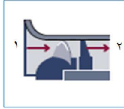
شكل رقم ( 4-3 ) المضخة الطاردة المركزية ذات الجريان المحوري
