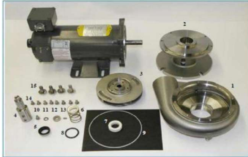
الشكل رقم ( 3-16 ) يبين أجزاء وأرقام كل جزء من المضخة .
