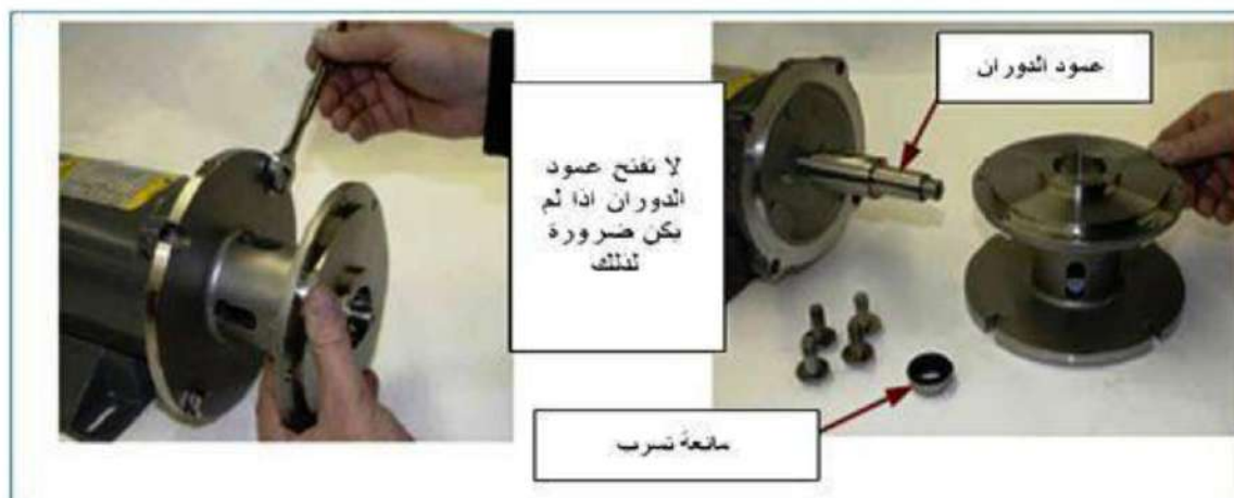
الشكل رقم ( 20-3 ) يبين طريقة فصل البراكيت الرابط
