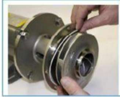
الشكل رقم ( 32-3 ) يبين كيفية تركيب حلقة الحصر
