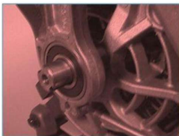
شكل رقم ( 3-69 ) يبين فتح ذراع التوصيل
