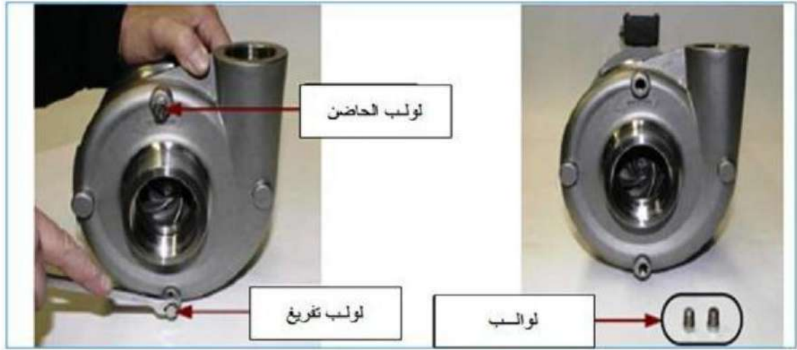
الشكل رقم ( 3-15 ) يبين فتحة تفريغ ماء المضخة
