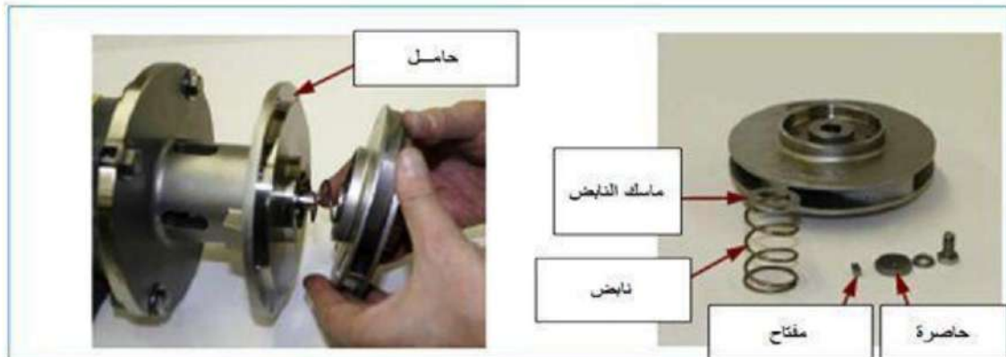
الشكل رقم ( 3-19 ) يبين طريقة فتح البشارة
