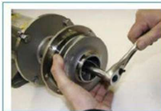
الشكل رقم ( 3-31 ) طريقة ربط البشارة
