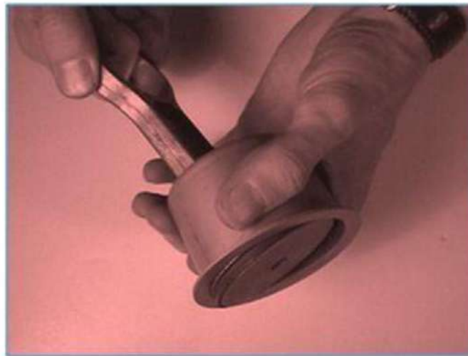
شكل رقم ( 75-3 ) يبين تركيب ذراع التوصيل على كرسي التحميل
