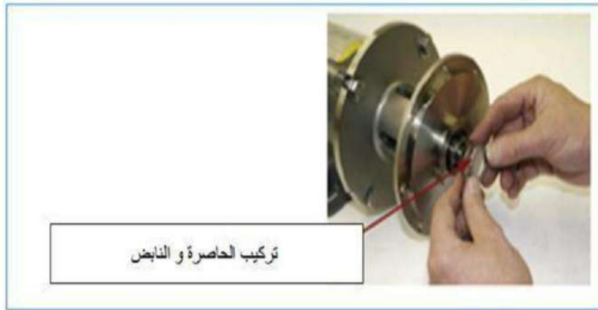
الشكل رقم ( 3-29 ) تركيب الغطاء المسطح
