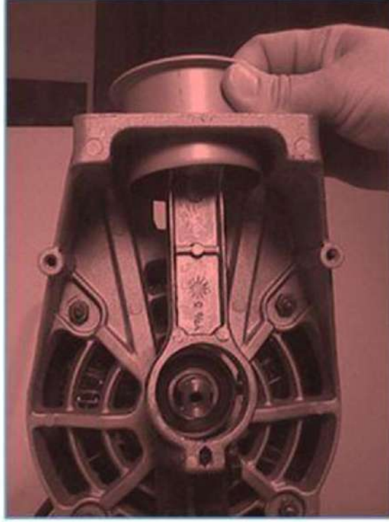
شكل رقم ( 3-76 ) طريقة تركيب ذراع التوصيل على كرسي التحميل
