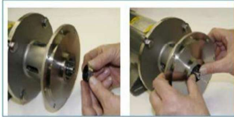
الشكل رقم ( 27-3 ) تركيب مجموعة القفل على المحور
