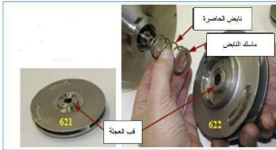
الشكل رقم ( 28-3 ) تركيب الغطاء للطرف المقابل للبشارة
