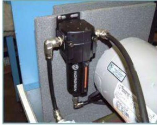
الشكل رقم ( 38-3 ) يبين مصفي الهواء
