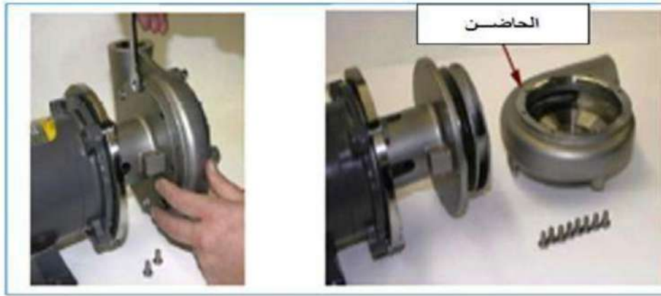
الشكل رقم ( 3-17 ) فصل المضخة عن الحاضن
