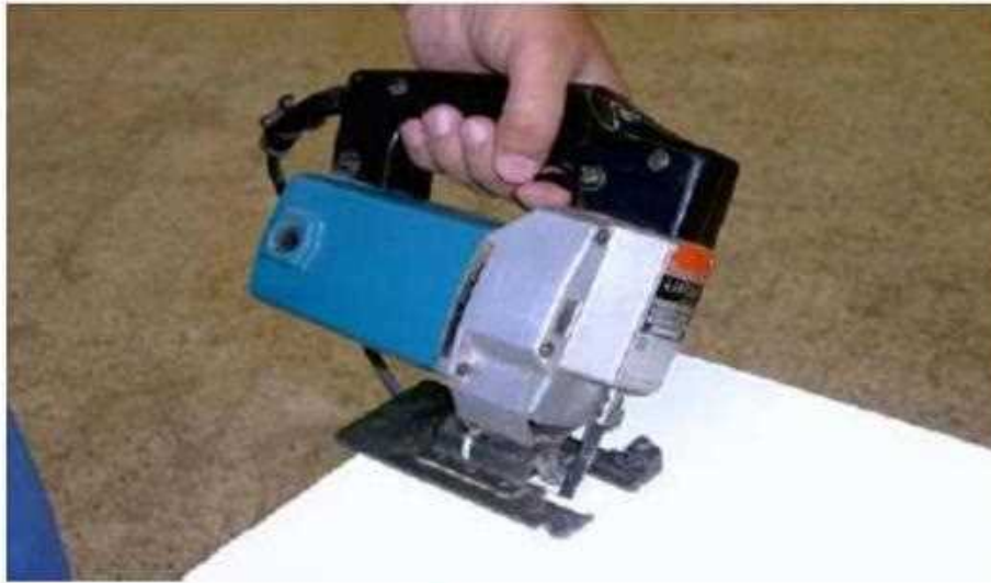
شكل (2 - 15) يوضح كيفية تنفيذ النشر المائل
