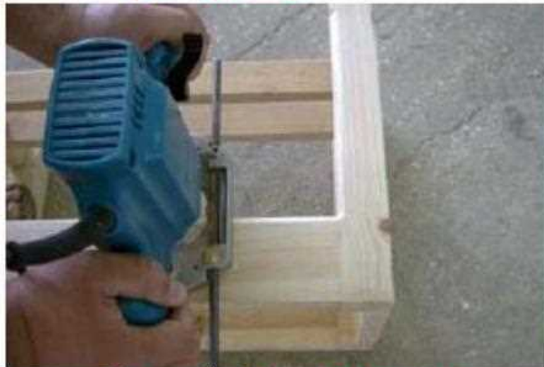
الشكل (3 - 21) يوضح طريقة حلي الحافات
