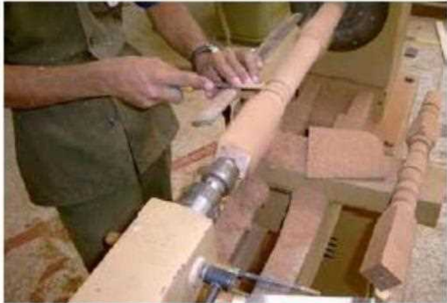
شكل (1 - 101) يوضح كيفية استخدام أزاميل الخراطة
