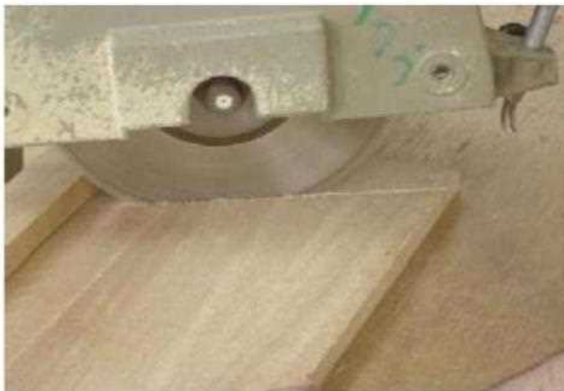
الشكل (1-4) يبين عملية القطع المائل
