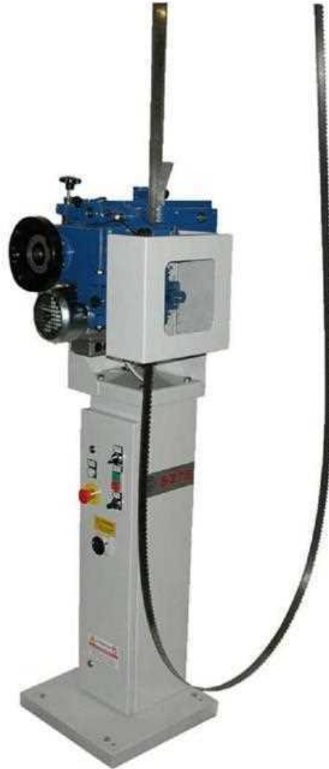
شكل (1 - 128) يوضح أجزاء ماكينة سن وتفلج المناشير
