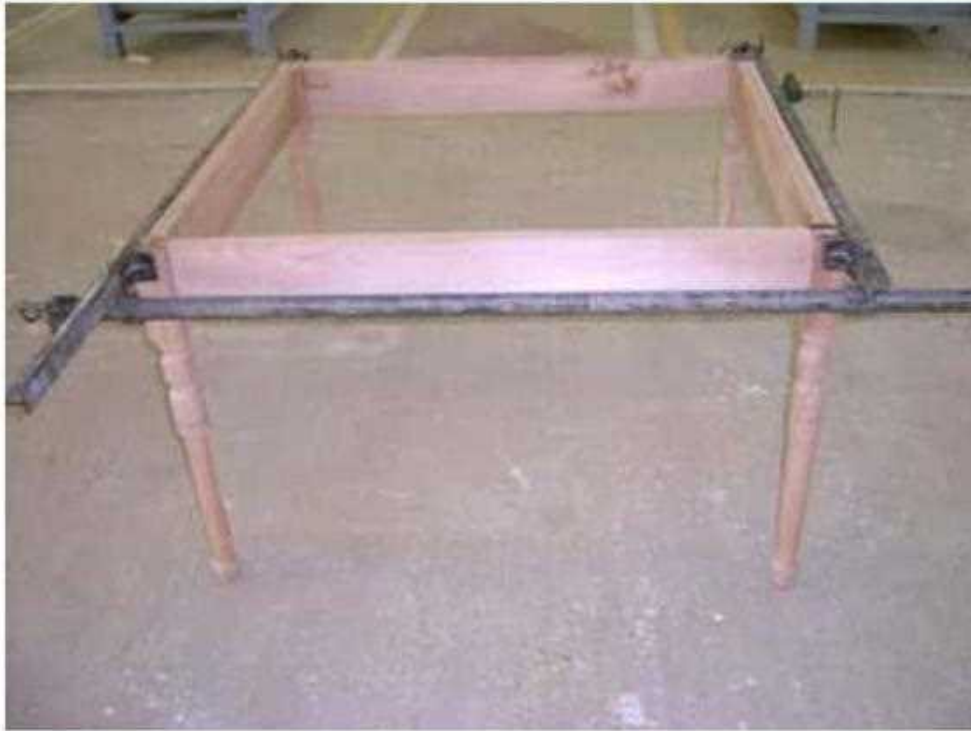
شكل (3 - 86) يوضح تجميع الطاولة وربطها بالمرابط
