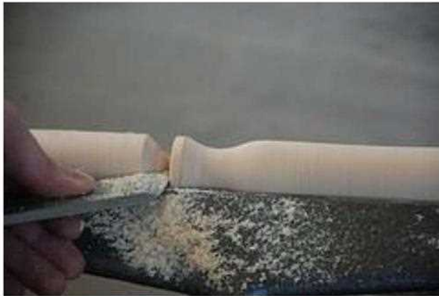
شكل (1 - 106) يوضح عمل الأزميل ذو الحد المائل
