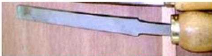
شكل (1 - 107) يوضح الأزميل ذو المنقار المربع
