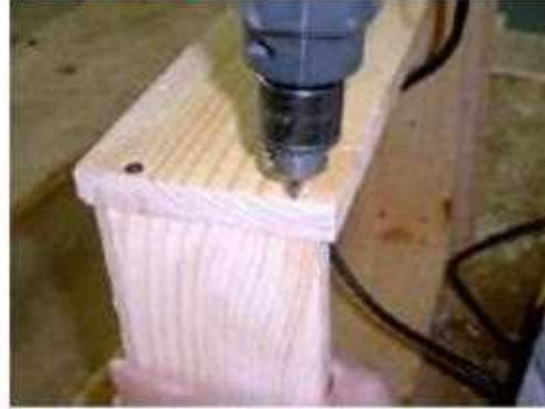
شكل (3 - 46) يوضح عملية تجميع أجزاء الجرار بالبراغي
