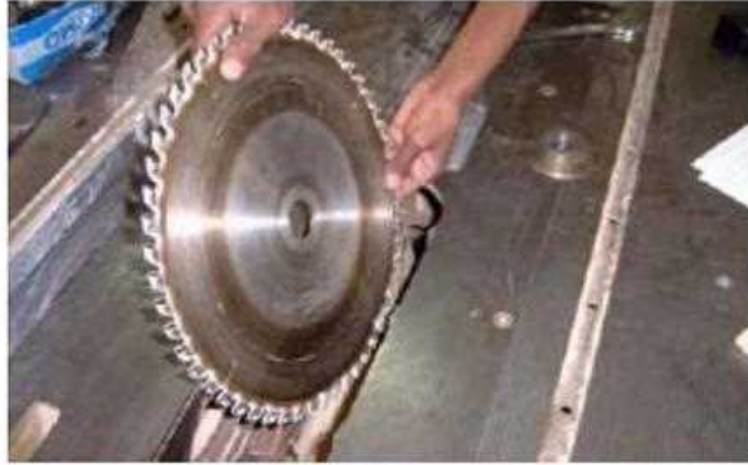
شكل (1 - 35) يبين طريقة نزع سلاح المنشار
