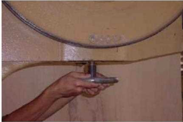
شكل (1- 14) يبين عجلة تعديل التوتر لخفض العجلة العلوية
