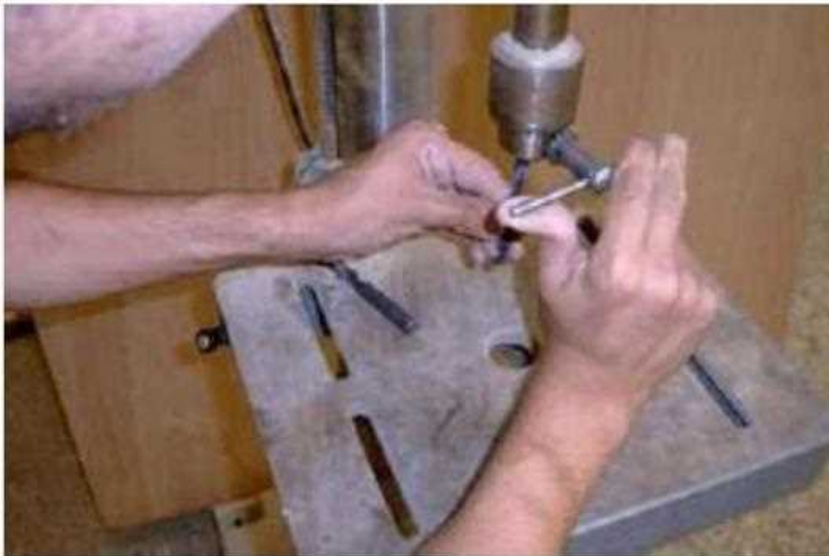
شكل (1 - 77) يوضح كيفية تركيب البريمة في لقمة المثقاب
