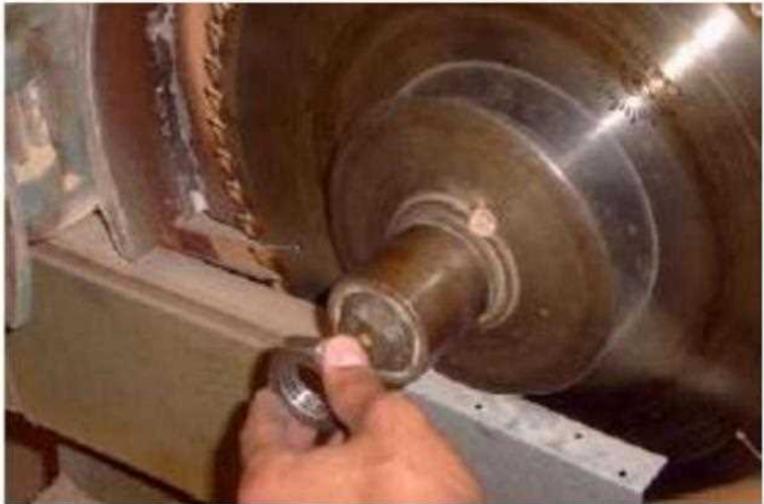
شكل (1-7) يبين طريقة تركيب صامولة الربط
