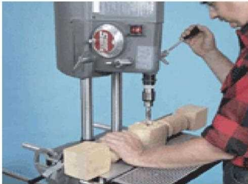
شكل (79 - 1) يوضح كيفية التنقيب في قطعة الخشب
