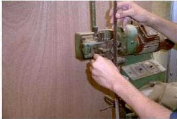
شكل (1 - 130) يوضح كيفية ضبط مبرد السن على أسنان السلاح
