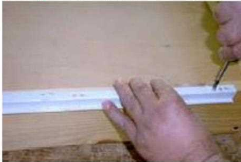
شكل (3 - 47) يوضح تثبيت السكك الانزلاقية للجرارات
