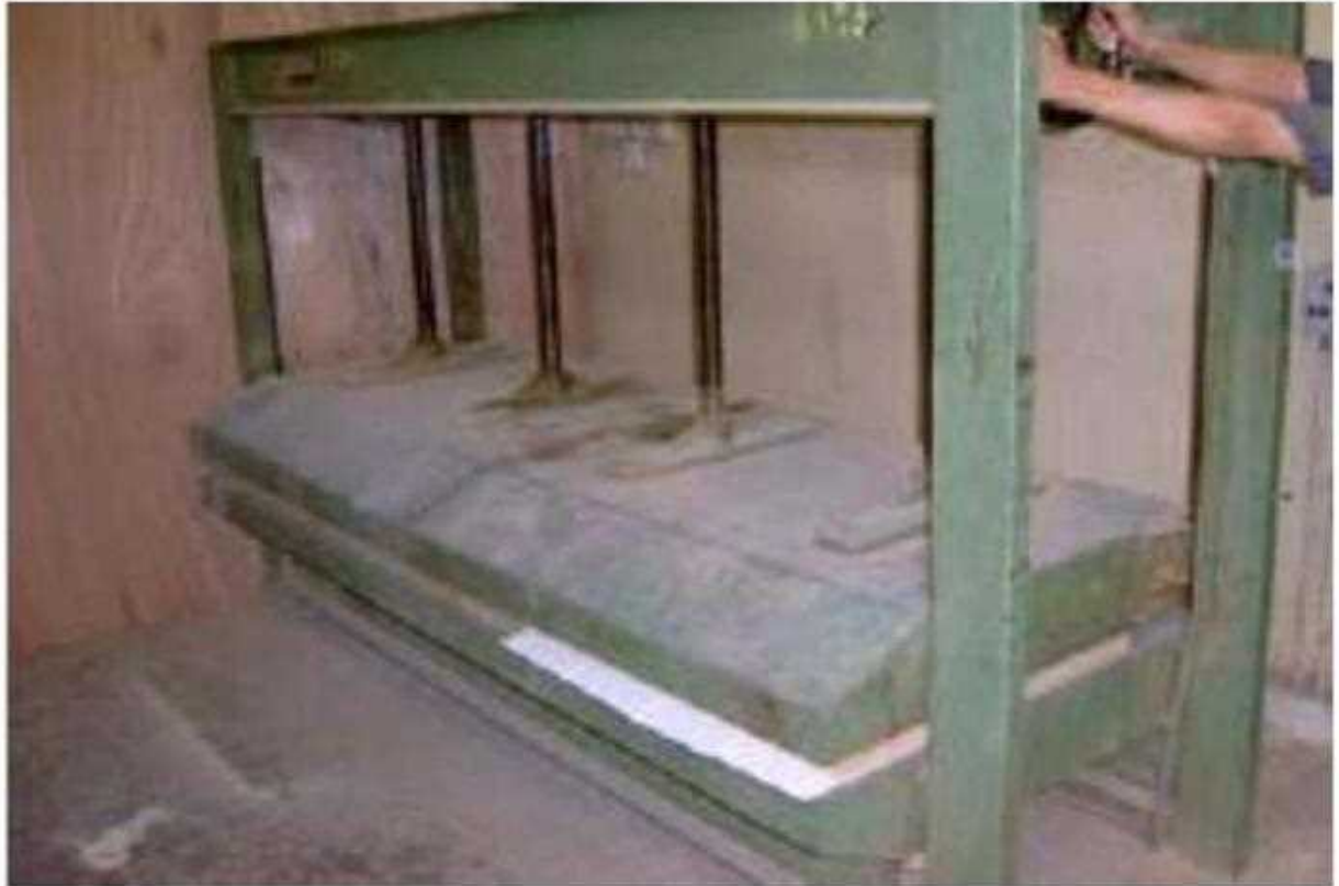
شكل (1 - 138) يوضح خفض قرصة الضغط على قطع العمل
