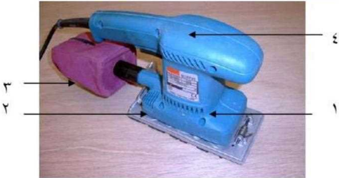
شكل (2 - 58) يوضح أجزاء جهاز الصنفرة
