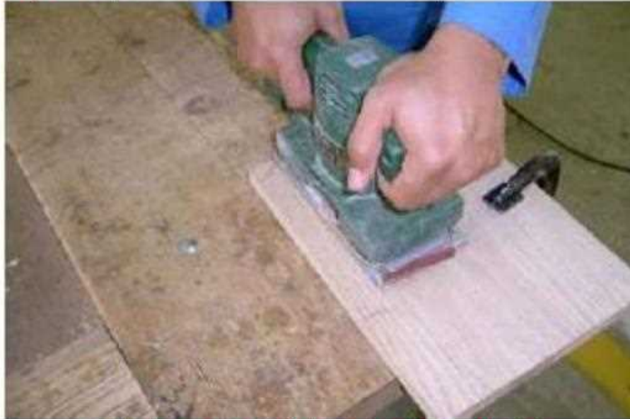
شكل (2 - 61) يوضح عملية التنعيم بجهاز الصنفرة
