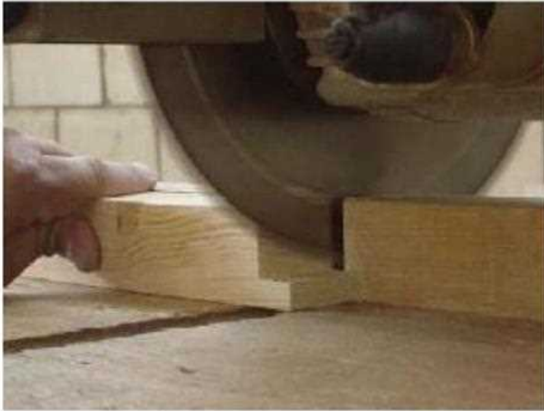
الشكل (1-3) يبين عملية الخدش النصفى
