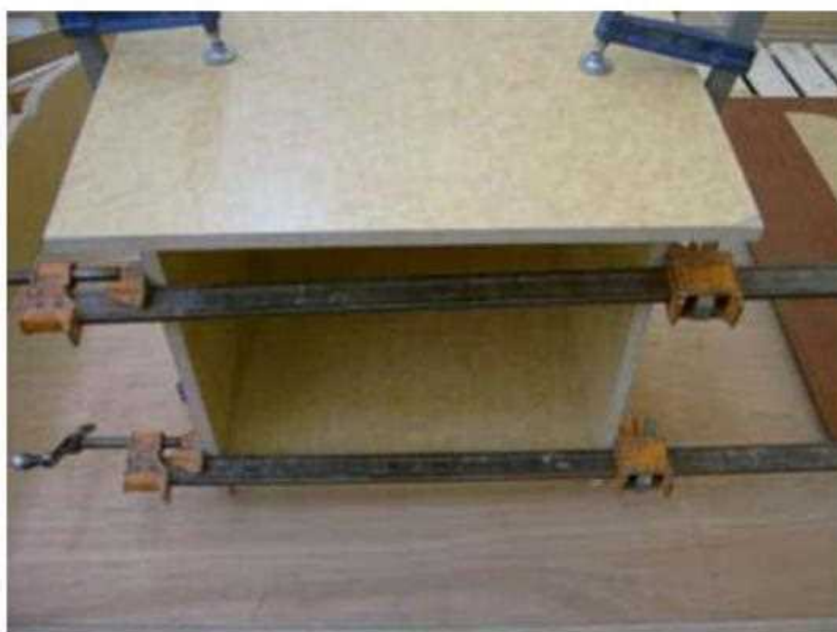
شكل (3 - 58) يوضح تجميع التمرين وربطه بالمرابط
