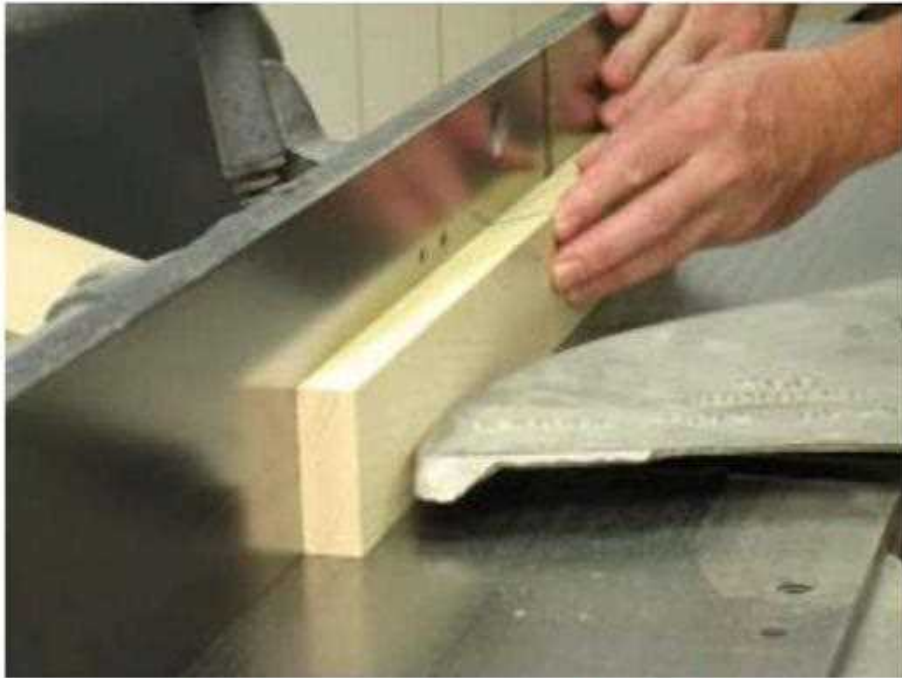
الشكل (3 - 5) يوضح عملية مسح وجه القطعة
