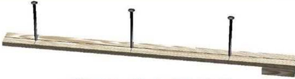
شكل (2 - 37) يوضح قالب علامات التنقيب
