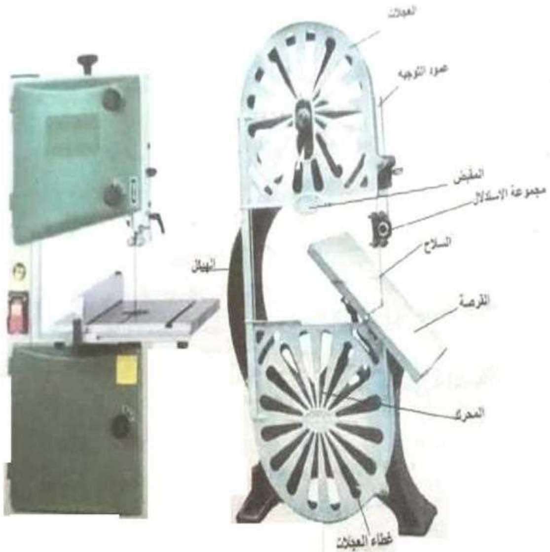
الشكل (1-11) يبين اجزاء المنشار
