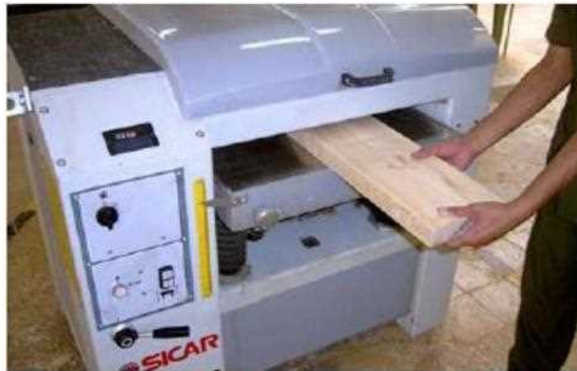
شكل (1 - 53) يبين عملية مسح الوجه على ماكينة الثخانة
