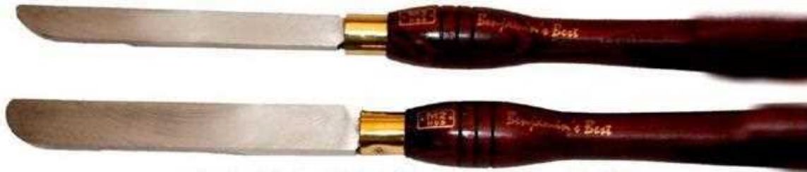
شكل (1 - 110) يوضح الأزاميل ذات المنقار المستدير والشكل (1 - 111) يبين طريقة عمل الأشكال المقعرة بالأزاميل الأقل عرضاً .
