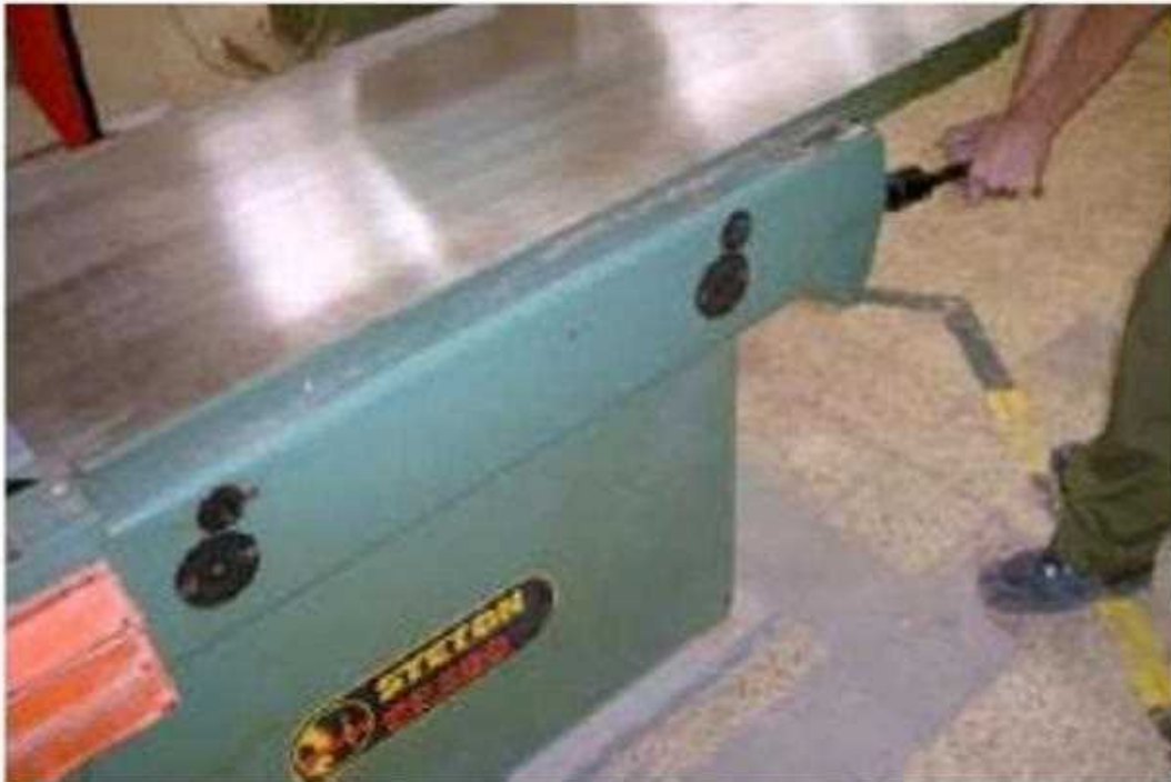
شكل (1 - 44) يبين كيفية خفض الطاولة
