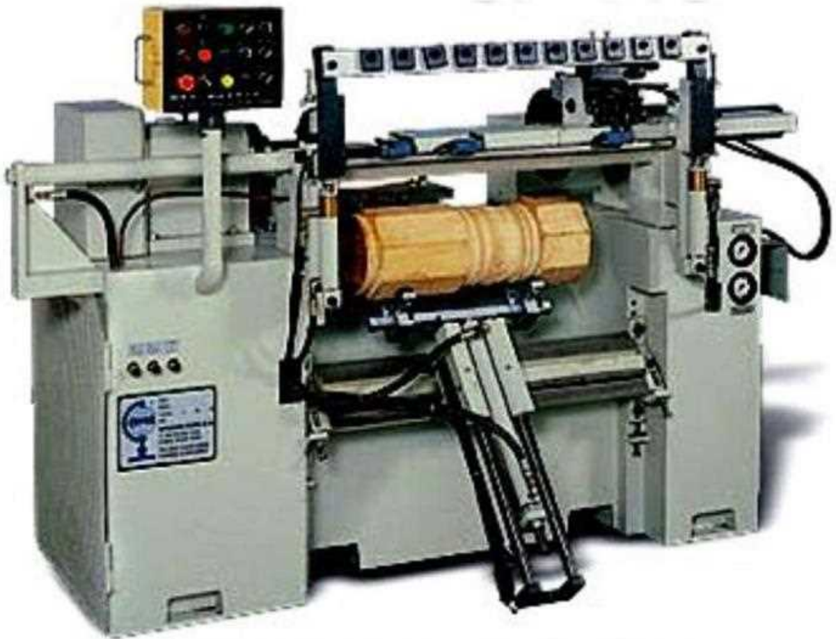
شكل (1 - 96) يوضح المخرطة النجارية النصف أوتوماتيكية
