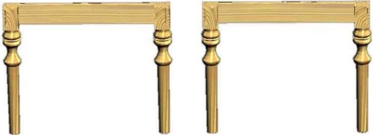
شكل (3 - 85) يوضح تجميع جانبي الطاولة
