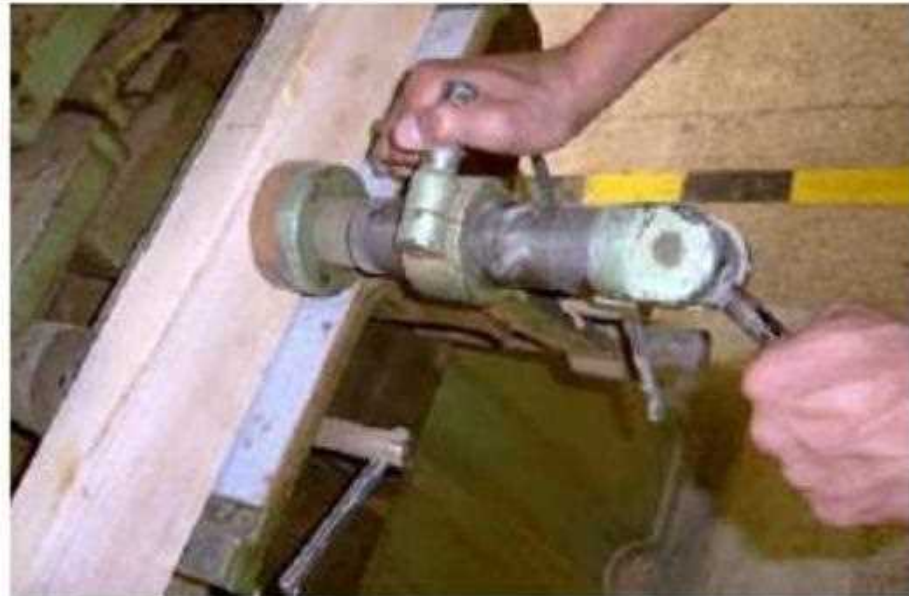
شكل (1 - 72) يوضح تثبيت قطعة الخشب بذراع الربط
