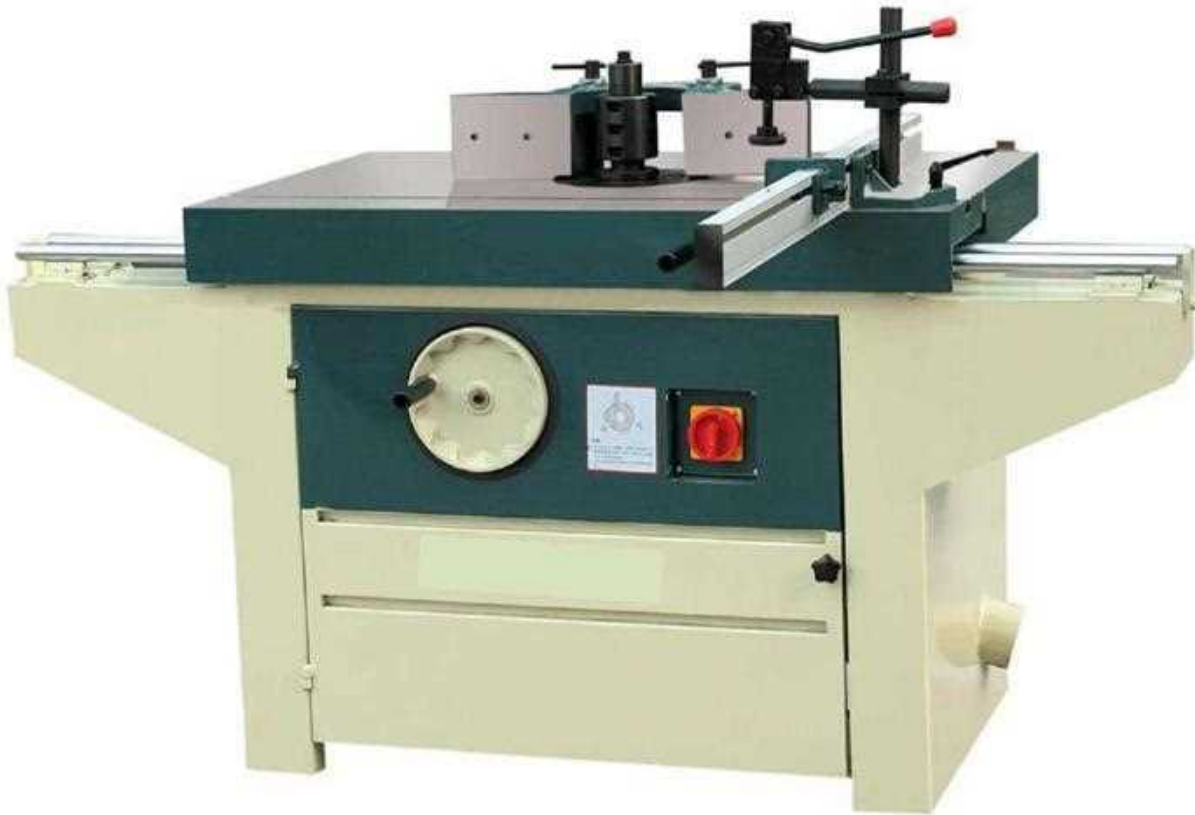
شكل (1 - 85) يوضح ماكينة الفريزة ذات العمود السفلي
