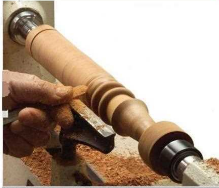
شكل (1 - 111) يوضح عمل الأشكال المقعرة باستخدام الأزاميل ذات المنقار المستدير
