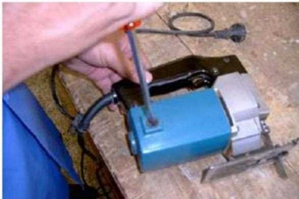
شكل (2 - 17) يوضح كيفية فك برغي (الفحمة)
