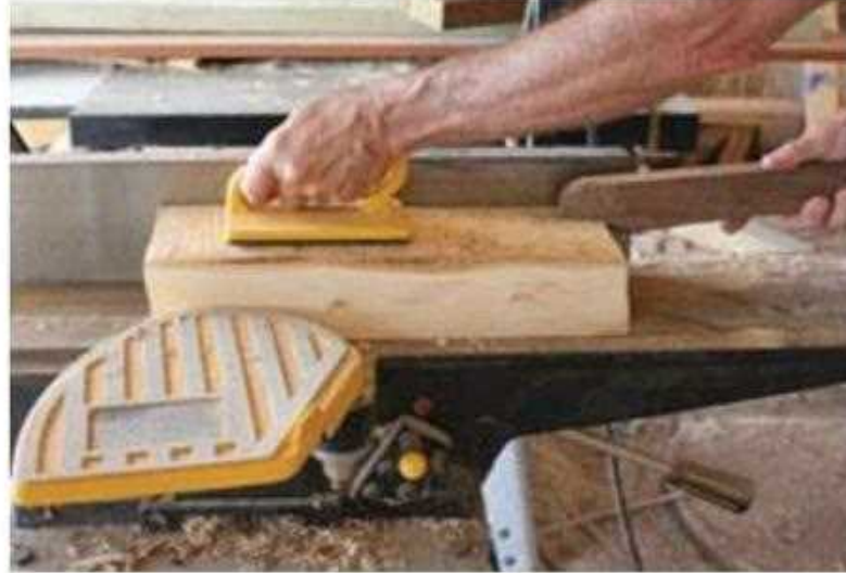
شكل (1- 49) يوضح عملية مسح وجه قطعة الخشب
