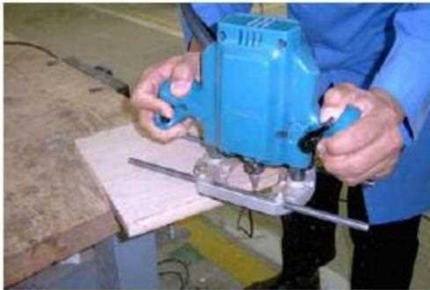
شكل (2 - 52) يوضح عملية الفرز المنحني بواسطة ماكينة الفريزة المتنقلة
