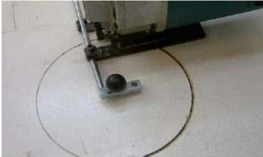
شكل (2 - 13) يوضح كيفية تنفيذ القطع الدائري
