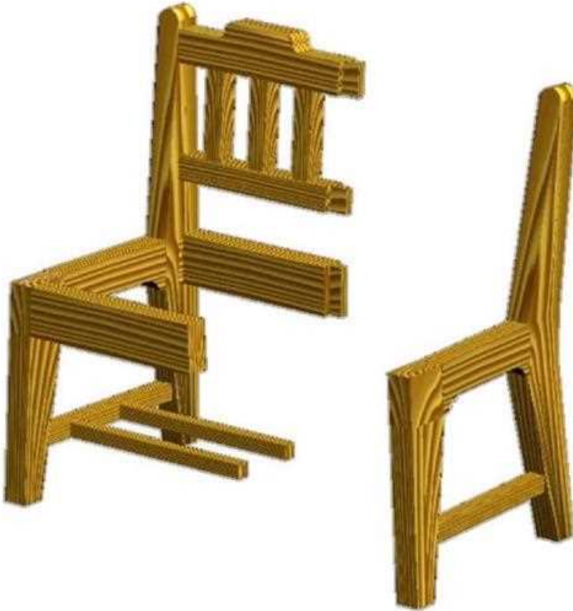
شكل (3 - 72) يوضح تجميع الأجزاء الرابطة بين الجنبين
