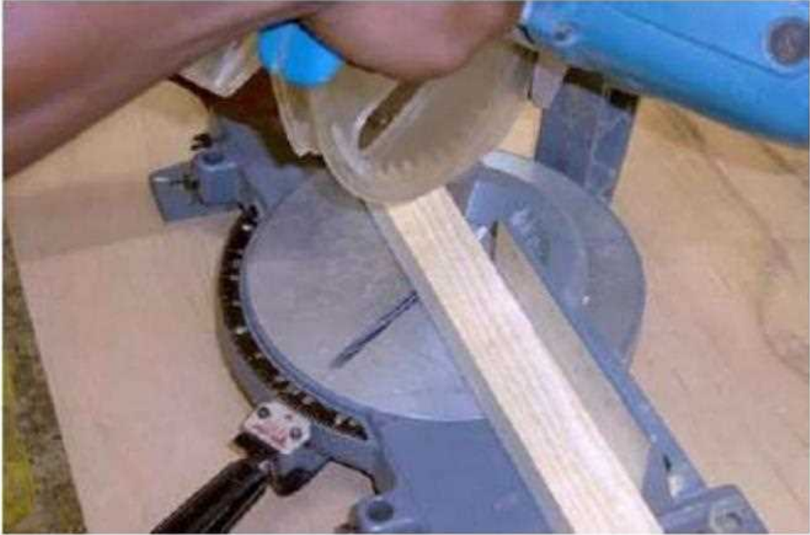
شكل (2 - 26) يوضح كيفية ضبط الطاولة بموجب الزاوية المطلوبة
