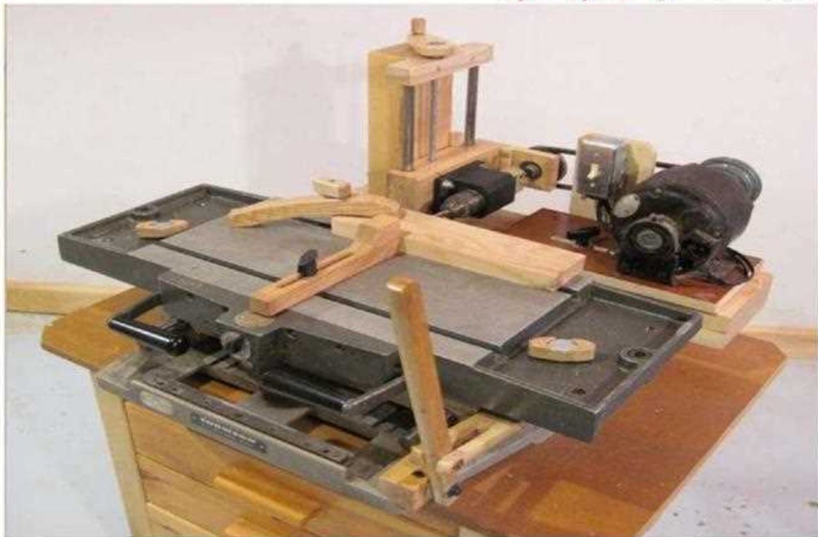
الشكل (3 - 9) يوضح عملية النقر لتثبيت الألسن
