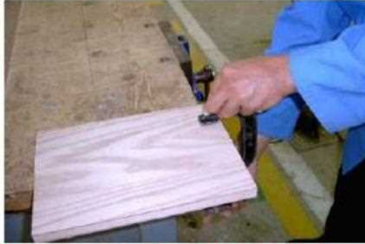
شكل (2 - 51) يوضح كيفية تثبيت القطعة بمربوط حرف (C)
