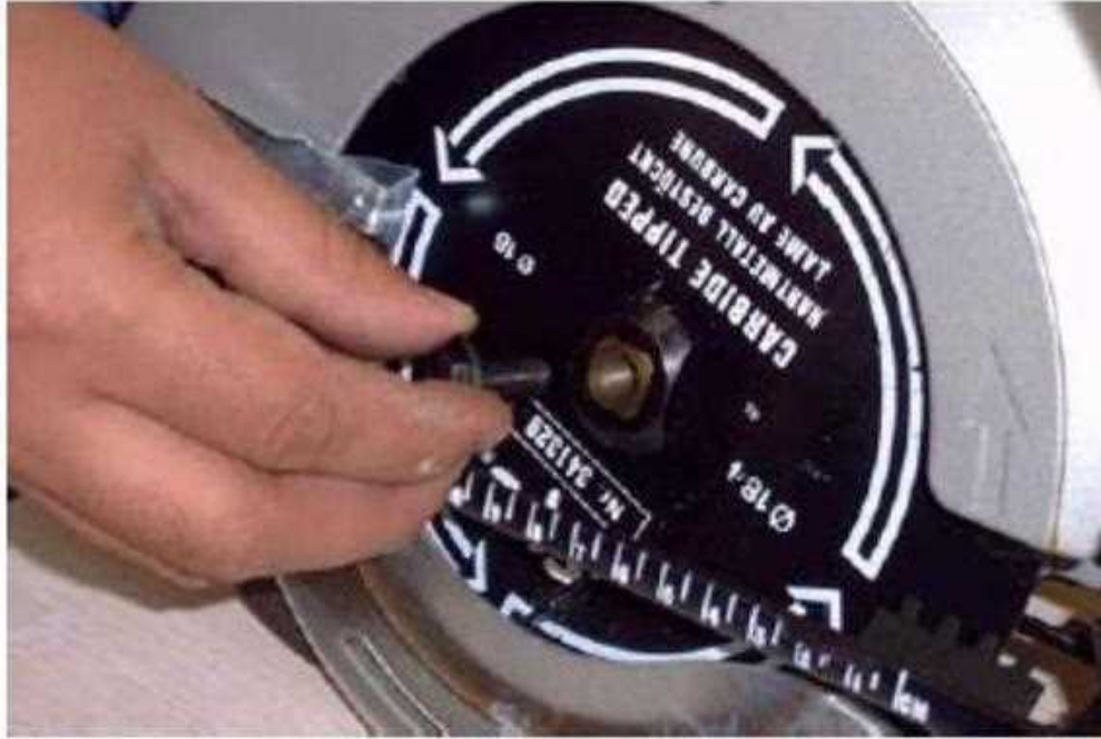
شكل (2 - 5) يوضح كيفية تركيب وربط الصامولة
