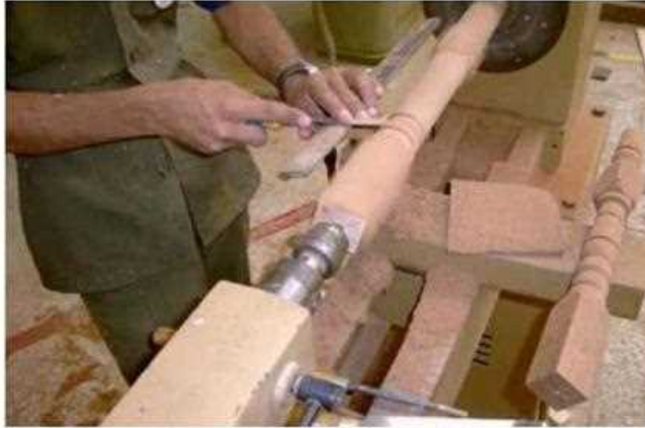
شكل (3 - 83) يوضح عملية الخراطة
