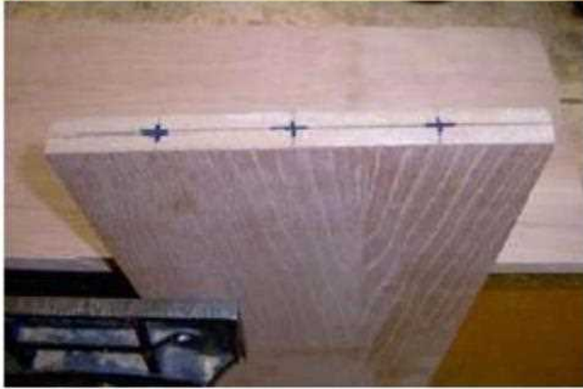
شكل (2 - 39) يوضح تحديد أماكن التثقيب
