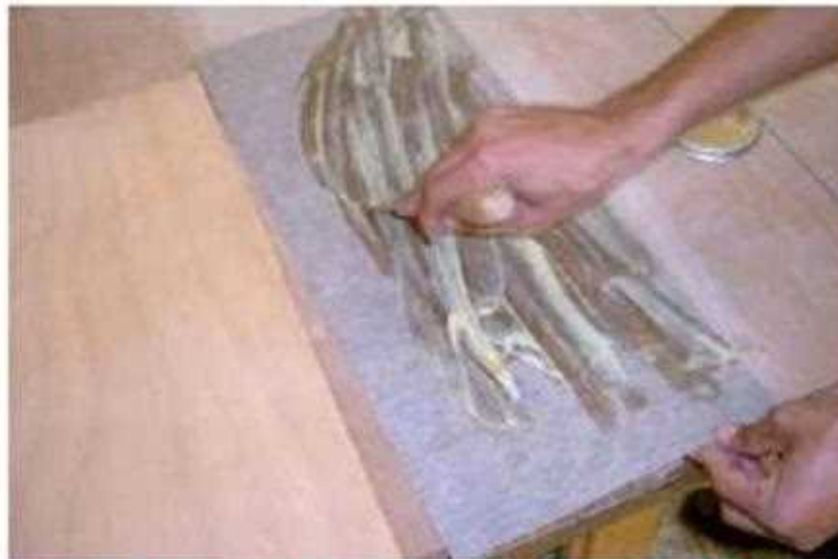
شكل (2 - 54) يوضح كيفية توزيع غراء الباتكس على ظهر الفورمايكا
