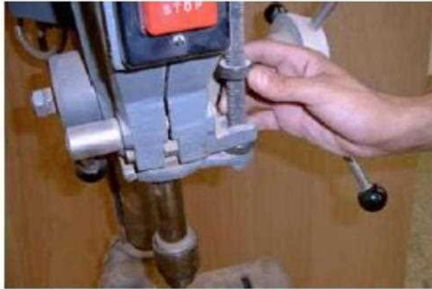
شكل (78 - 1) يوضح كيفية ضبط عمق الثقب بواسطة محدد العمق
