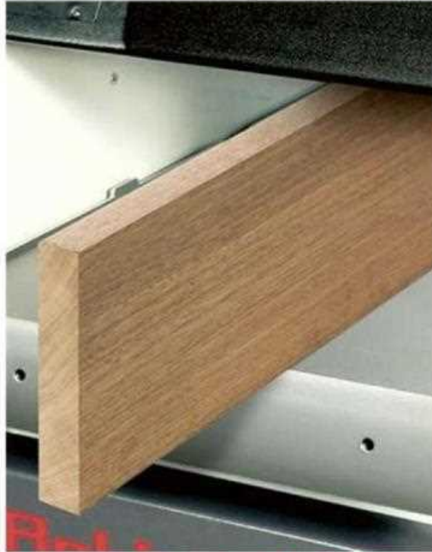
الشكل (3 - 6) يوضح عملية ضبط السمك
