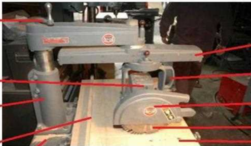
شكل (1-1) يبين منشار نصف قطري الذراع
