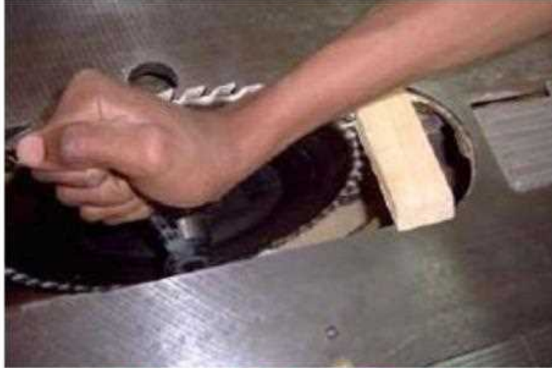
شكل (1 - 33) يبين طريقة فك صامولة السلاح
