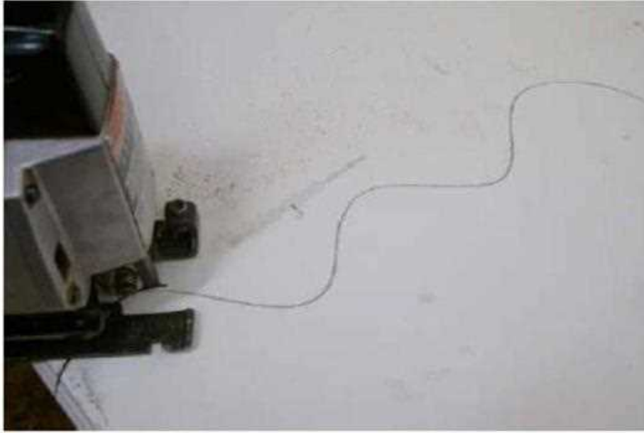
شكل (2 - 16) يوضح كيفية تنفيذ النشر المنحني (المتعرج)
