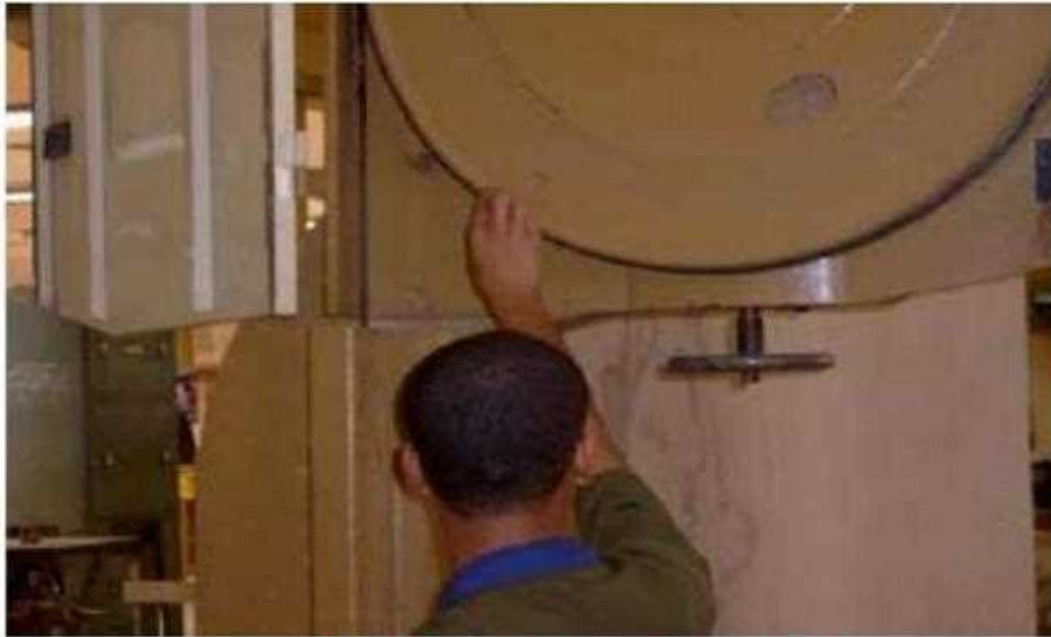
شكل (1-17) يبين كيفية تدوير العجلة العليا باليد
