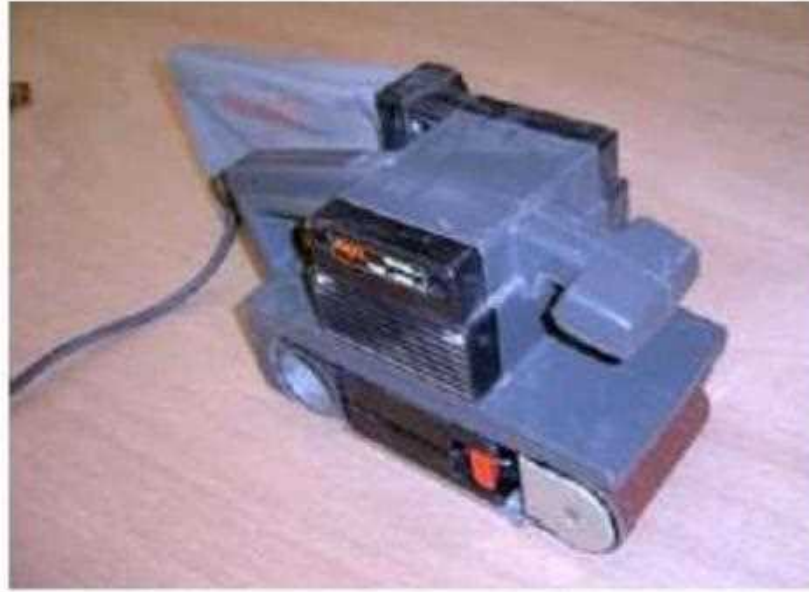
شكل (2 - 56) يوضح جهاز الصنفرة الشريطية (السير)
