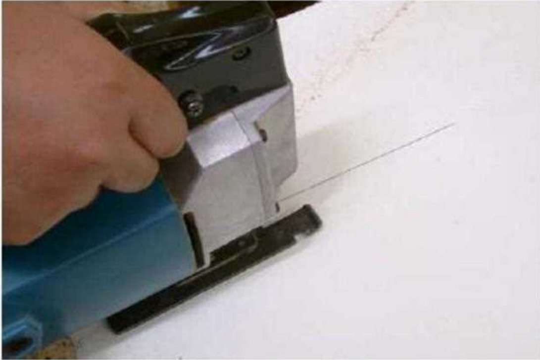
شكل (2 - 12) يوضح كيفية تنفيذ الشق الطولي المستقيم
