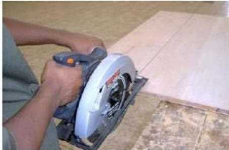
شكل (2 - 9) يوضح كيفية القطع بواسطة المنشار الدائري
