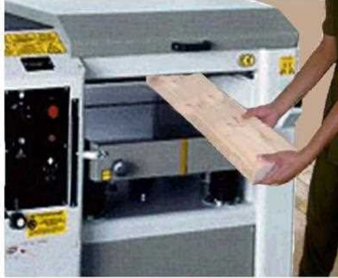
شكل (1 - 61) يوضح طريقة مسح وجه القطعة
