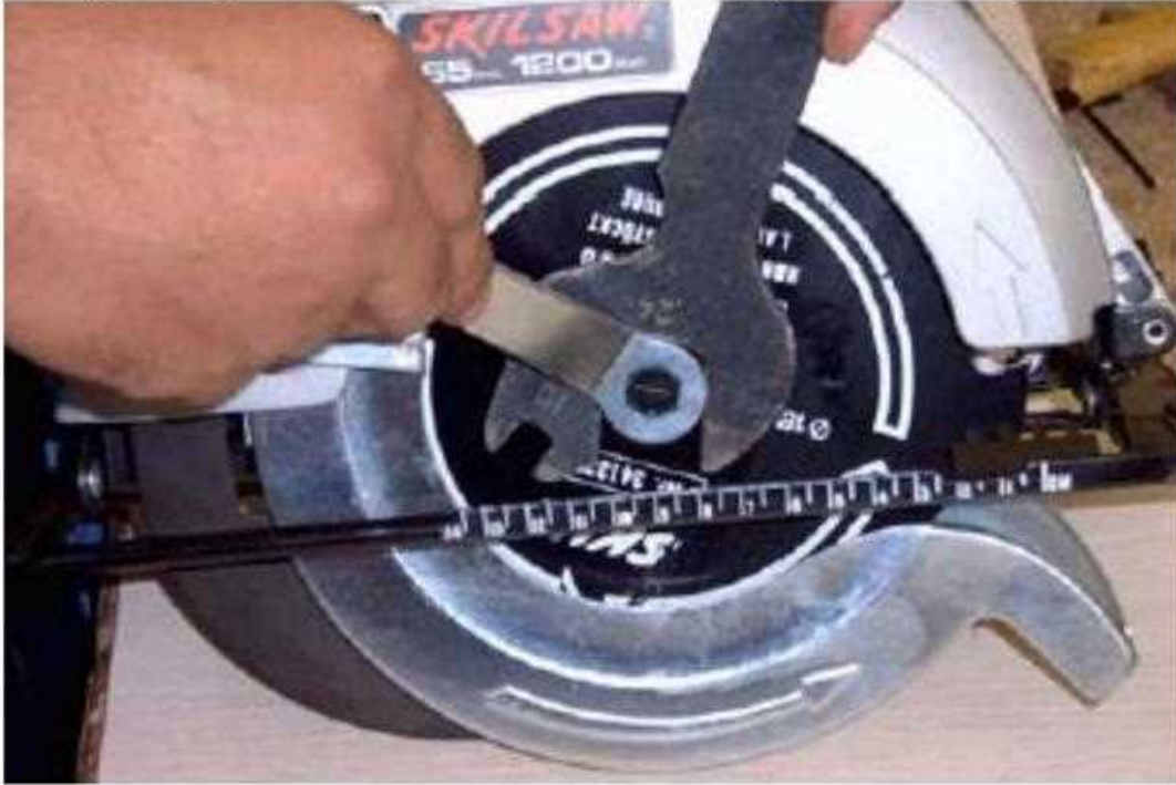
شكل (2 - 3) يوضح كيفية فتح الصامولة بمفتاح مناسب
