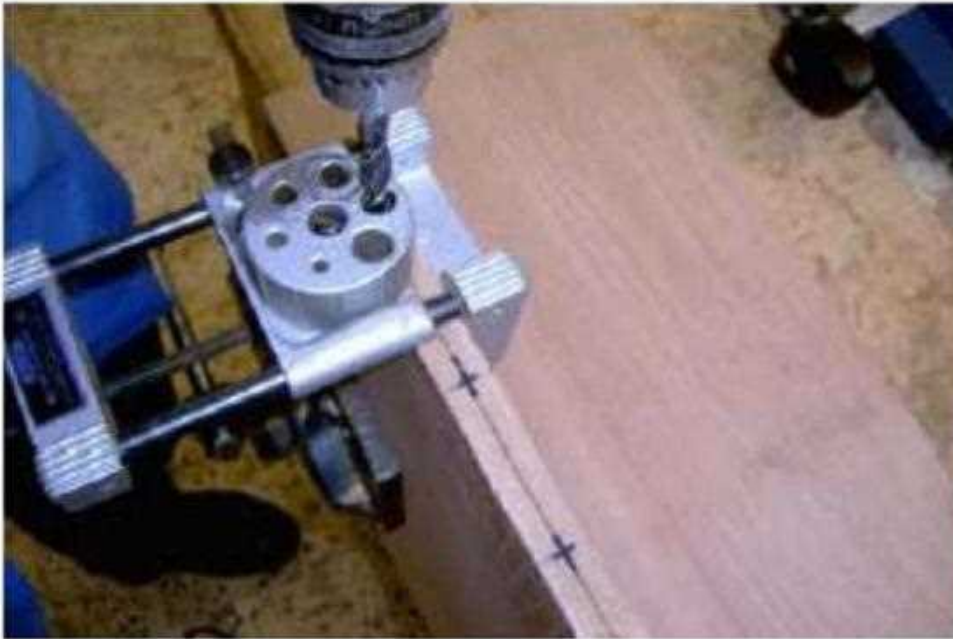
شكل (2 - 40) يوضح كيفية التثقيب باستخدام الدليل والثقب
