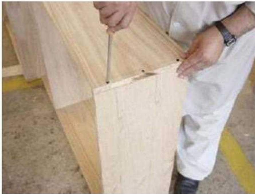
الشكل (3 - 29) يوضح تركيب القرصة
