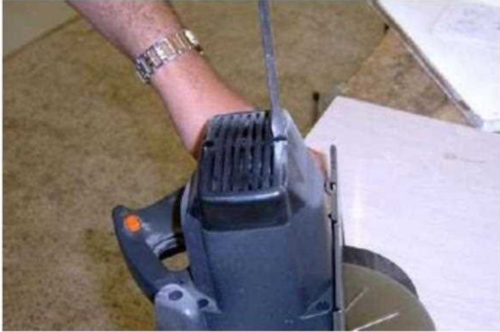
شكل (2 - 2) يوضح فتح الغطاء الخارجي للمحرك
