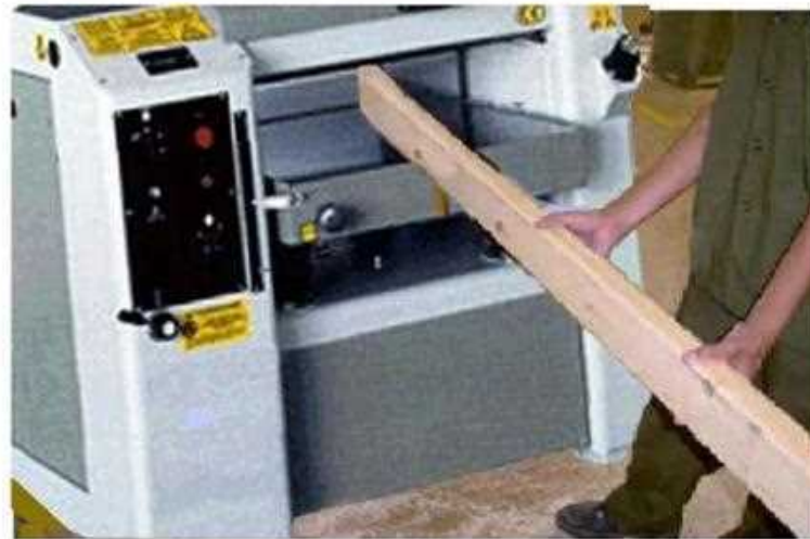
شكل (1 - 62) يوضح طريقة مسح حافة القطعة
