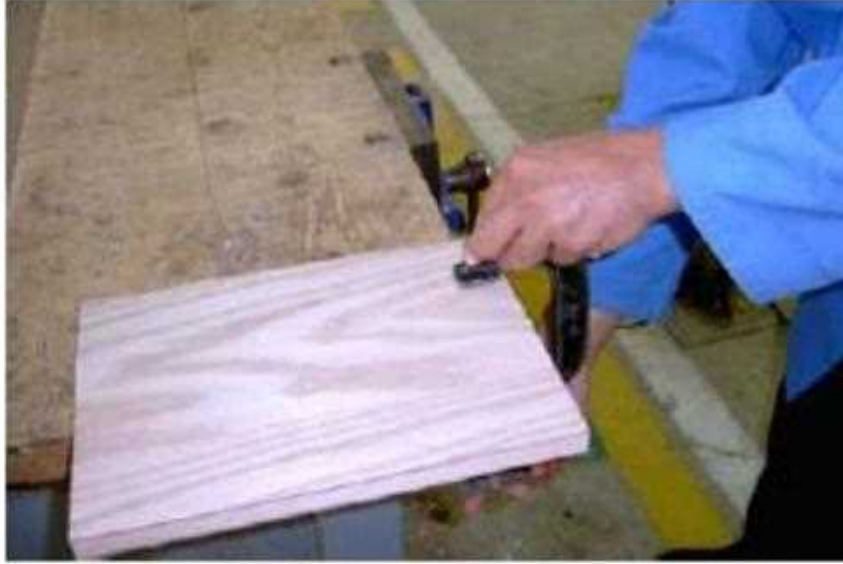
شكل (2 - 60) يوضح كيفية تثبيت القطعة المراد العمل عليها
