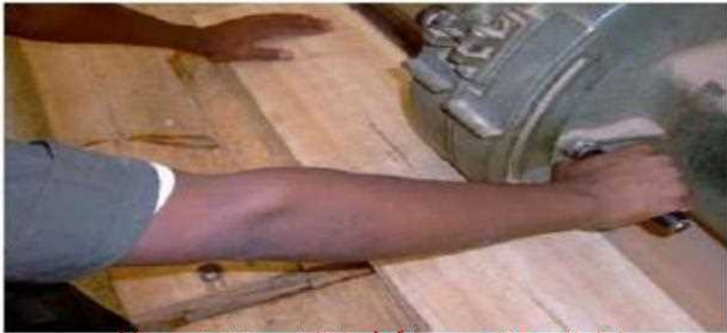
شكل (1 - 10) يبين عملية دفع المنشار بعد الانتهاء من القطع
