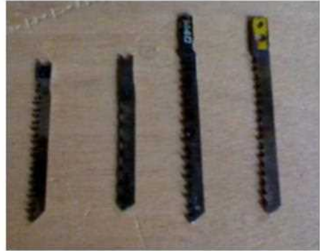
شكل (2 - 11) يوضح أنواع أسلحة منشار التخريم مجالات استخدام المنشار الترددي (الآركت) المتنقل :
