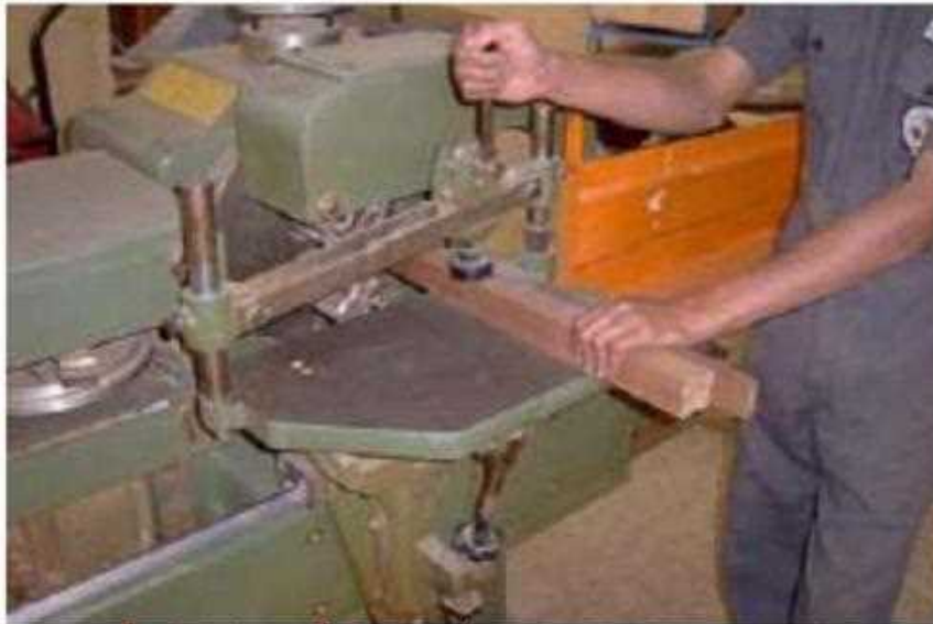
شكل (1 - 123) يوضح تثبيت القطعة بمربط الطاولة
