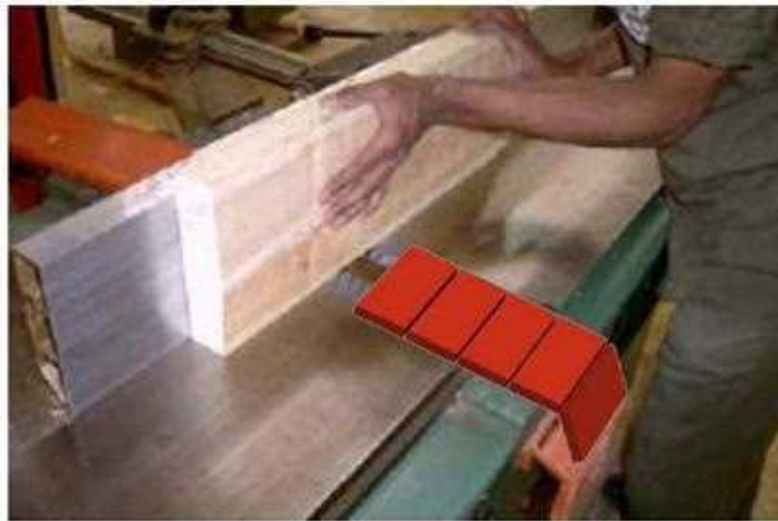
شكل (1- 50) يوضح عملية مسح جانب قطعة الخشب
