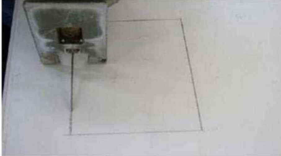
شكل (2 - 14) يوضح كيفية تنفيذ التفريغ الداخلي
