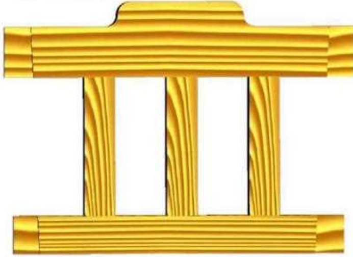
شكل (3 - 71) يوضح تجميع مسند ظهر الكرسي
