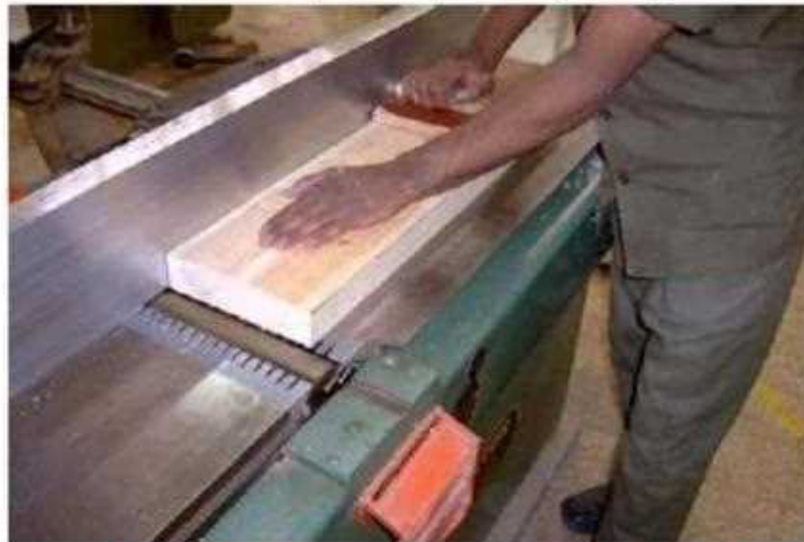
شكل (1 - 40) يبين كيفية مسح وجه القطعة
