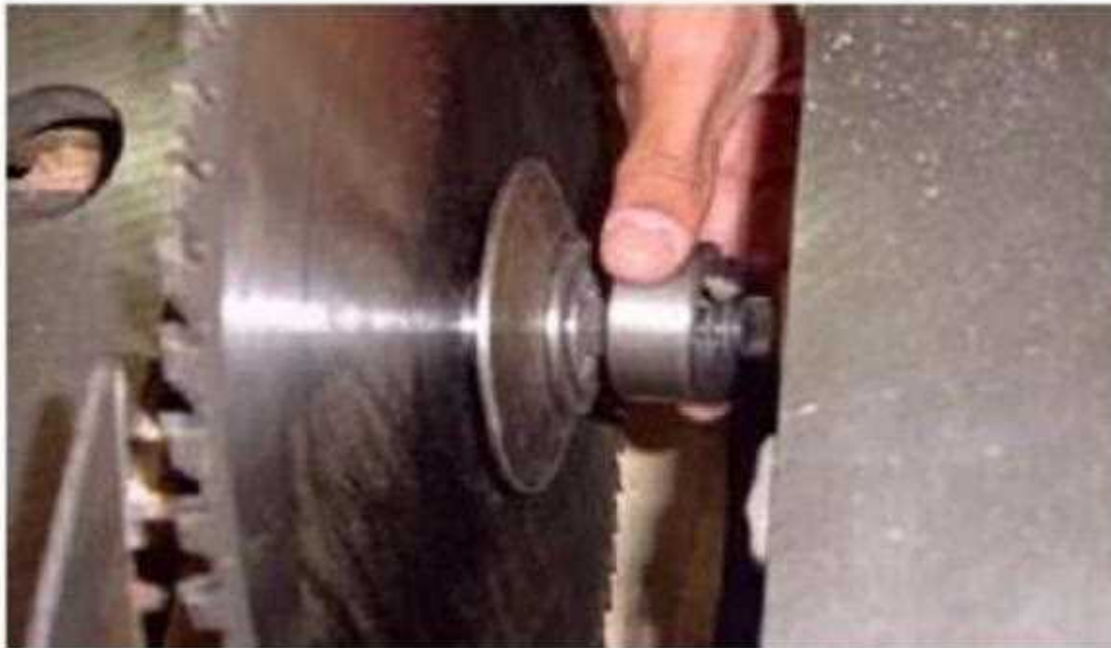
شكل (1 - 34) يبين كيفية إخراج الصامولة والحلقة
