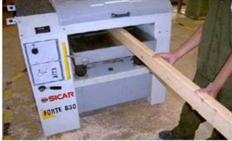
شكل (1 - 54) يوضح عملية ضبط العرض
