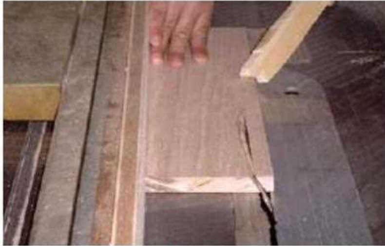
شكل (1- 32) يبين عملية الشطف الطولي
