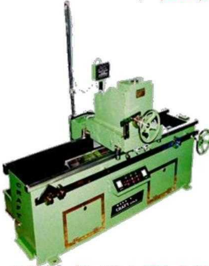
شكل (1 - 124) يوضح أجزاء ماكينة سن أسلحة الرندات
