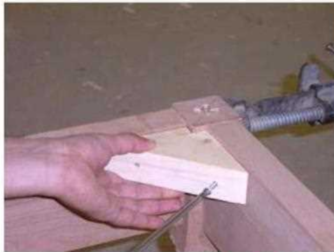
شكل (3 - 87) يوضح تثبيت قطع الزاوية
