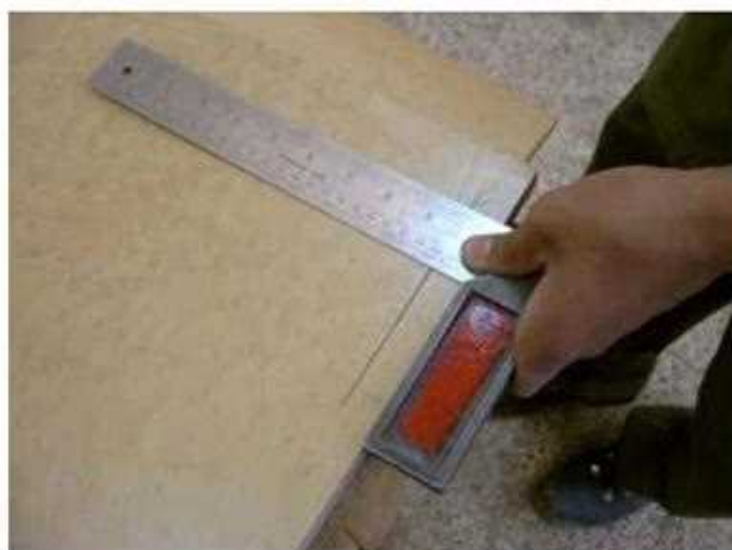
شكل (3 - 54) يوضح كيفية تأشير أماكن اتصال القرصة والقاعدة
