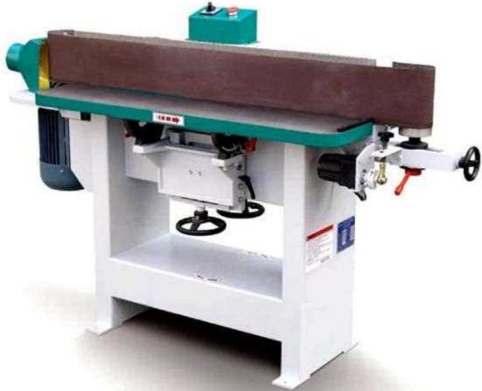
شكل (1 - 80) يوضح ماكينة الصنفرة الرملية ذات السير
