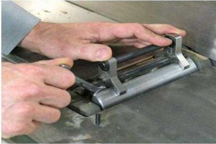
شكل (1 - 47) يبين كيفية ضبط السكاكين مع حافة الطاولة
