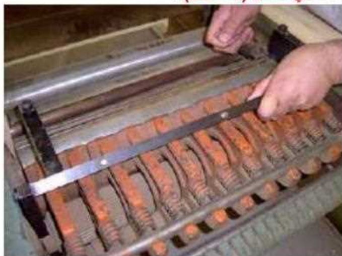
شكل (1 - 59) يوضح كيفية تركيب الأسلحة
