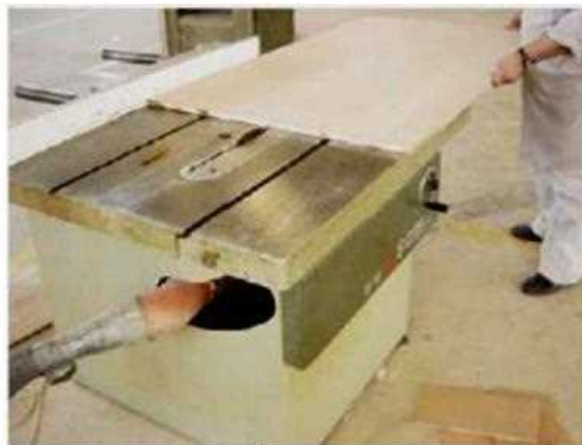
الشكل (3 - 27) يوضح عملية نشر لوح البلوك بورد
