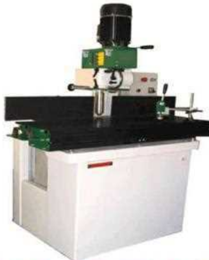
شكل (1 - 86) يوضح أجزاء ماكينة الفريزة ذات العمود العلوي
