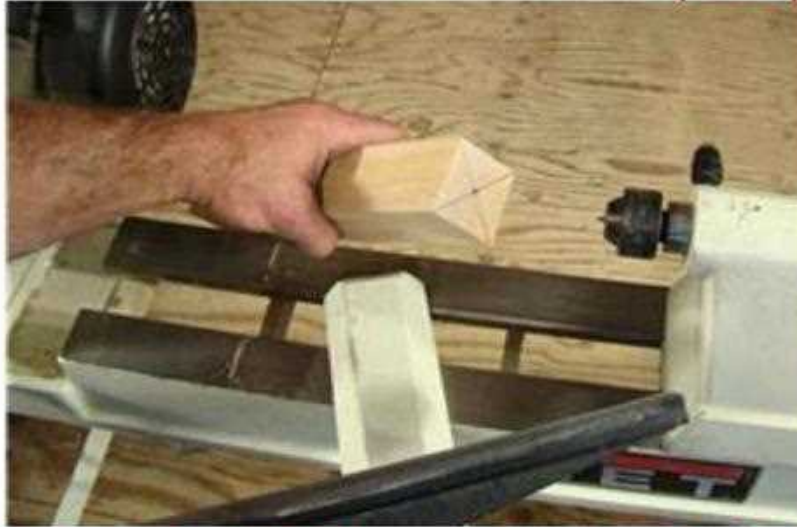
شكل (1 - 98) يوضح تخطيط رؤوس القطعة لتثبيتها في الغراب الثابت
