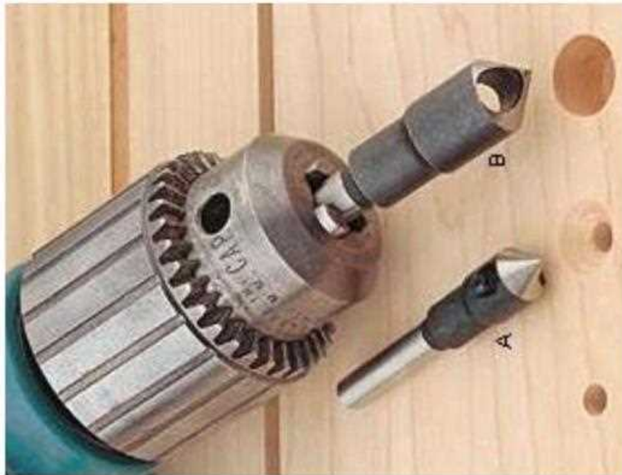
شكل (2 - 35) يوضح بريمة التغطيس
