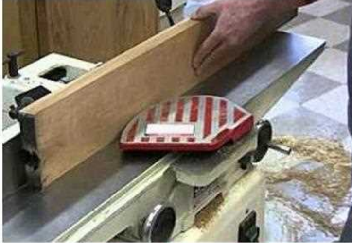
شكل (1 - 41) يبين كيفية مسح حافة القطعة
