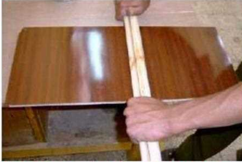
شكل (2 - 55) يوضح عملية دعك الفورمايكا بخشبة خارجية
