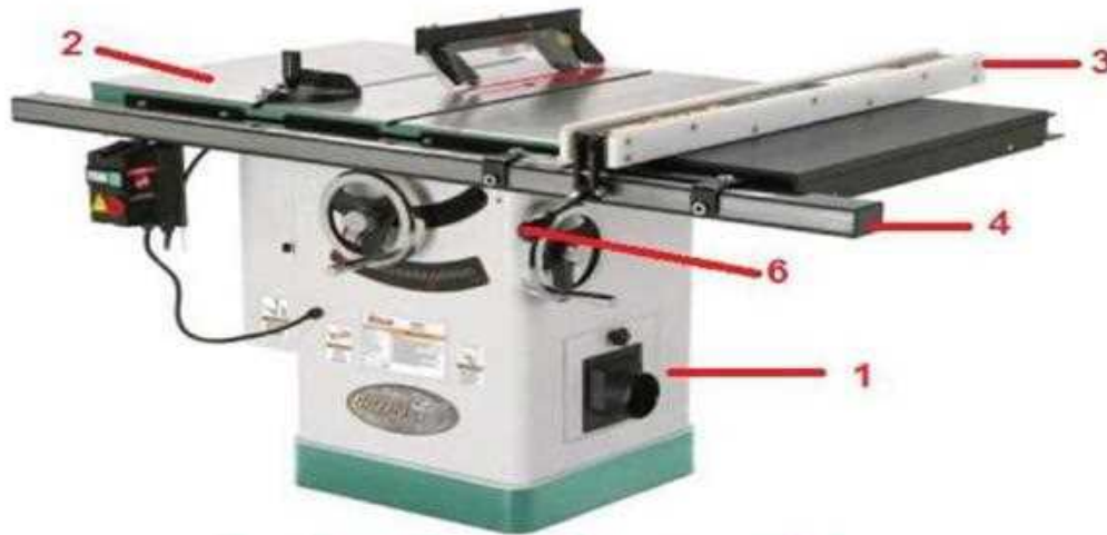
شكل (1- 21) يبين أجزاء ماكينة منشار الصينية
