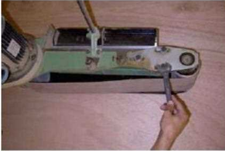
شكل (1 - 83) يوضح عملية فك براغي شد السير
