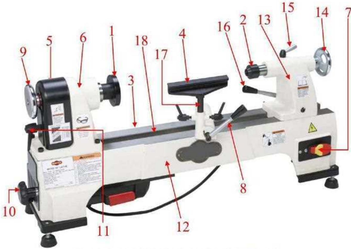
شكل (1 - 97) يوضح أجزاء المخرطة الناجية العادية
