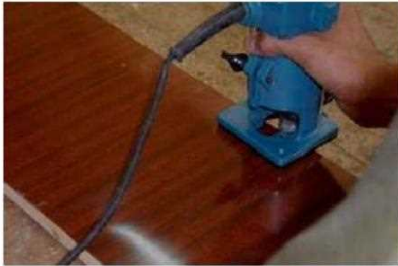
شكل (2 - 56) يوضح عملية إزالة زوائد الفورمايكا
