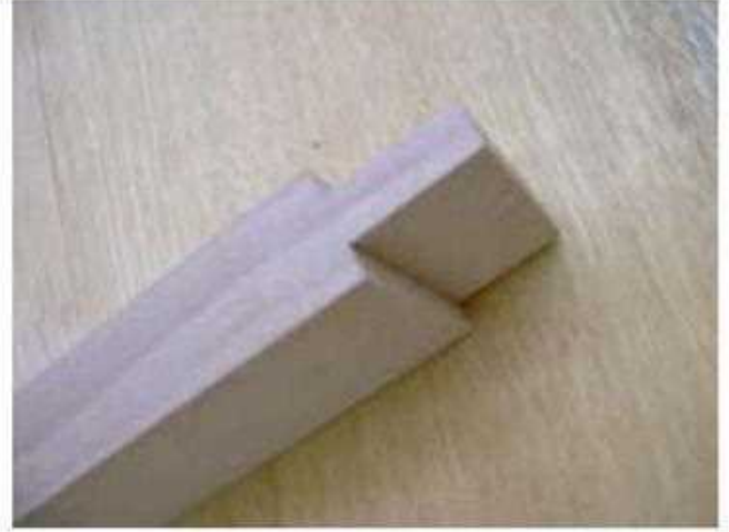
شكل (3 - 85) يوضح عملية استخراج الألسن
