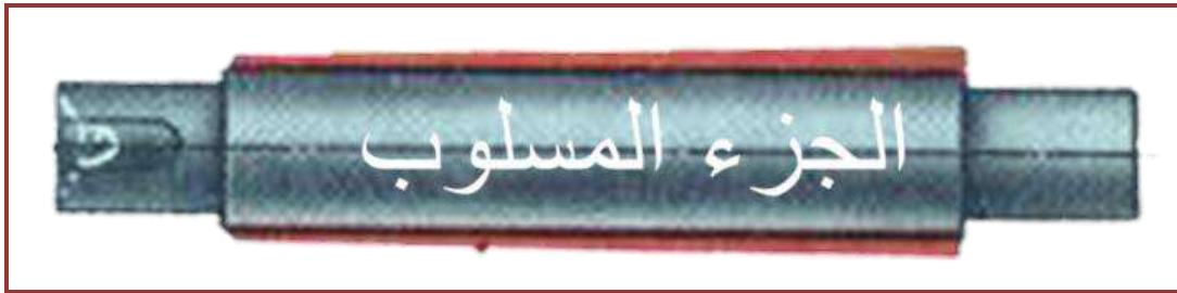
الشكل (2-41) العمود المستعمل لتثبيت المشغولات.
