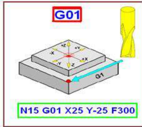
الشكل (3-11) كيفية الانتقال بحركة قطع خطية باستعمال الدالة G01.
