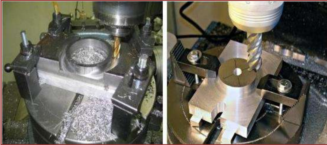
الشكل (28-2) طريقة العمل باستخدام الصينية الدائرية.
