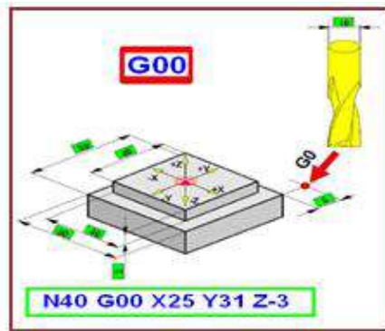
الشكل (3-10) كيفية الانتقال السريع باستعمال الدالة G00.
