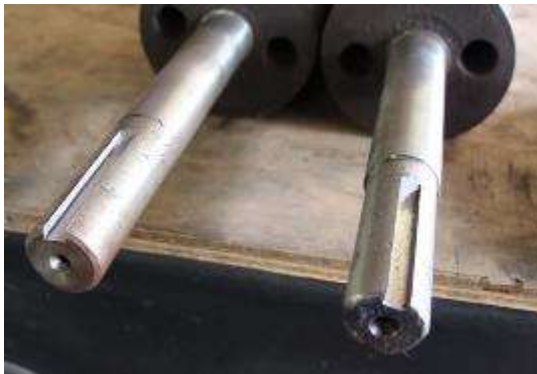
الشكل (2-21) تشغيل الأخاديد النصف مفتوحة.
