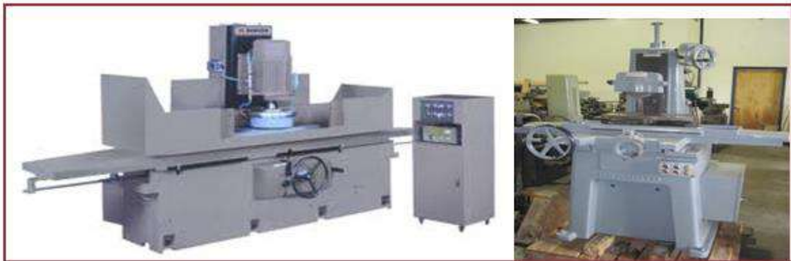
الشكل (4 - 2) ماكينات التجليخ السطحي الأفقية والعمودية.
