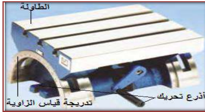
الشكل (1-46) الطاولة الزاوية القابلة للضبط .
