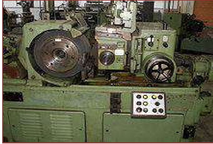
الشكل (4 - 11) ماكينة التجليخ اللامركزي
