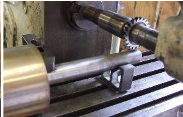
الشكل (2-21) تشغيل الأخاديد النصف مفتوحة.
