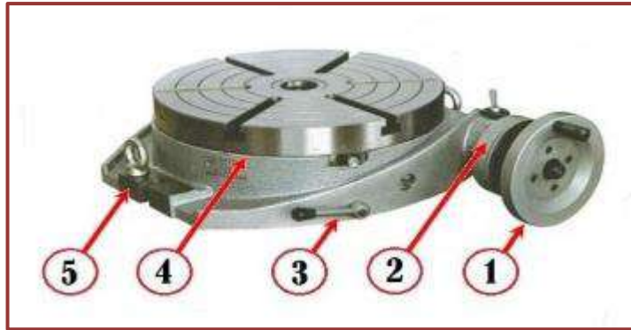
الشكل (26-2) الصينية الدوارة. 1- يدة التقسيم اليدوية 2- قرص تدريج مدرج 3- ذراع الإقفال 4- التدريج الزاوي المحيط بالدرجات 5- قاعدة الصينية
