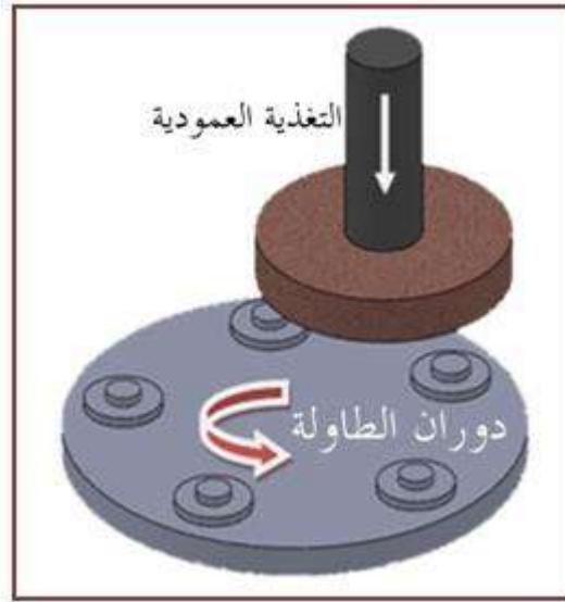
الشكل ( 4 - 20 ) التجليخ الجبهي بالطاولة الدوارة.
