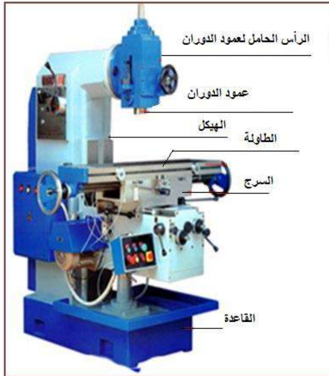
الشكل ( 7-1 ) ماكينات التفرير الرأسية.
