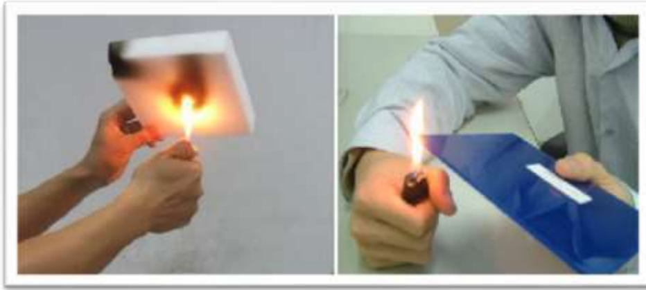
(شكل 5) ألواح عازلة مؤخرة للحرائق
