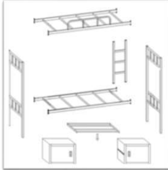
نموذج رقم (17) طريقة تركيب وتثبيت الاسره
