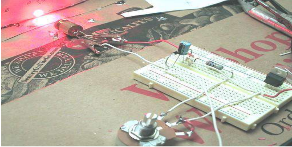
الشكل يوضح ربط المكونات الأساسية لدائرة مشغل الليزر دايود
