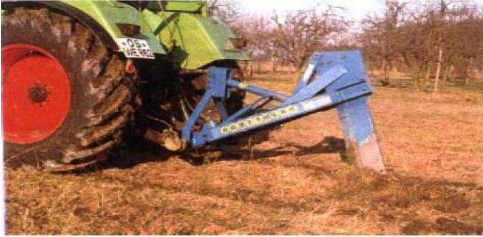
محراث حفار يستخدم لتكسير الطبقة الصماء
