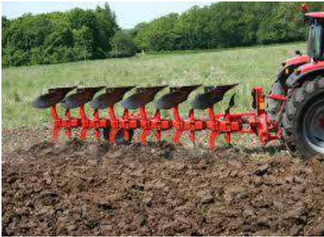
المحراث المطرحي ذو اتجاه واحد وذو اتجاهين
