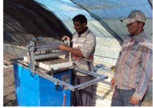
الشكل (8-11) آلة زرع بذور الخضر لإنتاج الشتلات
