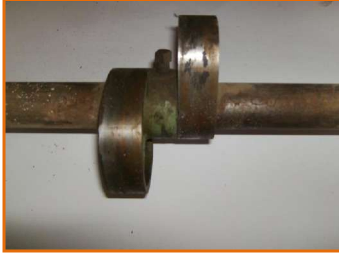
الشكل رقم ( 4-3 ) يبين الكاماة مثبتة على المحور السفلي
