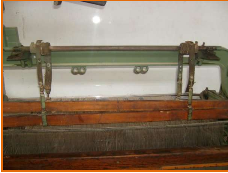
الشكل رقم ( 7-3 ) يبين طريقة ربط الدرقات
