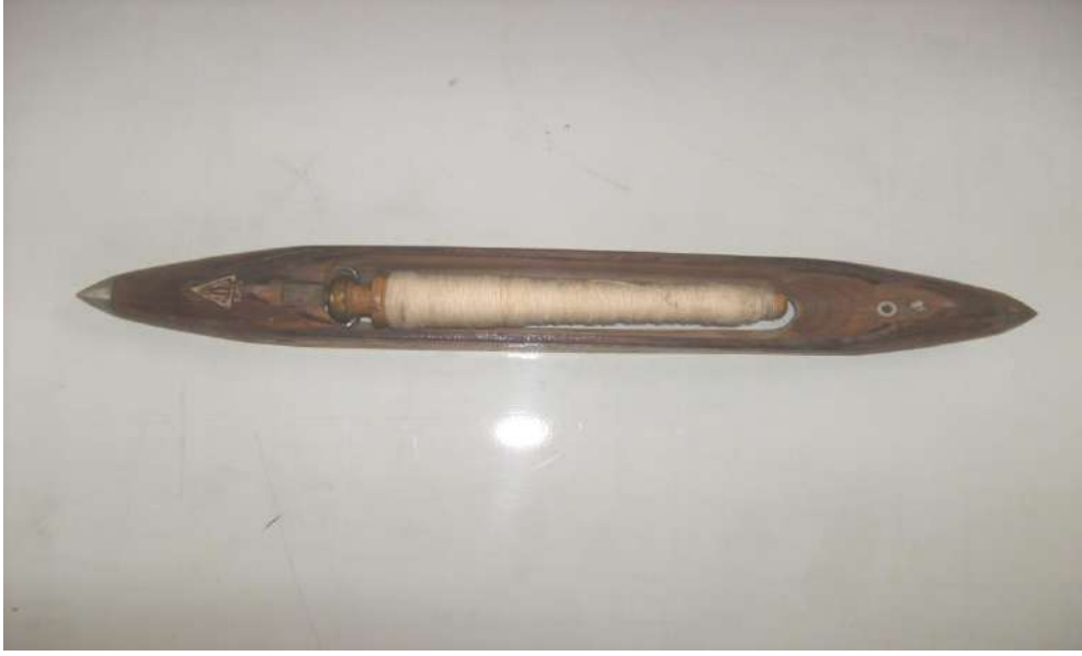
الشكل رقم ( 31-3 ) يبين بوبية اللحمة داخل المكوك
