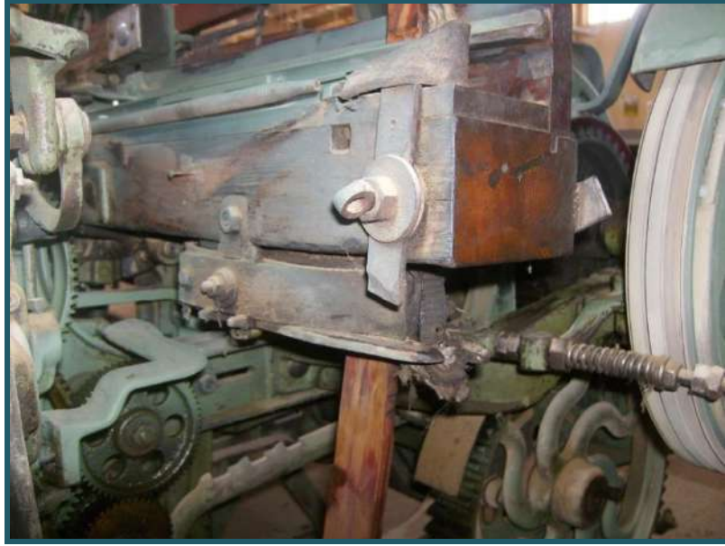
الشكل رقم ( 47-3 ) يبين عمل المصدات الآلية
