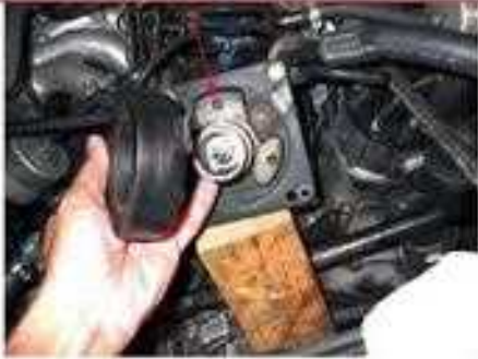
2- أرجع المغناطيس الكهربائي إلى مكانه.
