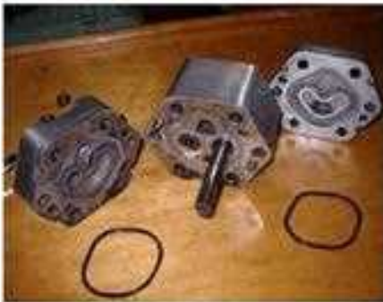
9- أجزاء المضخة ويوضح فيها حاكما التسرب
