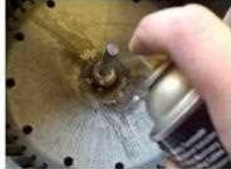
5- استعمل مذيباً كيميائياً لتنظيف المحور
