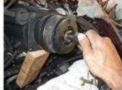
10- أستمّر في شد التولب الرئيس حتى يرجع قابض نقل الحركة إلى مكانه
