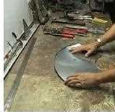
21- القوس بعد تشكيل وصلتي الربط
