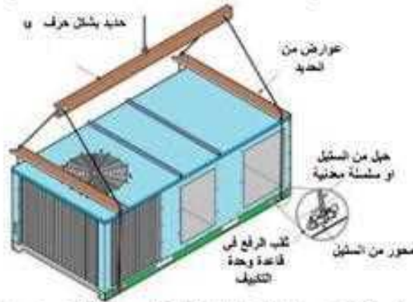
5- طريقة تثبيت السلك أو السلسلة المعدنية لأغراض الرفع
