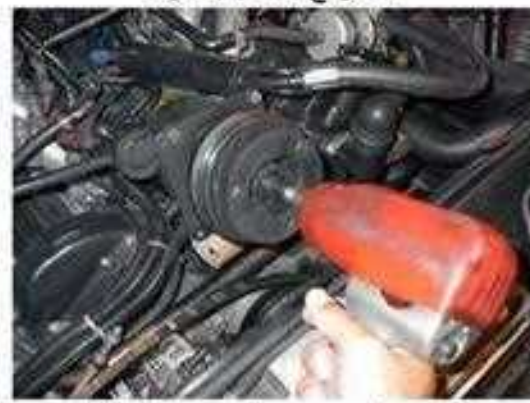
3- استعمل مسدس الهواء لفتح اللولب
