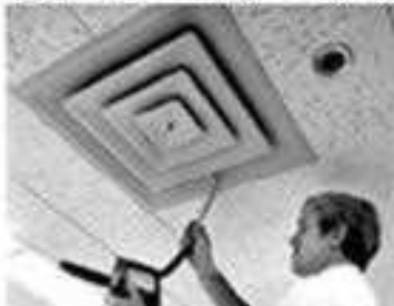
6- استعمال عصي تُربط بملحق قياس السرعة
