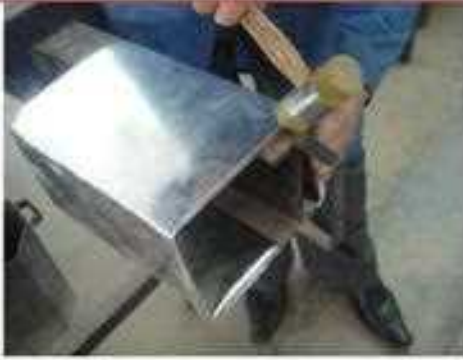
19- الطرق على محيط مجرى الهواء لتشكيل وصلة الربط مع مجرى الهواء الآخر
