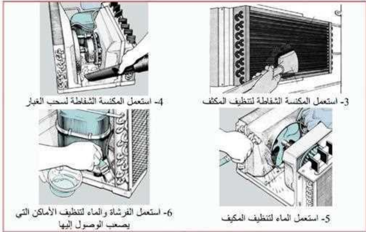
شكل 2-9 تنظيف مكيف هواء جداري
