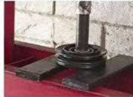
5- أبعد قطعتي المعدن بحيث تكون المسافة بينهما أكبر من قطر كرسي التحميل
