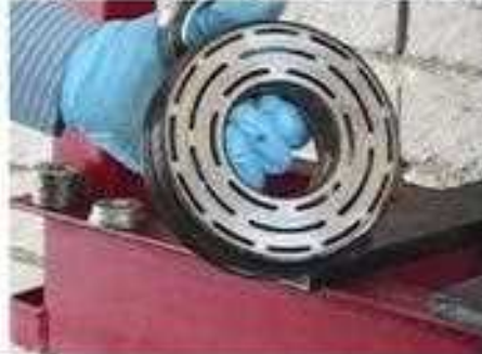
6- بكرة نقل الحركة بعد إخراج كرسي التحميل ذو الكرات من مكانه.
