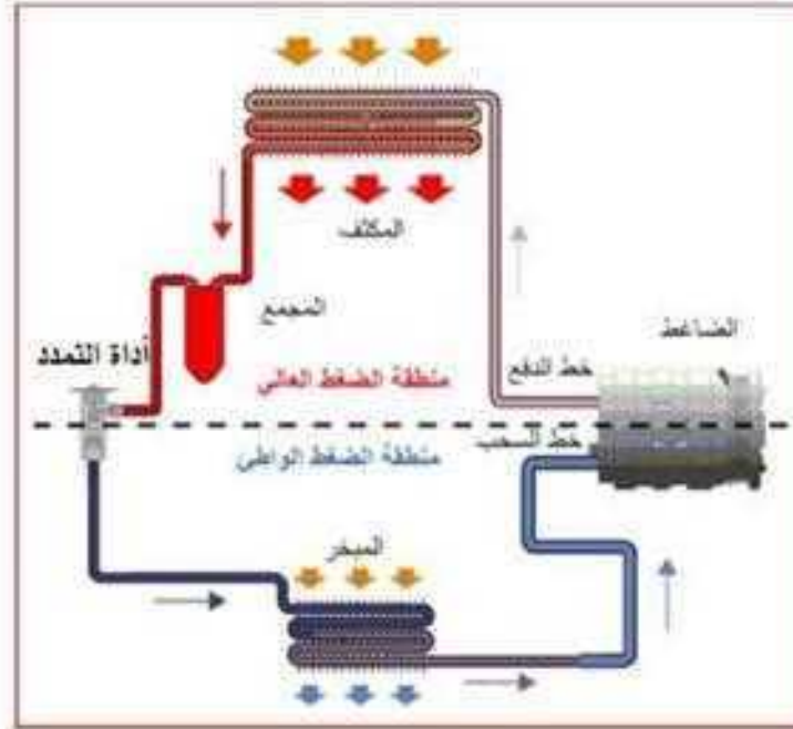
شكل 3-1 دورة التثليج القياسية ومنطقتا جانبي الضغطين العالي والمنخفض
