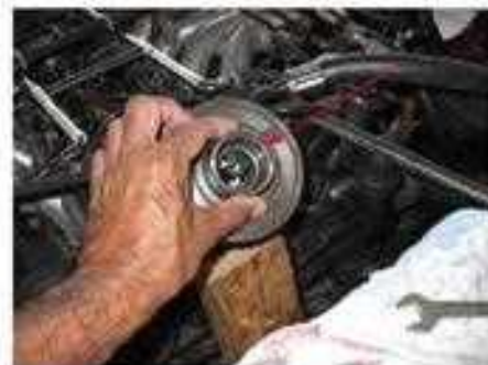
5- استعمل حلقة معدنية يناسب قطرها قطر حامل المحور ومؤشر عليها باللون الأحمر.
