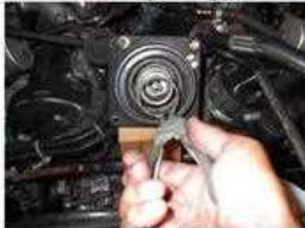
3- أرجع الحلقة المعدنية التي تحكم المغناطيس الكهربائي في مكانها.
