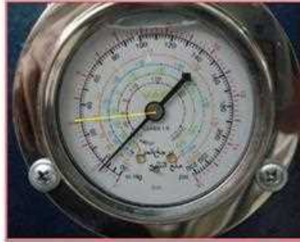
شكل 1-4 مقياس ضغط موضح عليه درجة حرارة تشبع مائع التثليج المناظرة للضغط
