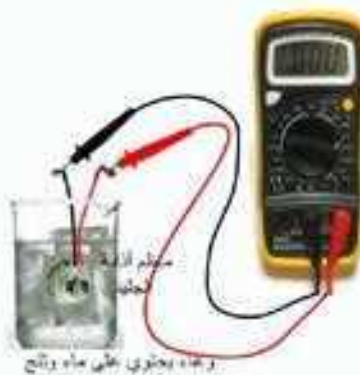
2- قياس أداء منظم إذابة الجليد في وعاء يحتوي على ماء وتليج
