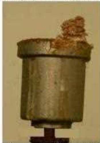
4- تجمع الأملاح والتكلسات على طاردة الهواء
