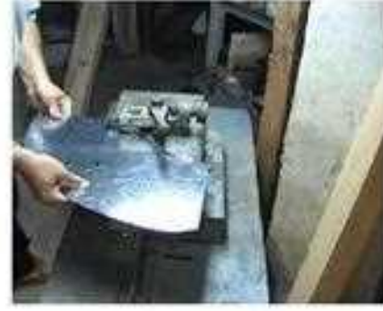
19- تشكيل الطرف الداخلي لوصلة الربط
