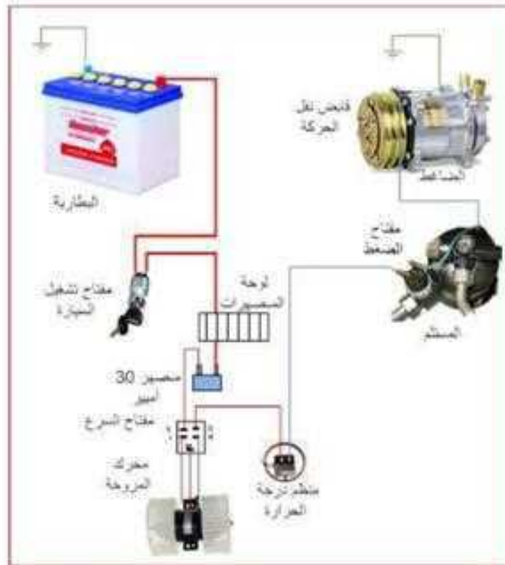
شكل 6-8 الدائرة الكهربائية لمكيف السيارة
