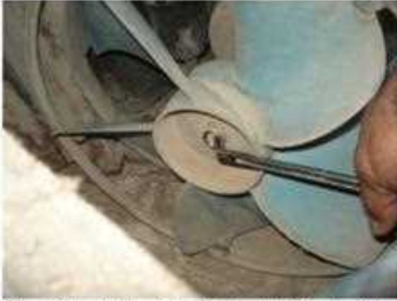
6- استعمل مفك الصامولات لفتح اللولب الذي يثبت مروحة المكثف بمحور دوران المحرك
