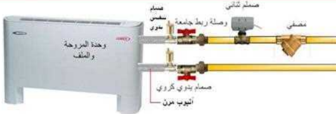
4- ربط وحدة المروحة والملف بشبكة أنابيب المياه بصمام ثنائي
