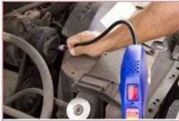
شكل 8-9 فحص منظومة نقل الحركة لأغراض كشف التسرب
