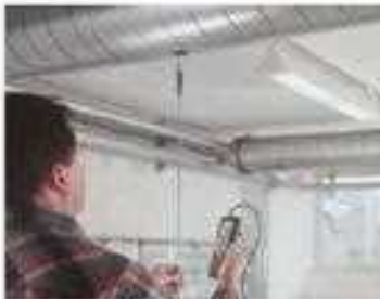
4- قياس سرعة الهواء خلال مجرى الهواء
