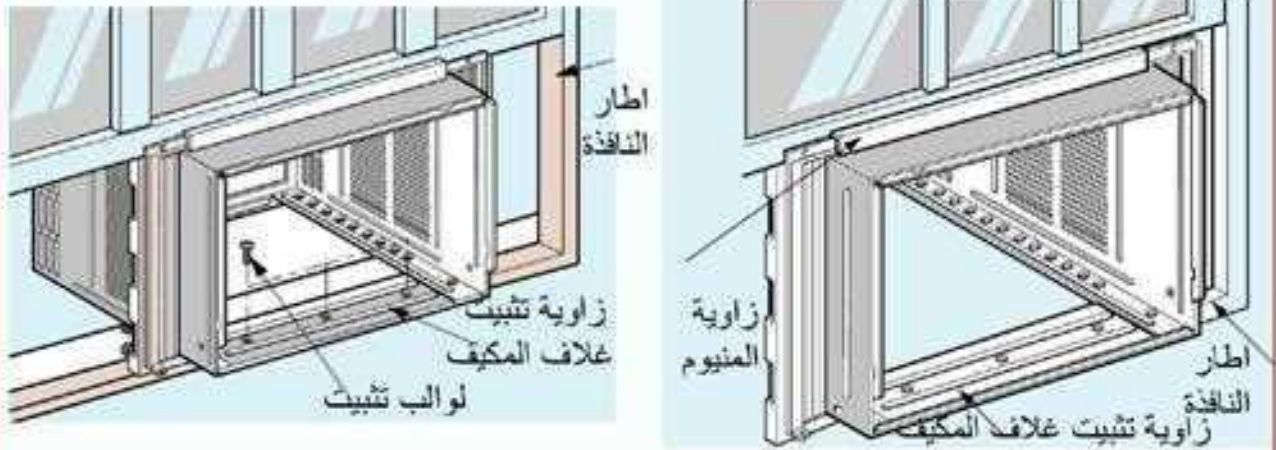
6- الشكل النهائي لإطار المكيف خلال النافذة 7- ثبت غلاف المكيف بالنافذة بواسطة اللواكب
