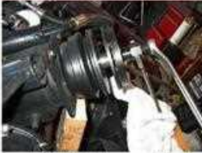
11- استعمل مفتاحي صامولات لإحكام ربط التولب في مكانه
