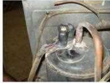
3- رفع الغطاء المعدني ولاحظ وضع غطاء لدائني لحماية مناطق الربط
