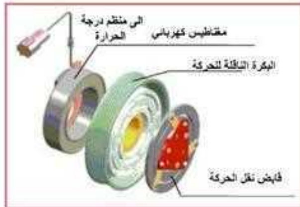
شكل 2-8 منظومة نقل الحركة في مكيف السيارة
