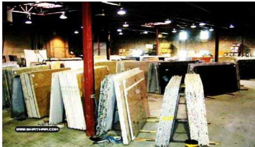
الشكل (2-7) يوضح اشكال الكرانيت بعد الصقل وقبل التقطيع
