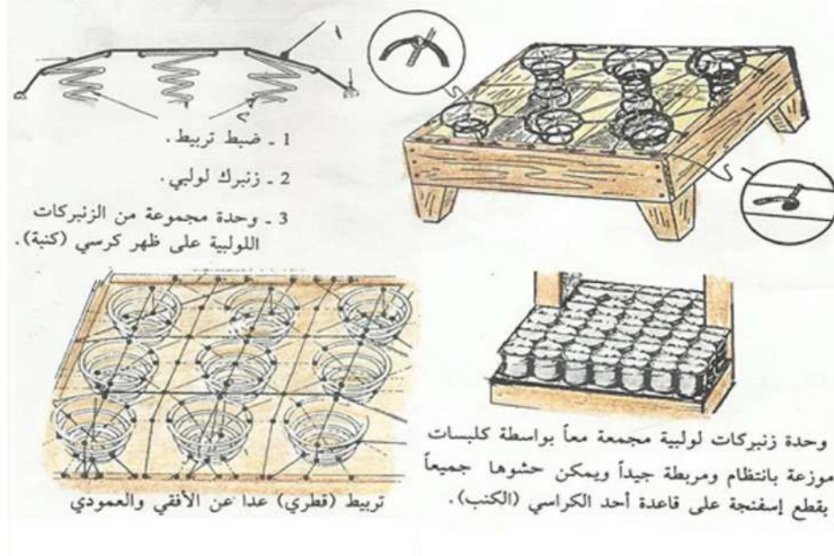
شكل (4-49) كيفية تركيب النوابض
