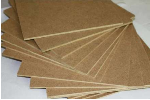
الشكل (5-7) يوضح ألواح خشب MDF
