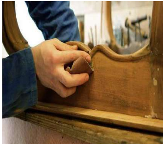
شكل (23-3) يوضح عملية التنعيم والانتهاء السطحي لأثاث من مادة الخشب
