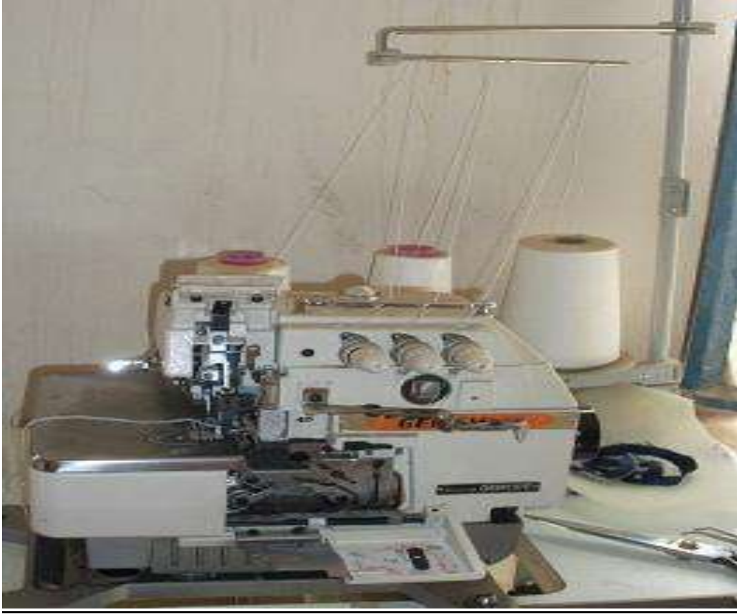
احد نماذج المكنائن التي تستخدم لعمل الأوفر فقط
