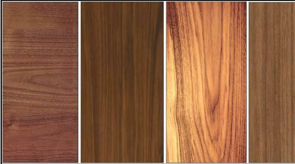
شكل رقم (3-17) يوضح مقاطع متنوعة لخشب الجوز
