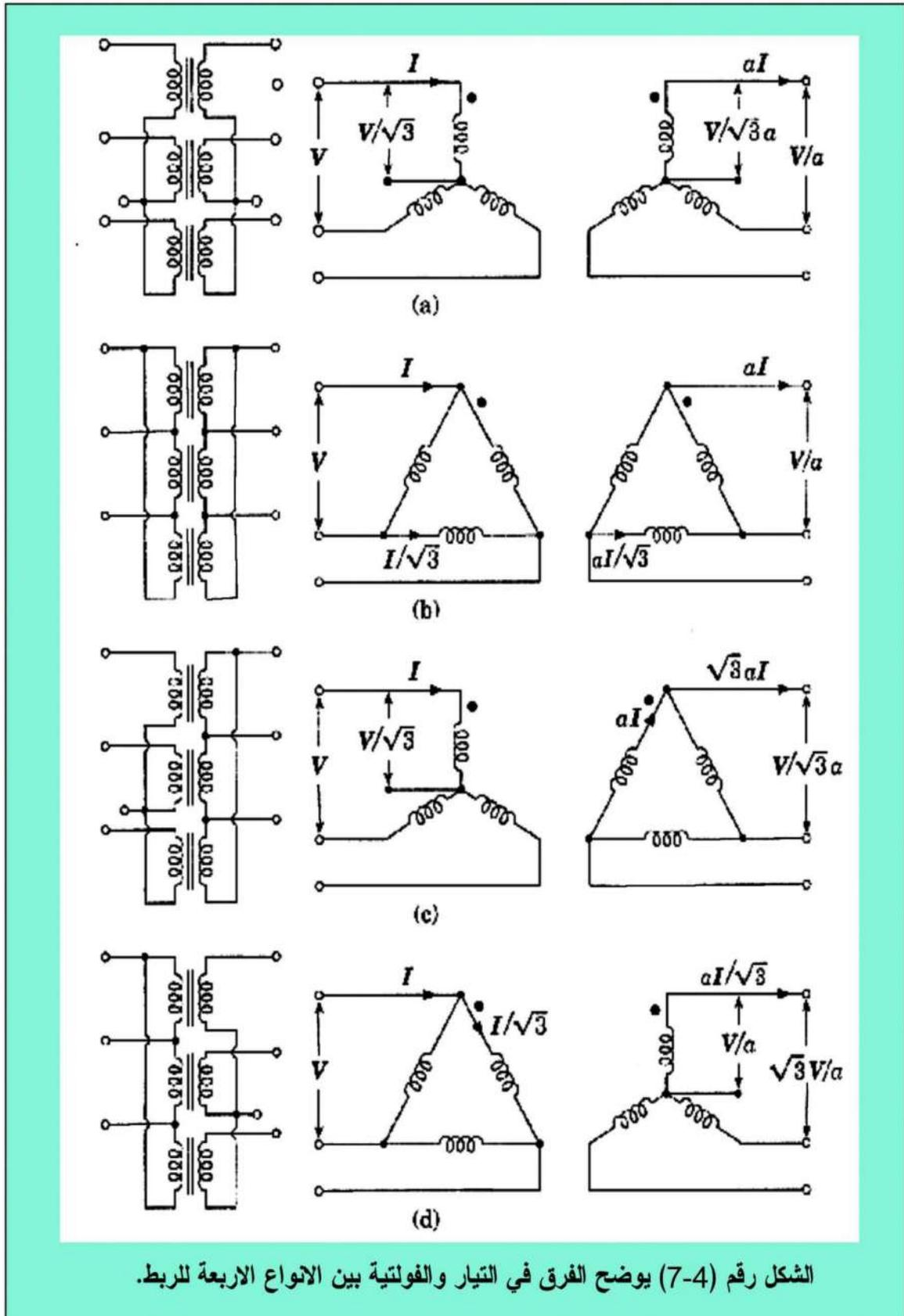
الشكل رقم (7-4) يوضح الفرق في التيار والفولتية بين الانواع الاربعة للربط.
