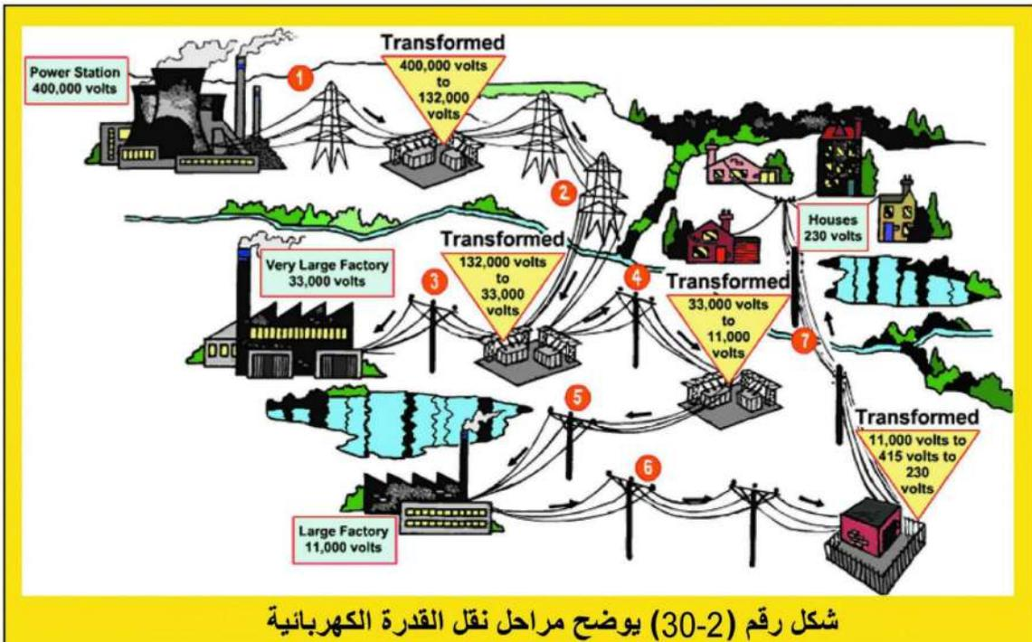
شكل رقم (2-30) يوضح مراحل نقل القدرة الكهربائية
