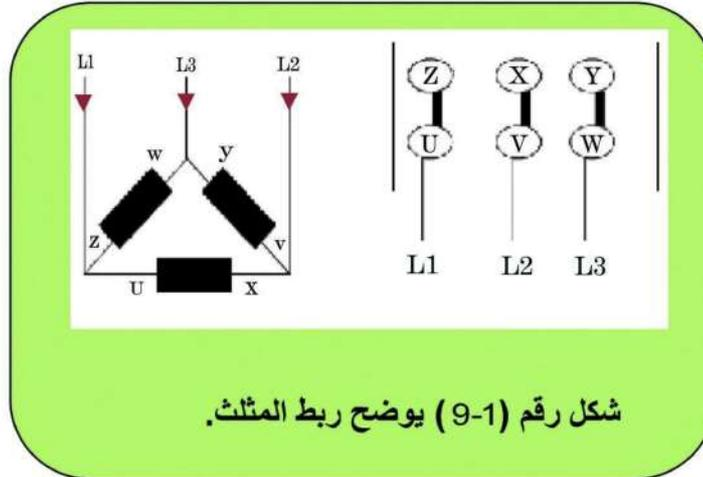
نلاحظ انه ليست هناك ضرورة لاستعمال سلك محايد، ولذلك فهذا النظام يكون دائما بثلاثة أسلاك كما موضح في الشكل أعلاه. وفي هذه التوصيلة لا يوجد فرق بين الجهد الخطي ( $V_L$ ) والجهد الطوري ( $V_{ph}$ )، بينما يكون الفرق بين تيار الطور وتيار الخط بمقدار ( $\sqrt{3}$ ). في الشكل رقم (10-1) يوضح التوصيلتين النجمة والمثلث ويوضح كذلك إتجاه التيار في كل طور. والذي يكون إتجاه التيارات الثلاثة مع اتجاه عقرب الساعة.
