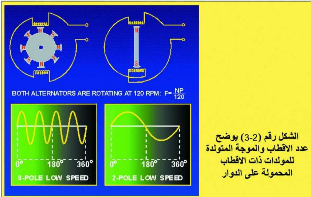
يتضح من العلاقة (2-2) أهمية كبرى في إنتشار المولدات التوافقية لإنتاج الطاقة الكهربائية حيث يمكن تحديد التردد بقيمة ثابتة وفقاً للمواصفات القياسية مثل (50) ذ/ثا كما في العراق أو (60) ذ/ثا في بعض البلدان الأخرى.
