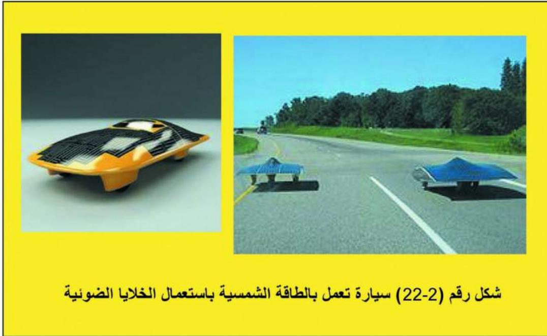
شكل رقم (22-2) سيارة تعمل بالطاقة الشمسية باستعمال الخلايا الضوئية
