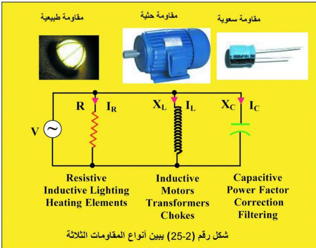
والأحمال ذات المقاومة الحثية (XL) يكون لها تأثير في حالة التيار المتناوب التي تؤدي الى حدوث زاوية فرق متأخرة بالنسبة للتيار عن الجهد وسيؤثر هذا تأثيرا سلبيا في القدرة الظاهرة (المتولدة في محطة التوليد)، بالتقليل من قيمتها عند وصولها الى المستهلك وتعدّ قدرة ضائعة بسبب انخفاض معامل القدرة. كما موضح في الشكل رقم(2-26).
