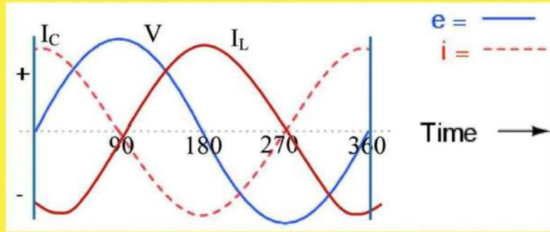
شكل (26-2) يبين موجة التيار (IL) متأخرة عن الجهد V بينما موجة التيار (IC) متقدمة على الجهد
