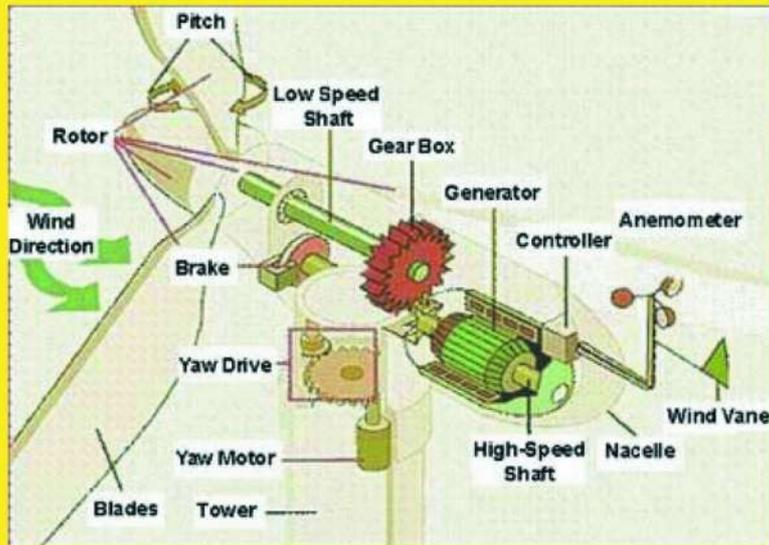
الشكل رقم (20-2) التركيب الداخلي للمراوح
