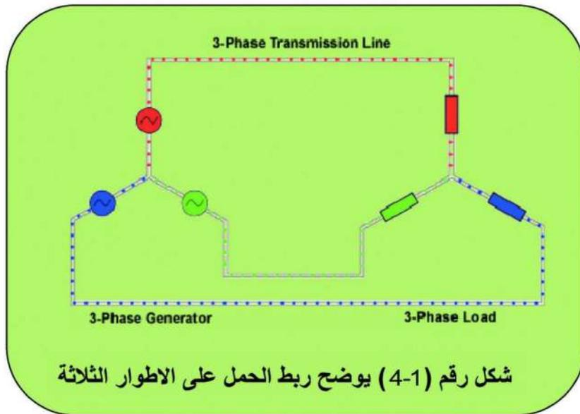
ويُعدّ محرك الثلاثة أطوار ذو التوصيل النجمي من الأمثلة الواضحة على هذا النوع أما في حالة الأحمال غير المتوازنة ، شكل رقم (5-1) ، فيجب استخدام سلك الحياد وبمساحة مقطع يتحمل فرق التيار الناشيء عن عدم الإيزان، وتسمى الأسلاك التي توصل ملفات المولد بالشبكة والى المستهلك (بأسلاك الخط  $V_L$ ) هو الجهد الخطي والذي هو فرق الجهد بين أي خطين من الخطوط الثلاثة، ويسمى الجهد الموجود بين أي طور من الأطوار الثلاثة مع المحايد بجهد الطور ( $V_{ph}$ ).
