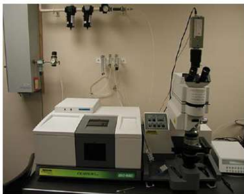
شكل 5-1 جهاز طيف الاشعة تحت الحمراء (IR)
