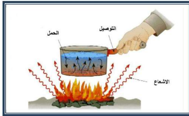
شكل 7-7 الانواع الثلاثة لانتقال الحرارة.
