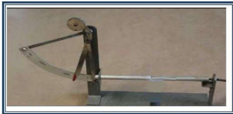
شكل 6-7 تجربة حساب الاجهاد الحراري لقضيب مقيد.
