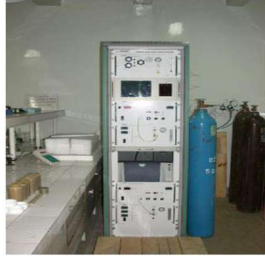
شكل 1-7 جهاز التحليل الحراري DTG لدراسة تحولات المادة بتأثير درجة الحرارة
